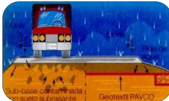
Figura 10: Función de drenaje de un geotextil.
