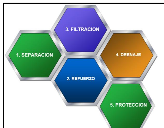
Figura 6: Propiedades de los geotextiles.
