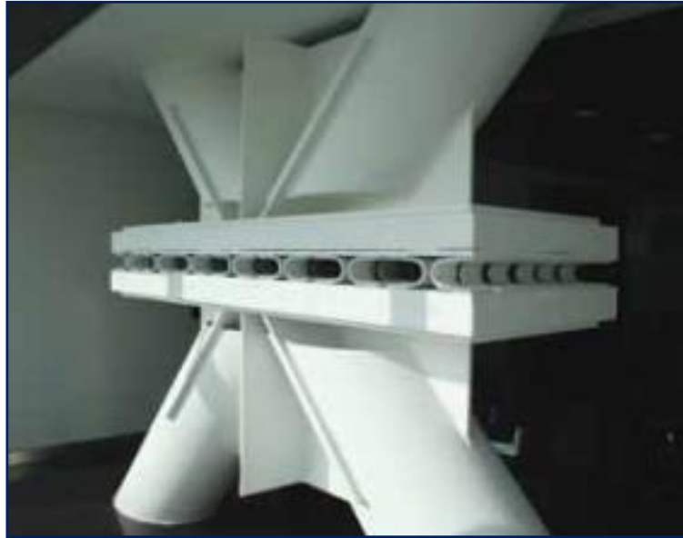
Figura 2.31: Sistema de disipador tipo friccionante Fuente: Documento Técnico N° 29 -Cámara Chilena de la Construcción,2011
