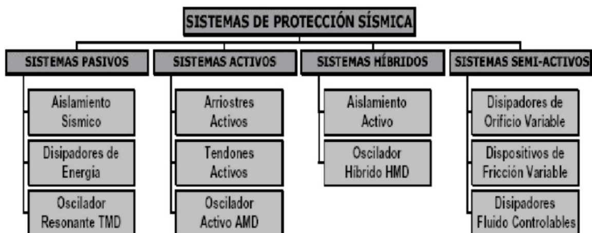
Figura 2.3: Sistemas de Protección Sísmica Fuente: Zevallos ,2002
