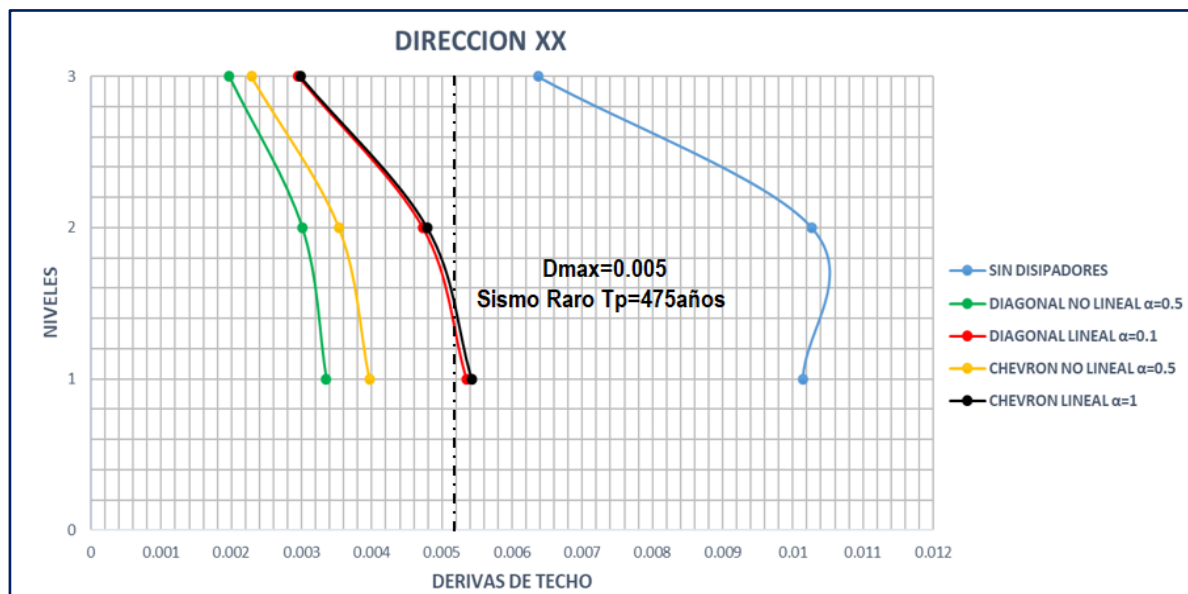
Figura 4.21 Distorsiones inelásticas en la Edificación con y sin Disipadores para cada tipo de Disposición, comportamiento Lineal y no Lineal - Dirección XX
