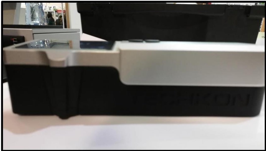
USO DE ESPECTOFOTOMETRO DE BARRIDO EN EL LABORATORIO ANTALYS LAB
