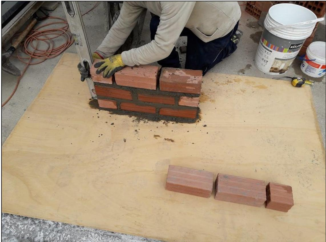
Fotografía 25. Elaboración de muretes de albañilería.
