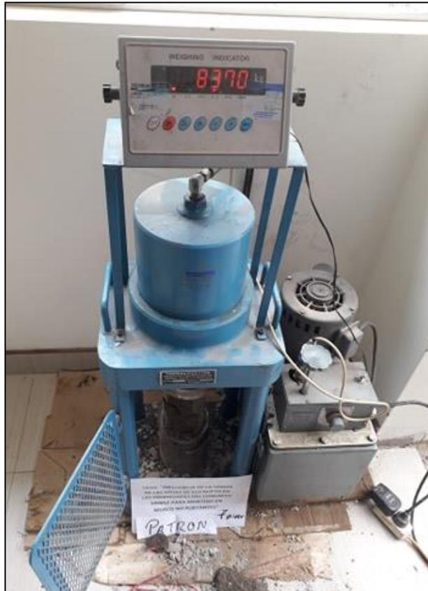
Fotografía 21. Rotura de probeta de mortero convencional a los 7 días.
