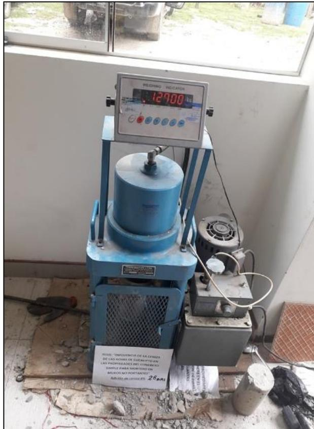
Fotografía 23. Rotura de probeta de mortero con ceniza de hoja de eucalipto a los 28 días.
