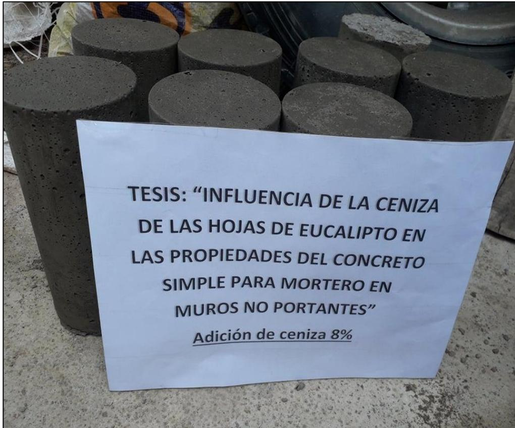
Fotografía 19. Vista de probetas de mortero con ceniza de hoja de eucalipto en 8 %.
