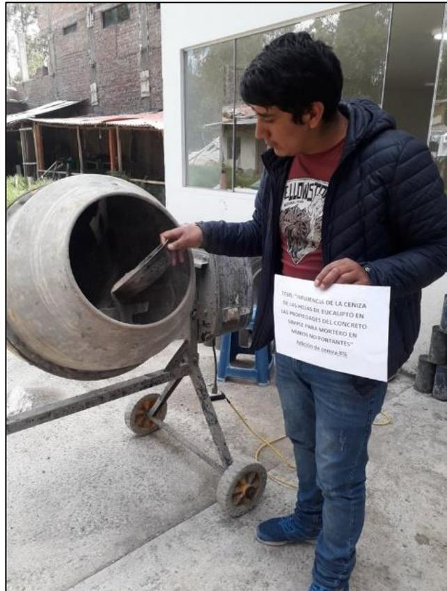
Fotografía 7. Mezclado para mortero con ceniza de hoja de eucalipto en 8%.
