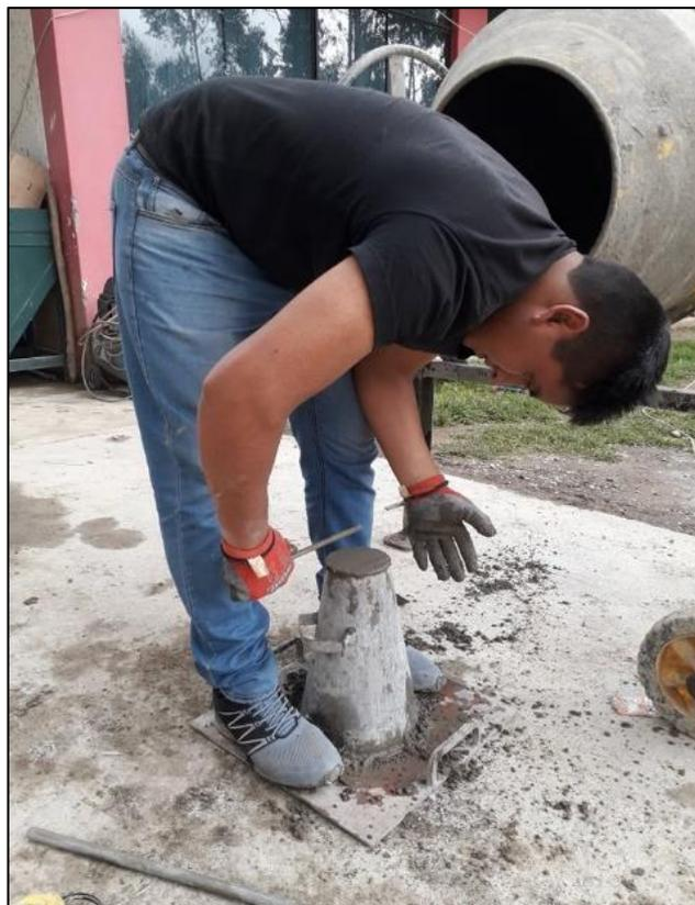
Fotografía 8. Preparación de espécimen para la medición del asentamiento.
