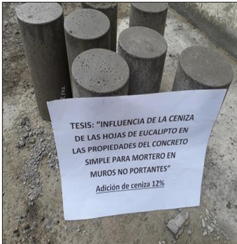
Fotografía 20. Vista de probetas de mortero con ceniza de hoja de eucalipto en 12 %.
