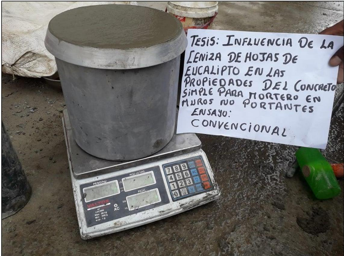
Fotografía 13. Medición del contenido de aire del mortero convencional.
