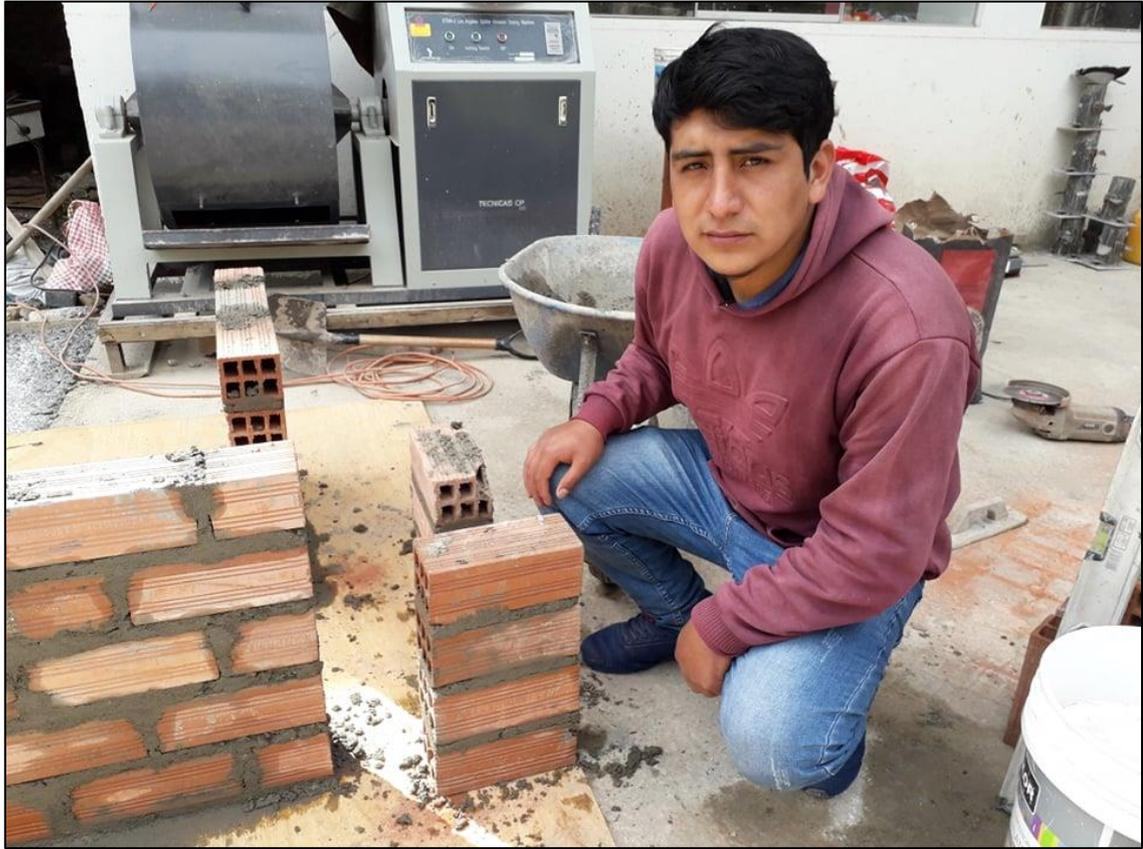
Fotografía 27. Vista de pilas y muretes con los diferentes tipos de mortero.
