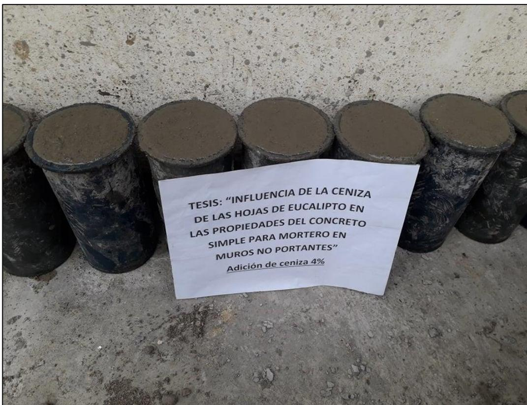
Fotografía 18. Vista de probetas de mortero con ceniza de hoja de eucalipto en 4 %.
