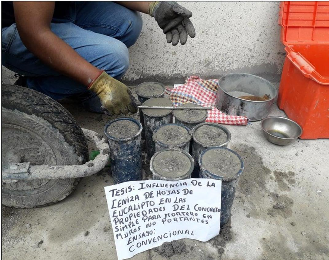
Fotografía 17. Elaboración de probetas de mortero convencional.
