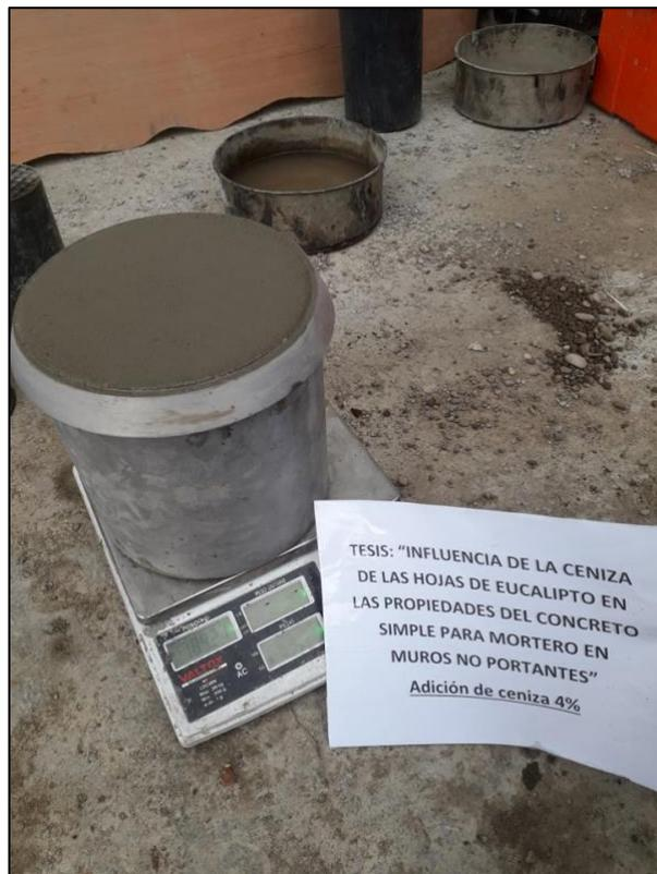
Fotografía 14. Medición del contenido de aire del mortero con ceniza de hoja de eucalipto 4 %.
