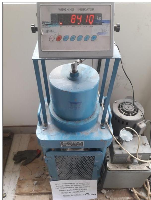
Fotografía 22. Rotura de probeta de mortero con ceniza de hoja de eucalipto a los 14 días.
