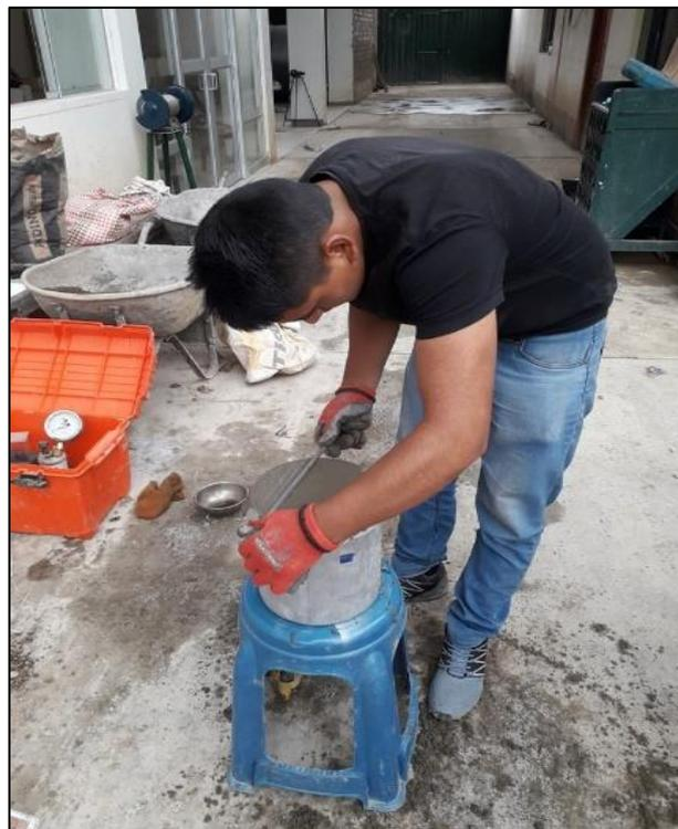
Fotografía 12. Preparación de especímenes de mortero para la medición del contenido de aire.
