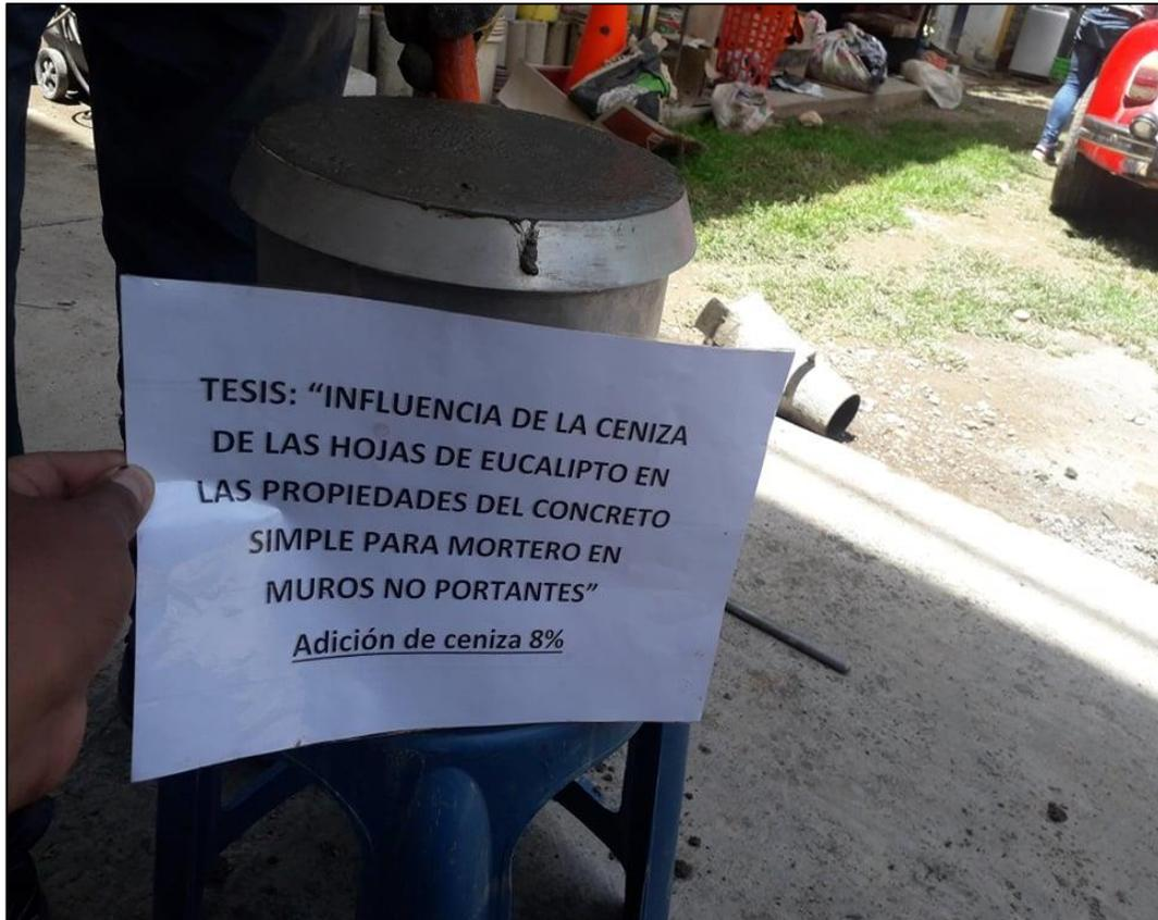
Fotograf3a 15. Medici3n del contenido de aire del mortero con ceniza de hoja de eucalipto 8 %.
