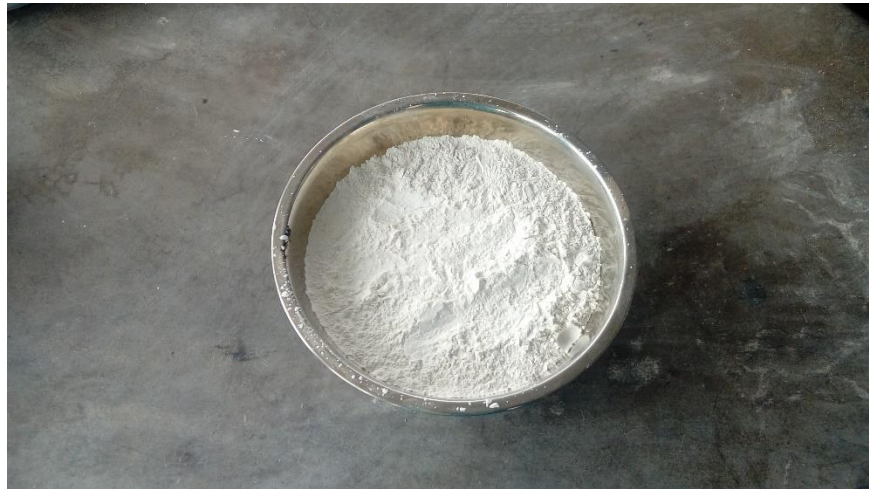
Foto 14: Muestra de Filler (cal) para el diseño Marshall
