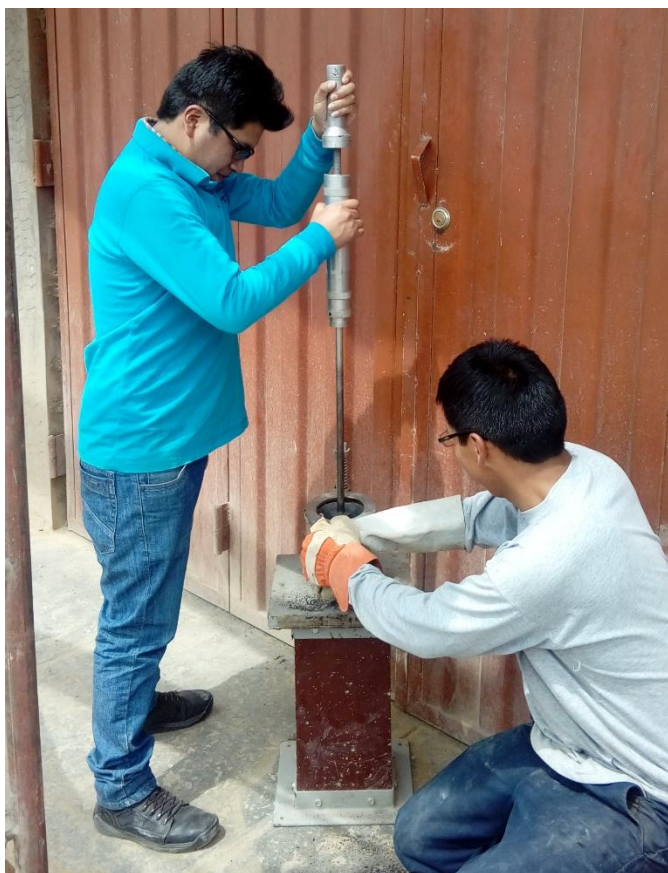
Foto 18: Compactado de la mezcla asfáltica
