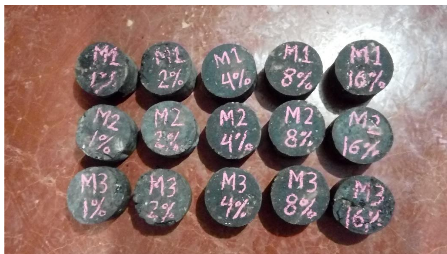
Foto 35: Briquetas con el aditivo (PET) con código y porcentaje
