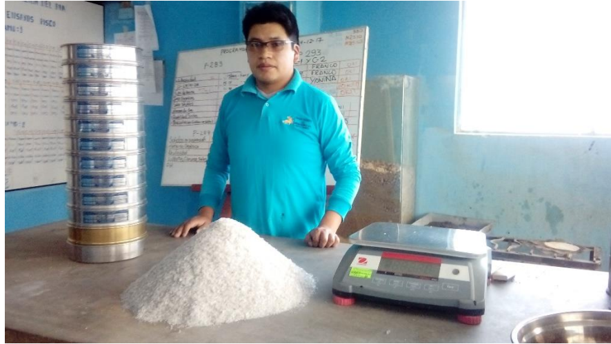
Foto 32: PET triturado listo para reemplazar al Agregado fino
