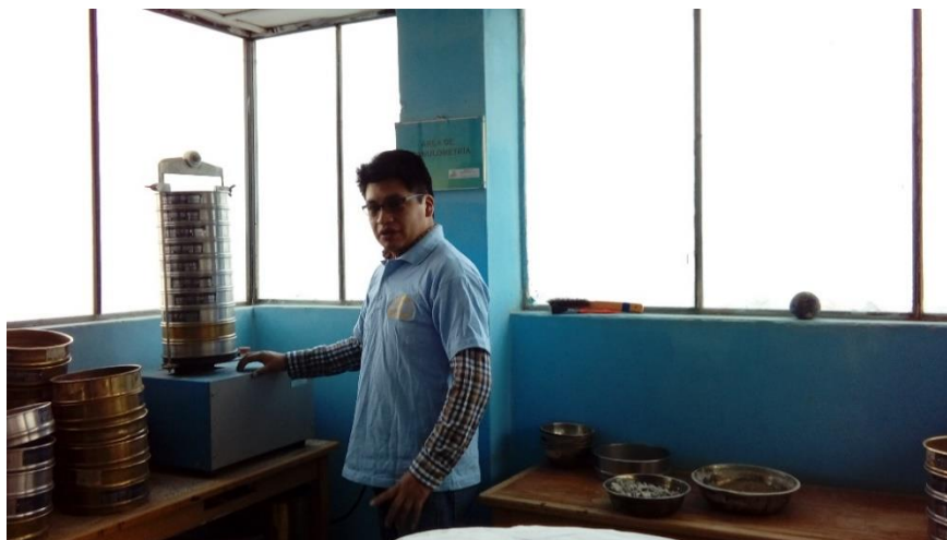
Foto 8: Tamizando los agregados en laboratorio
