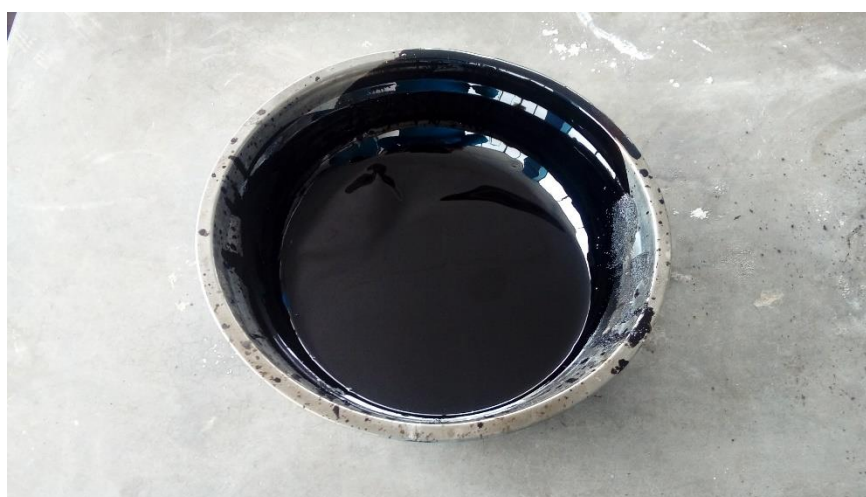
Foto 13: Muestra del cemento asfáltico 85-100 para el diseño Marshall
