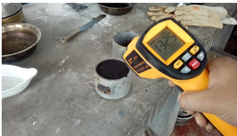
Foto 19: Control de temperatura de la briqueta
