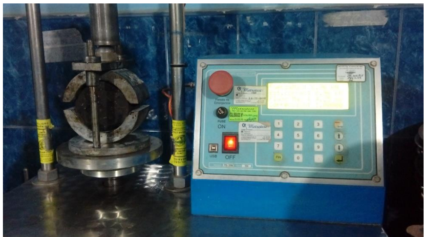
Foto 26: Briqueta en el equipo Marshall
