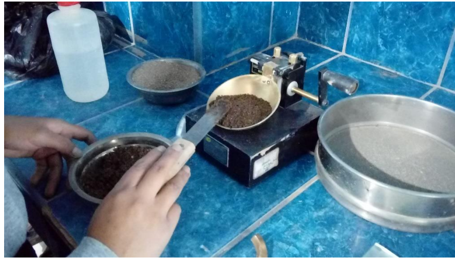
Foto 7: Muestra de agregado fino para obtener los límites
