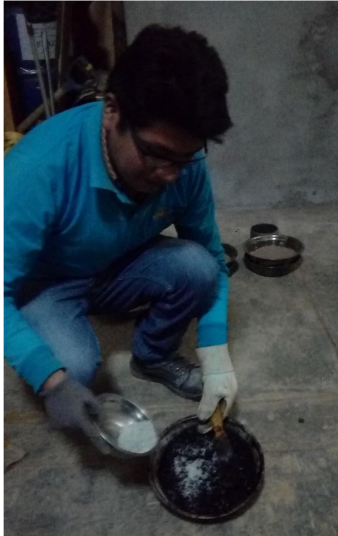
Foto 34: Aditivo (PET) añadido en la mezcla asfáltica
