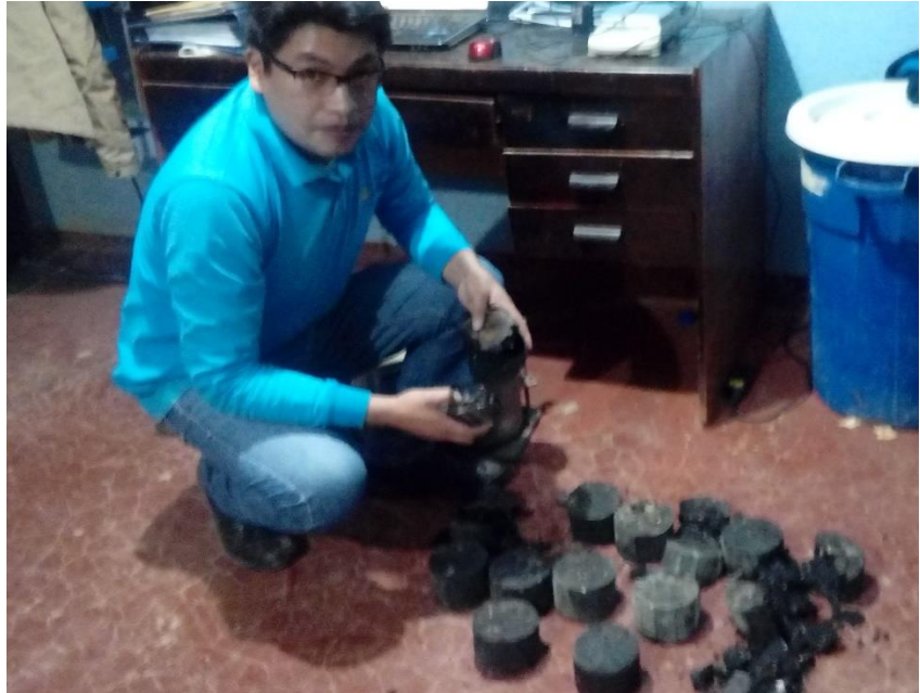
Foto 29: Briquetas después del cálculo de la estabilidad y la fluencia o flujo en el equipo Marshall
