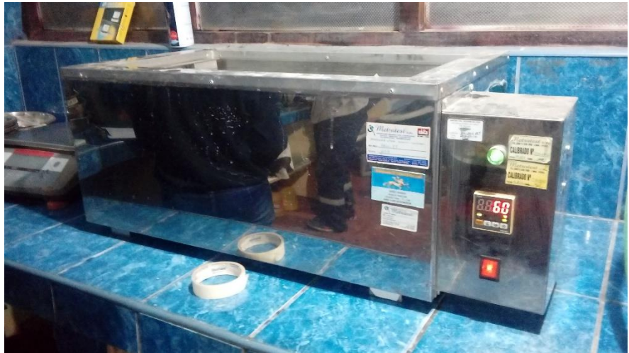
Foto 25: Equipo baño maría a 60^\circ\text{C} con las briquetas
