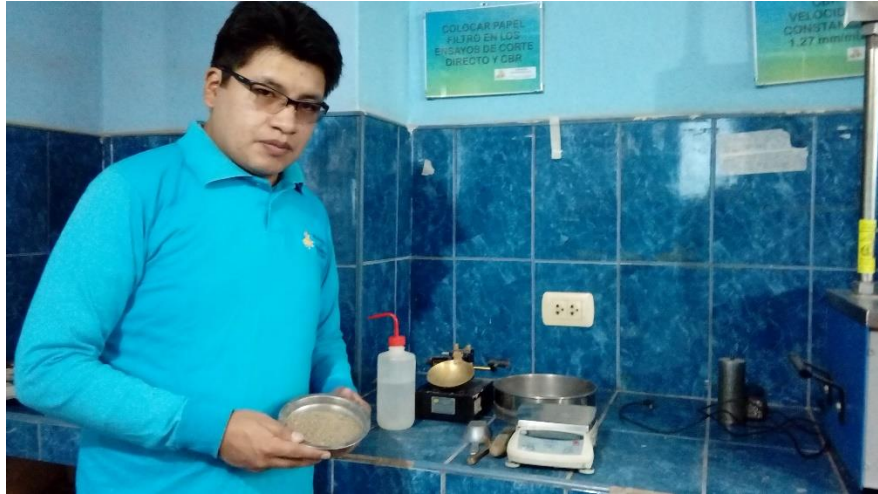
Foto 4: Agregado Fino para el cálculo de equivalente de arena
