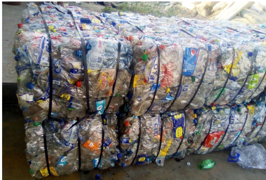
Foto 31: PET en bloques para el triturado en lentejuelas
