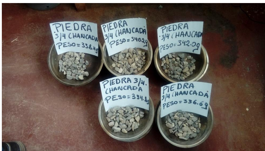
Foto 11: Agregado grueso con pesos para el diseño Marshall
