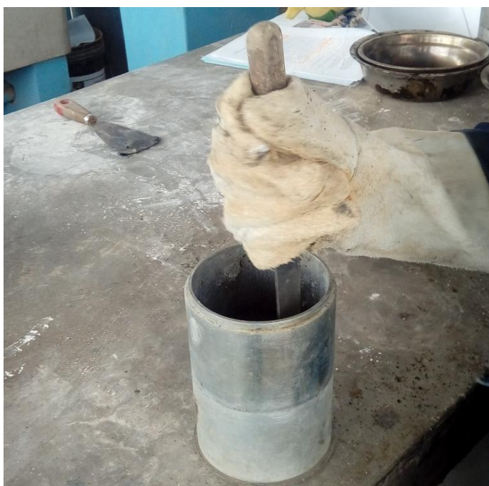
Foto 17: Mezcla asfáltica en molde
