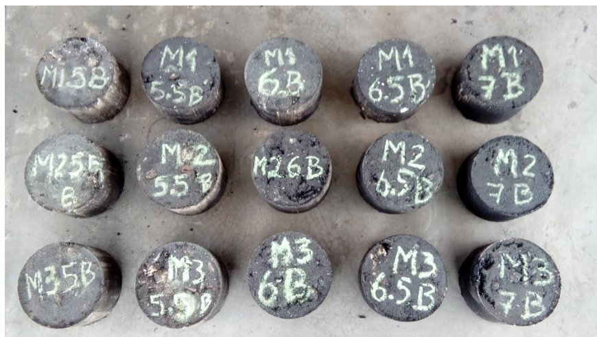
Foto 23: Las briquetas con código para el Diseño Marshall
