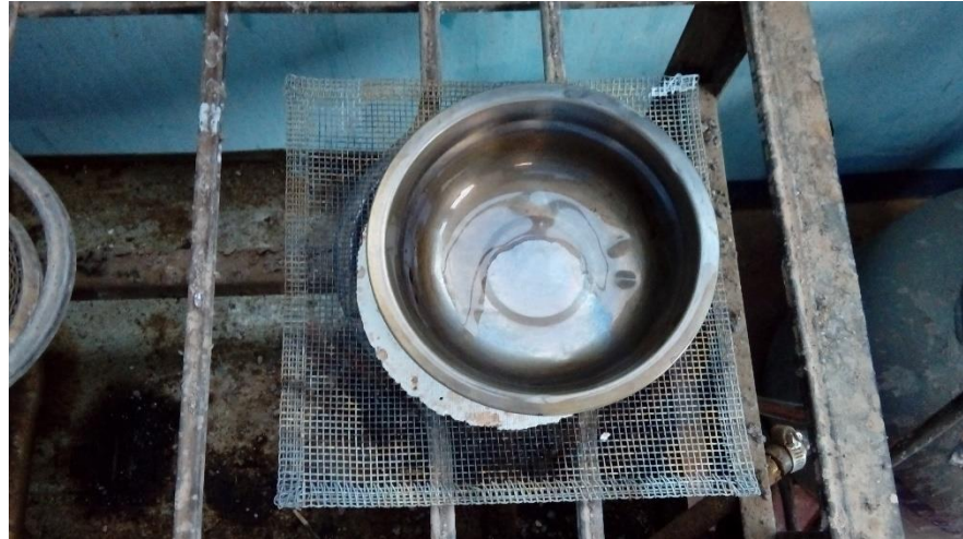
Foto 3: Verificación de la cantidad de sales de los agregados
