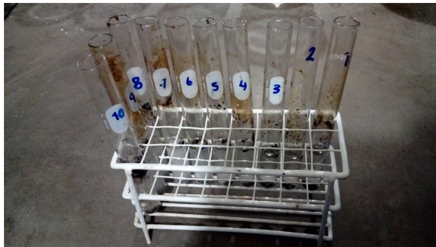
Foto 10: Tubos de vidrio para el ensayo con las esferas con mezcla de asfalto y agregado fino
