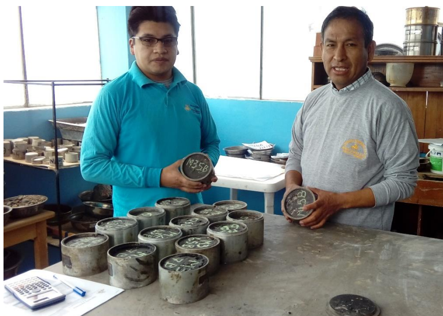
Foto 21: Las briquetas en los moldes y el Ingeniero responsable del Diseño Marshall en el laboratorio
