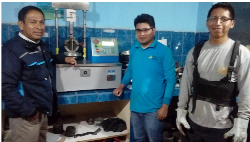
Foto 28: Última briqueta en el equipo Marshall
