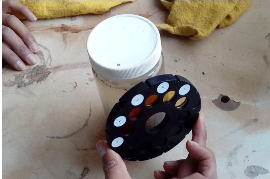
Foto 2: Prueba colorimétrica de la arena
