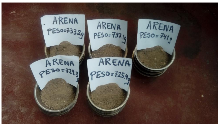
Foto 12: Agregado fino con pesos para el diseño Marshall
