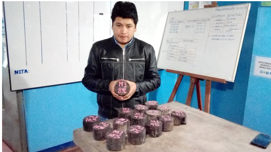
Foto 36: Briqueta después del cálculo de la estabilidad y la fluencia o flujo en el equipo Marshall
