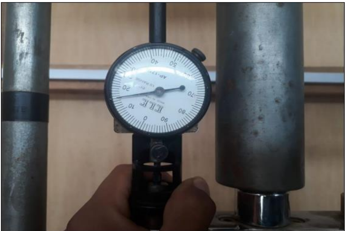
Figura N° 06: Es el ensayo de estabilidad /flujo desplazamiento y deformación del espécimen
