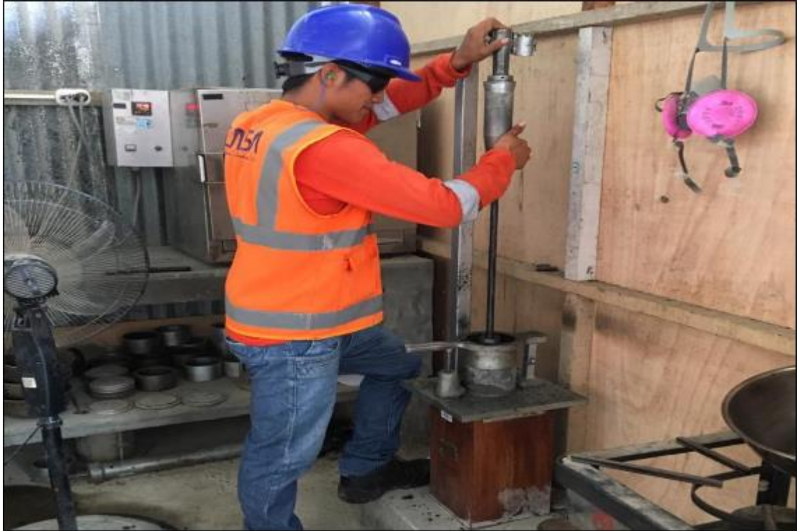
Figura N° 01: Diseño de asfalto método Marshall compactación variable para hallar el óptimo contenido de asfalto
