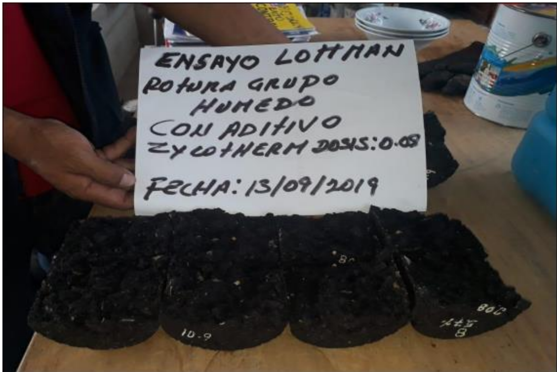
Figura N° 03: Ensayo Lottman con adherencia de aditivo.
