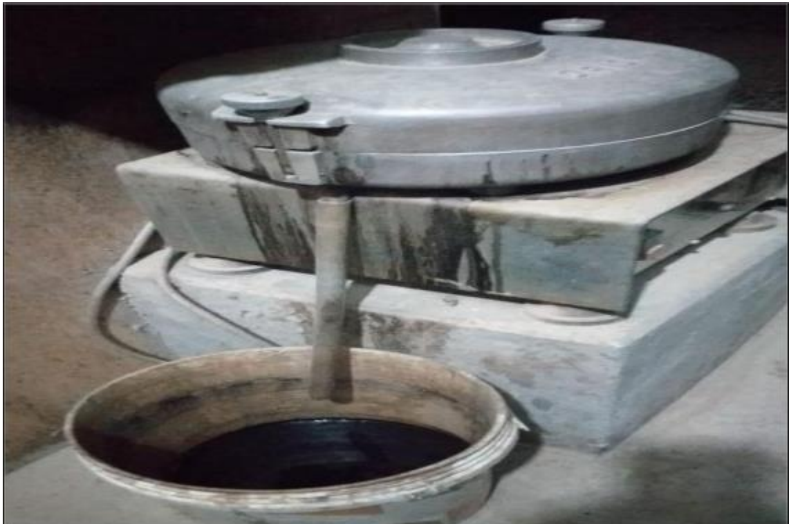
Figura N° 04: Ensayo de lavado asfáltico por método de centrifugación
