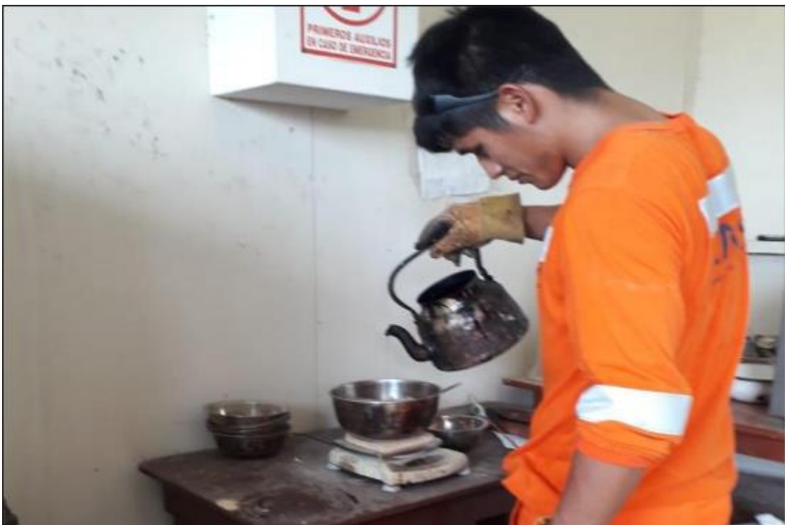
Figura N° 24: Asfalto en el agregado para la mezcla.
