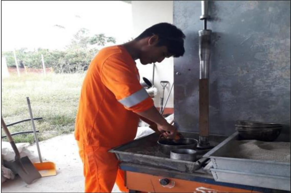
Figura N° 07: Eso es la mezcla del agregado con el asfalto para tener uniformidad y de igual manera ver la adherencia
