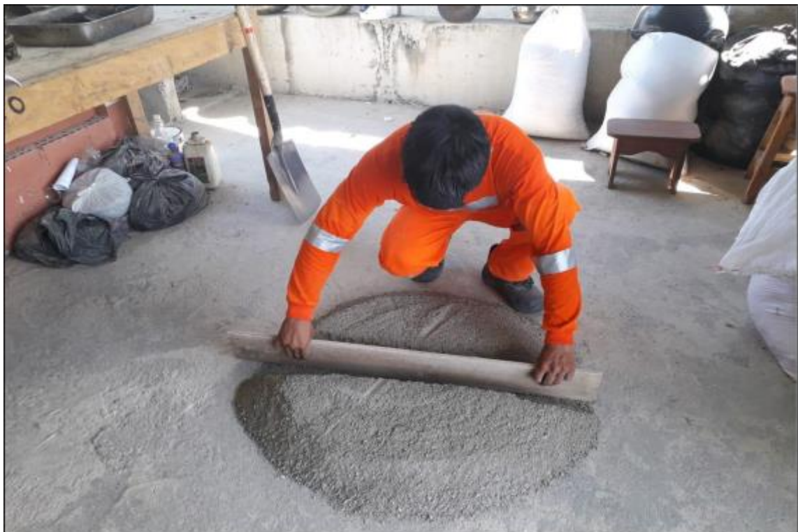
Figura N° 08: Cuarteo de material para hacer el ensayo de análisis granulométrico
