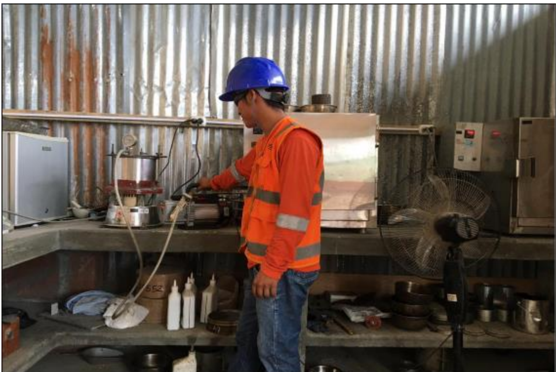
Figura N° 02: Ensayo de rice para hallar el peso específico máximo de las mezclas asfálticas
