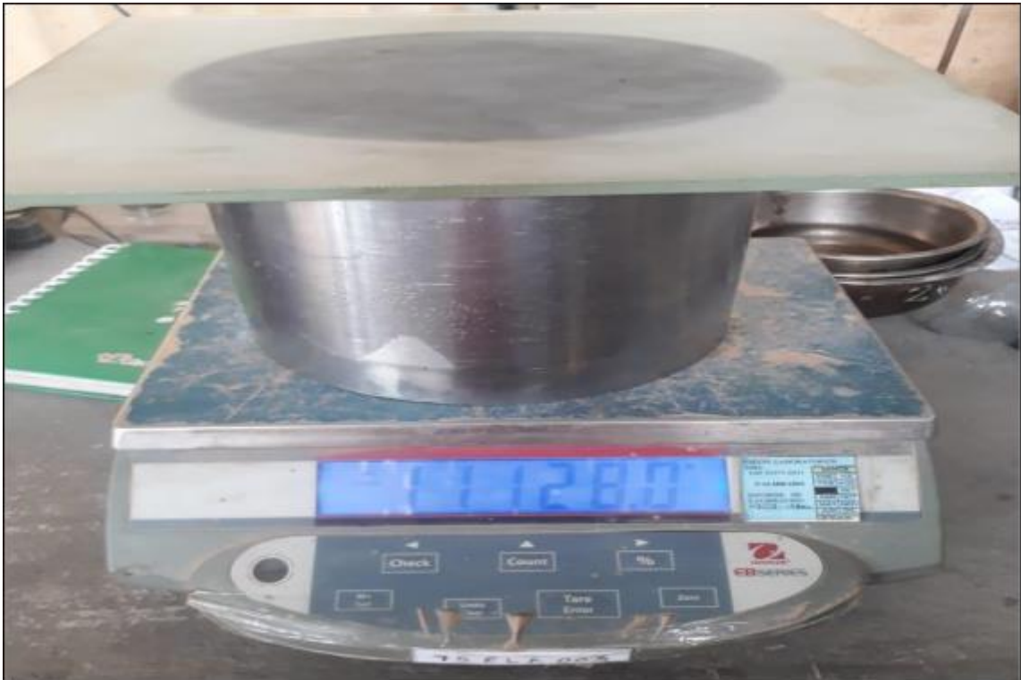
Figura N° 05: Eso es parte del ensayo rice verificación del picnómetro
