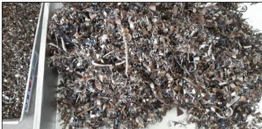
Figura 18. Almacenamiento de las virutas, posterior a su lavado y secado Fuente: Elaboración propia
