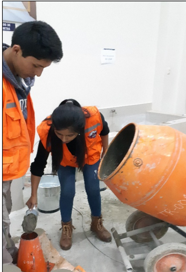
Figura 21. Colocación del concreto en el molde de ensayo Fuente: Elaboración propia
