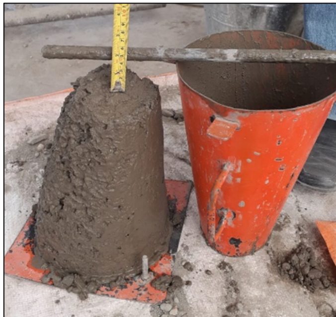
Figura 9. Asentamiento del concreto – Cono Abrams Fuente: Elaboración propia
