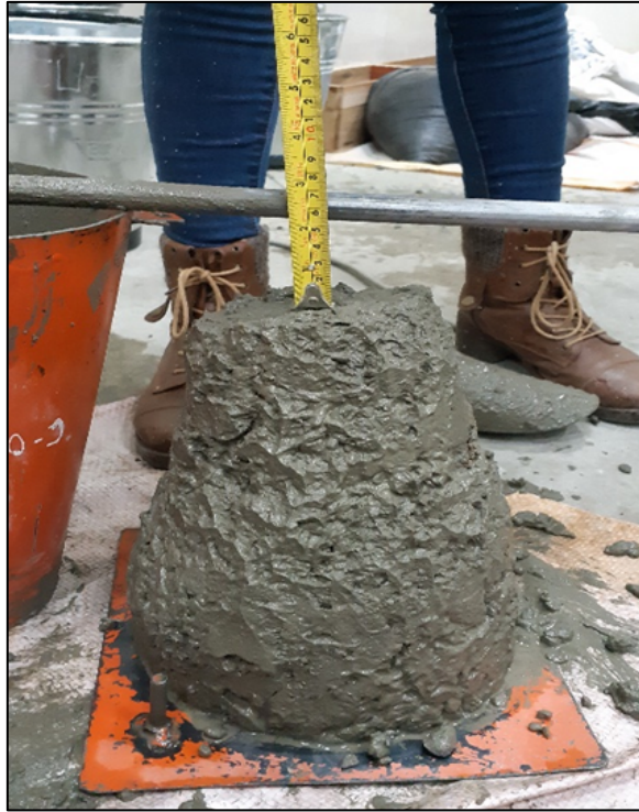
Figura 22. Medición del asentamiento del concreto Fuente: Elaboración propia
