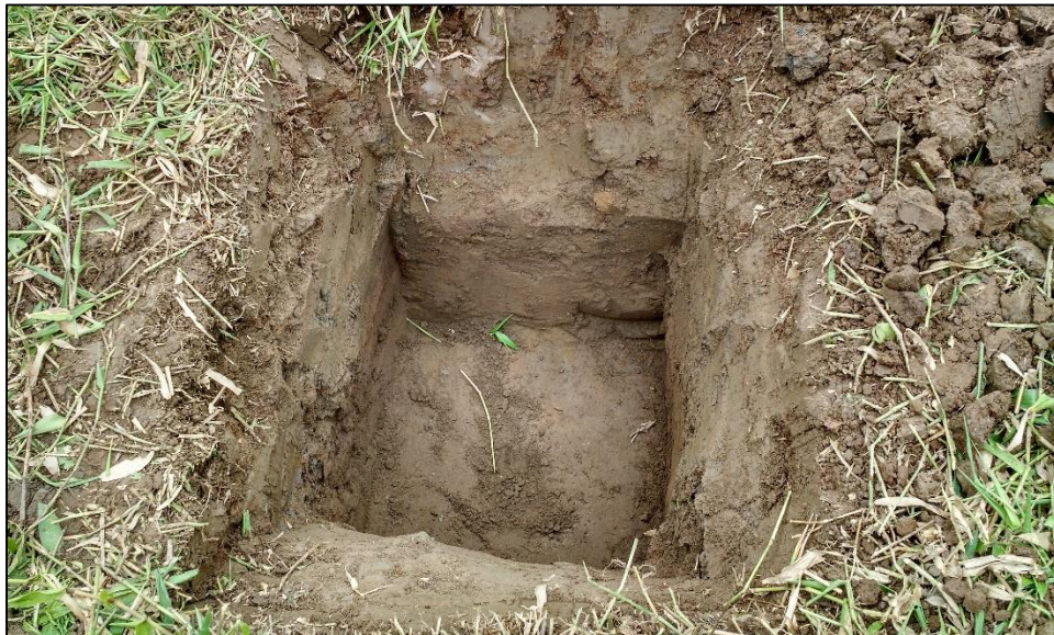
Fotografía 6. Análisis de la calicata de la vía
