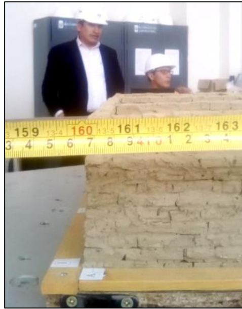
Figura 17. Medición de desplazamiento en vivienda N° 1 (testigo).
