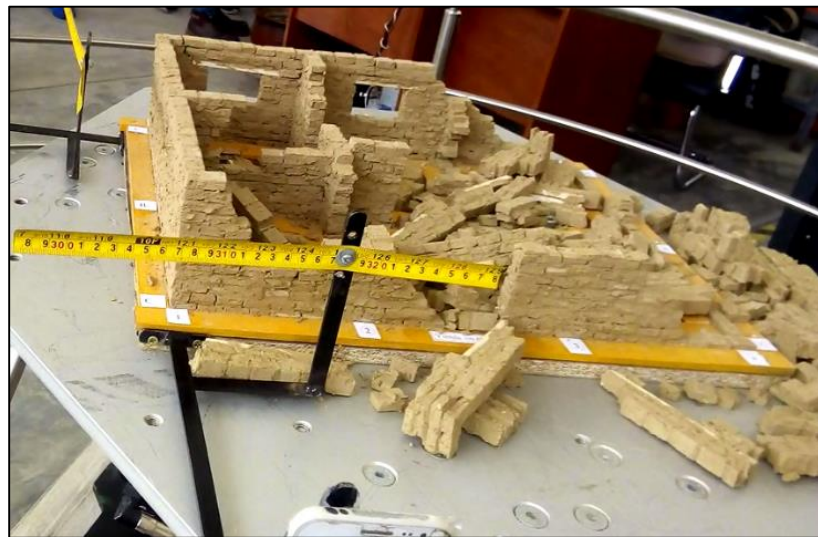
Figura 18. Falla estructura de vivienda N° 1 (testigo), a una amplitud de 0.40 mm y frecuencia de 8 hercios de vibración.
