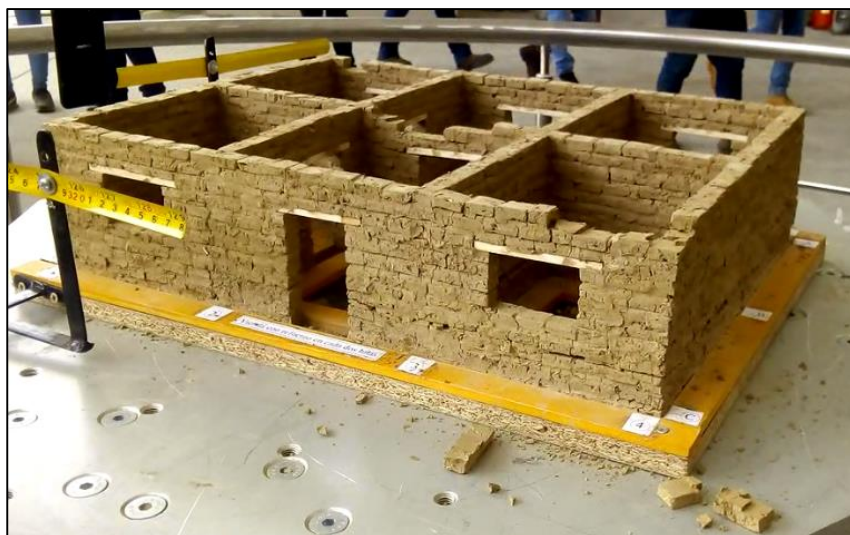
Figura 20. Supervivencia de vivienda N° 3 a una amplitud de 0.75 mm y frecuencia de 8 hercios de vibración.
