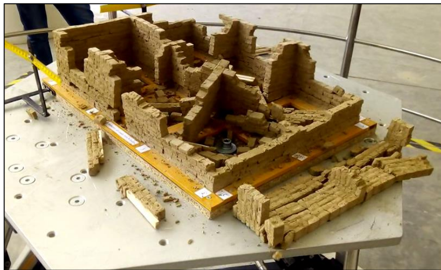
Figura 23. Falla estructura de vivienda N° 2, a una amplitud de 0.75 mm y frecuencia de 8 hercios de vibración.
