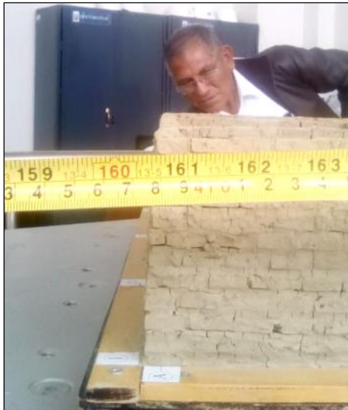
Figura 19. Regla de medición de desplazamiento en eje X, en vivienda N° 3. (Ref. c/3 hiladas)
