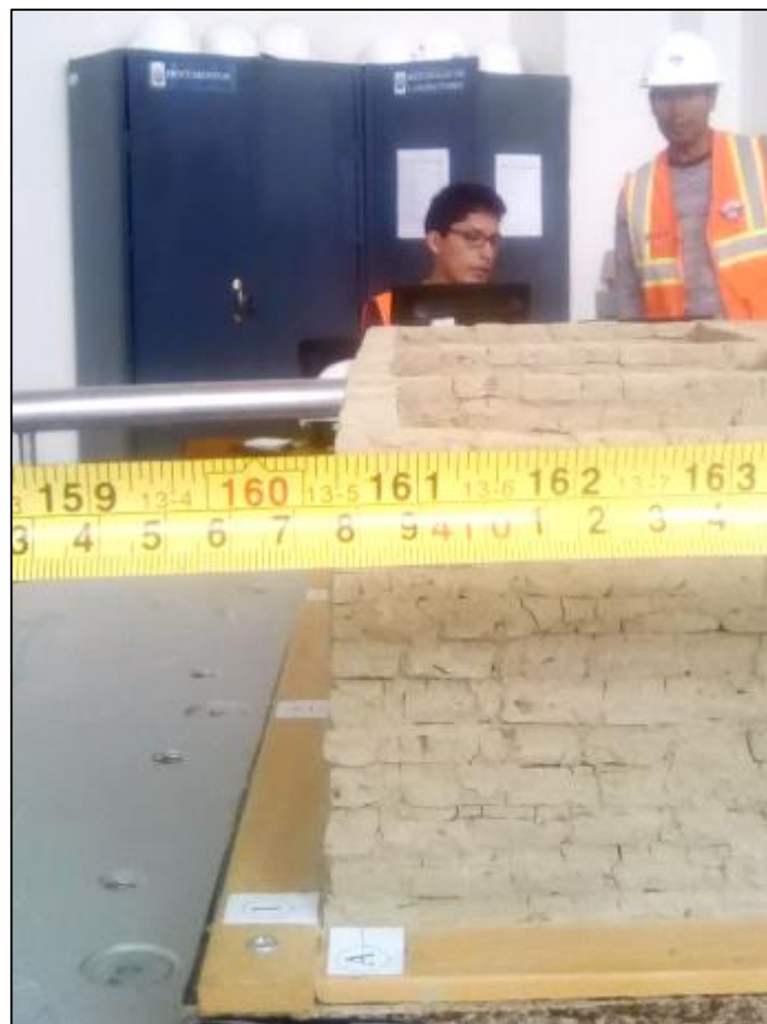
Figura 21. Regla de medición de desplazamiento en eje X, en vivienda N° 2.
