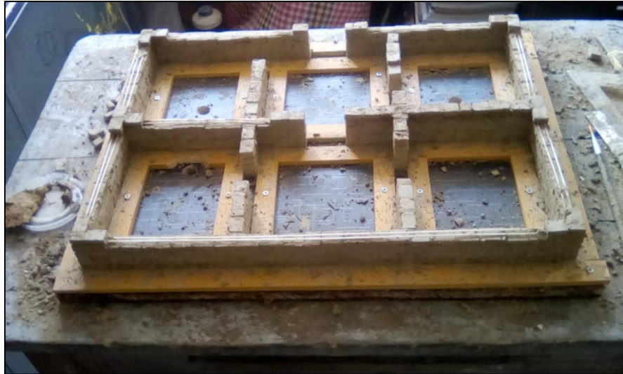
Figura 13. Colocación de refuerzo de madera en los muros.
