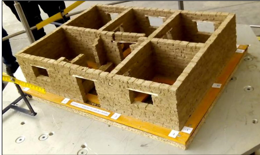
Figura 22. Sobrevivencia de vivienda N° 2 a una amplitud de 0.50 mm, y frecuencia de 8 hercios de vibración.
