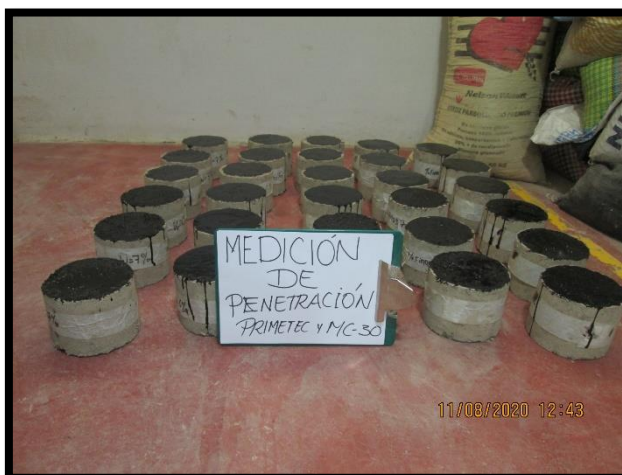
Figura 41 Briquetas a ensayar, aplicados los imprimantes
