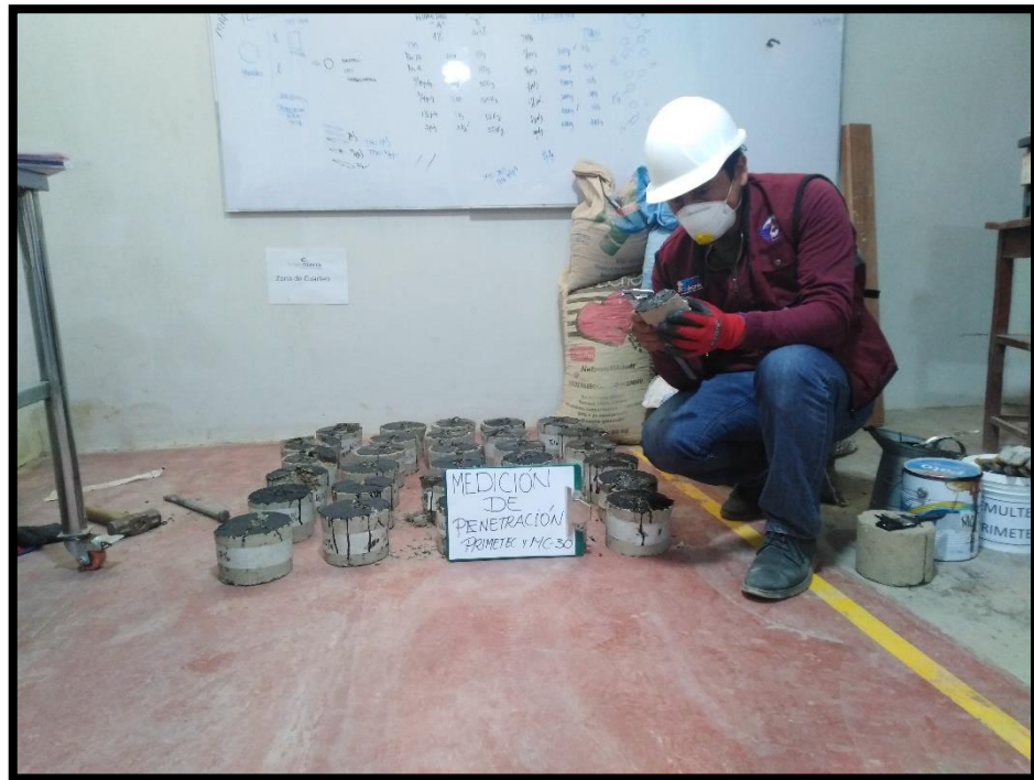
Figura 13: Toma de datos de las profundidades de penetración Fuente: Fuente propia
