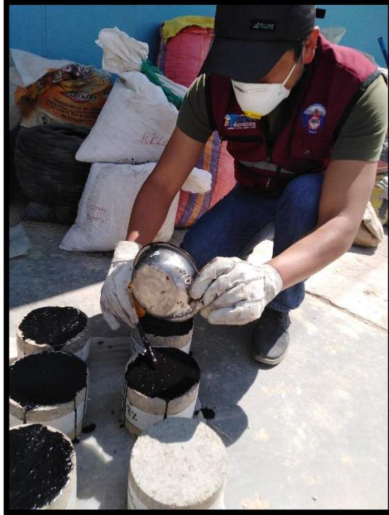
Figura 11: Ensayo de imprimación asfáltica
