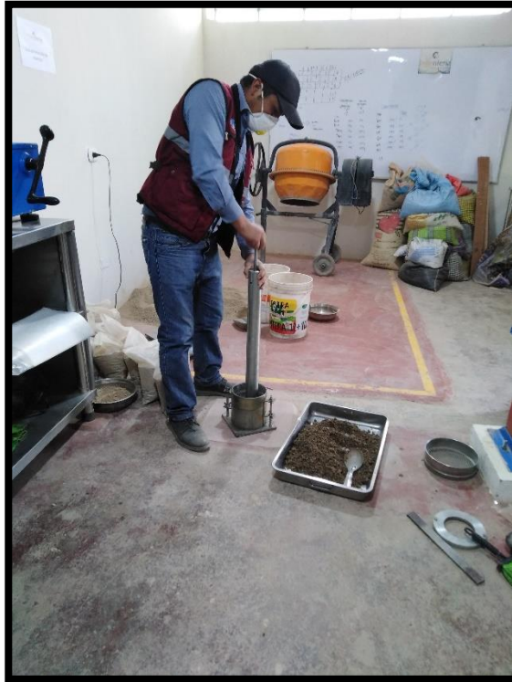
Figura 8: Ensayo de proctor Modificado Fuente: Fuente propia
