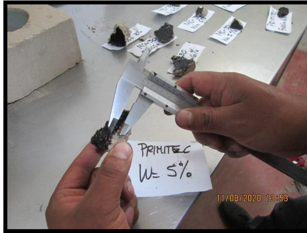
Figura 42 Midiendo la penetración del imprimante PRIMETEC
