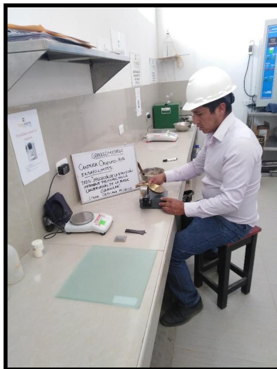
Figura 7: ensayo del límite líquido y plástico Fuente: Fuente propia
