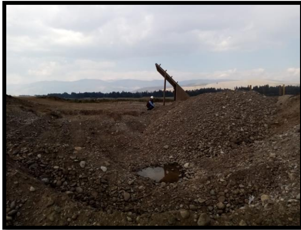
Figura 37 Recojo de muestras de base granular en la cantera Chupuro
