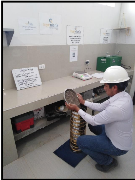
Figura 6: Tamizado de la base granular Fuente: Fuente propia
