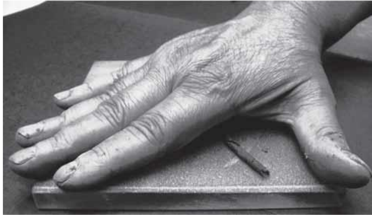
Figura 11. Ensayo de límite plástico. Fuente: Braja (2015).
