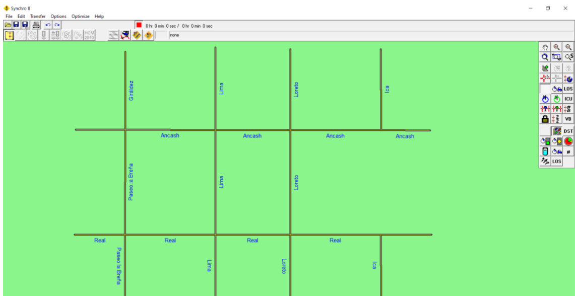
Figura 86. Ingreso de las intersecciones y nombre de calles para el modelamiento en el SYNCHRO 8
