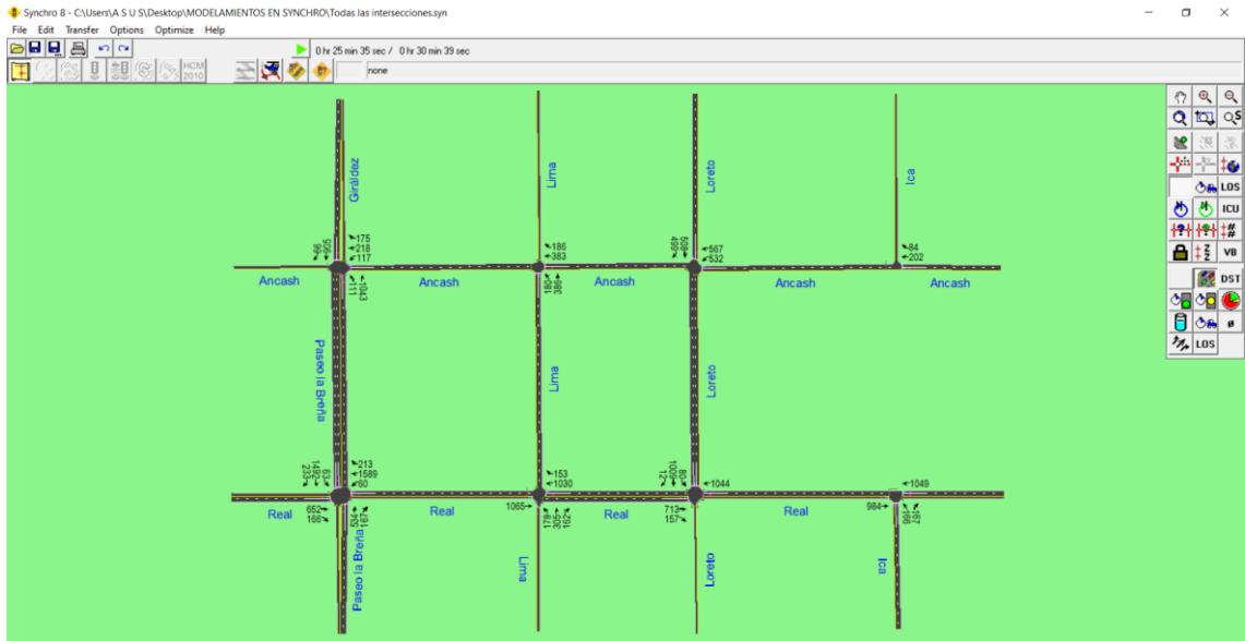
Figura 87. Ingreso al software de las restricciones de giro para cada intersección, datos de volumen vehicular y factores para el flujo de saturación mediante la ecuación señalada en el HCM 2000
