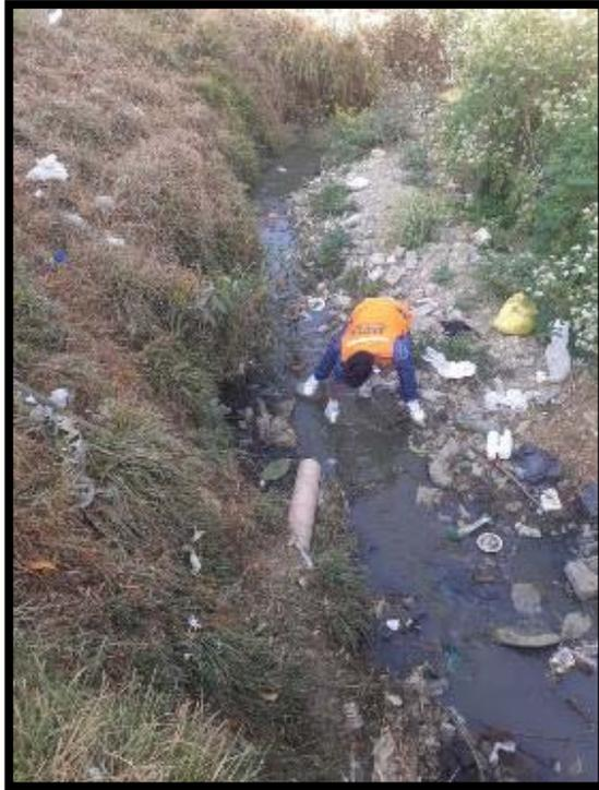
FOTO N° 03: Toma de la primera muestra de las aguas residuales.
