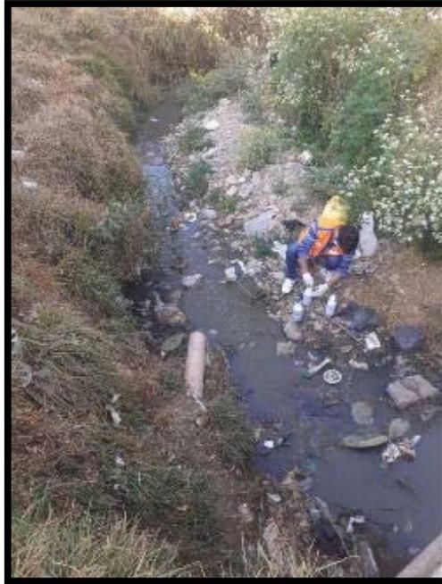
FOTO N° 05: Finalización de la toma de las 3 muestras de aguas residuales.
