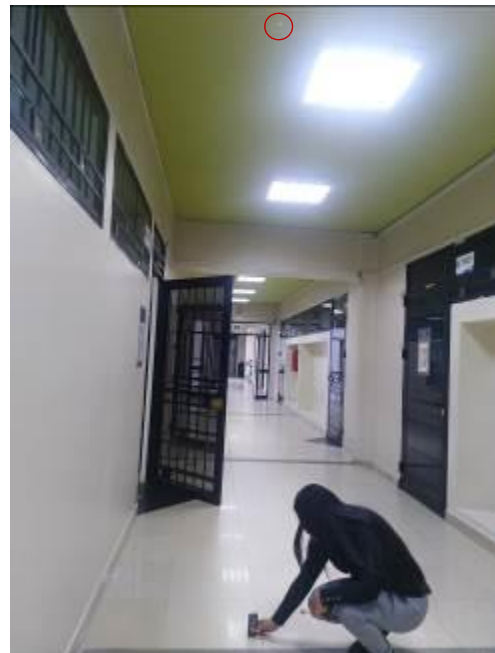
Trabajo de campo: recolección de datos – medición de altura con láser, 4to piso del pabellón I de la FIUPLA
