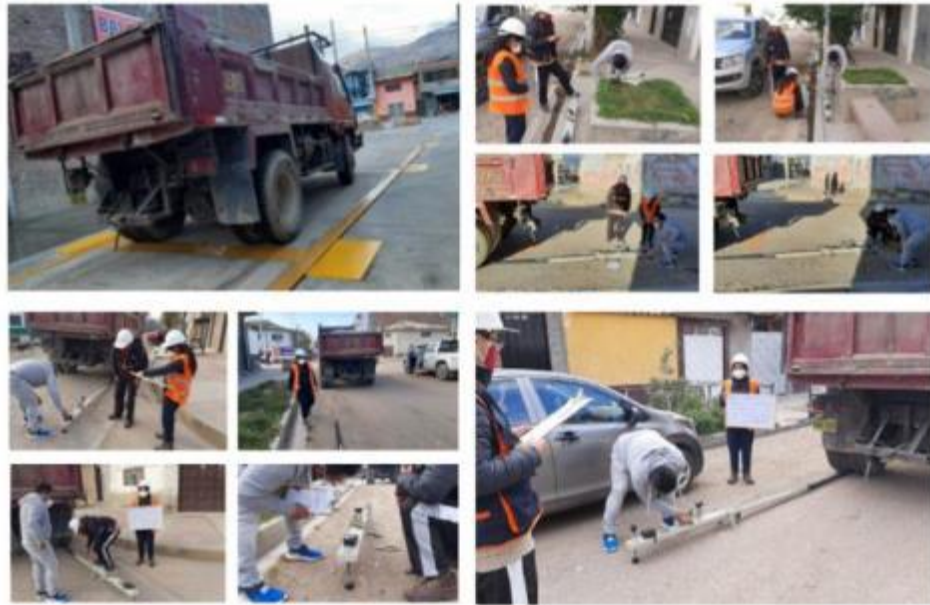
Figura 27 Ensayo para el cálculo de la deflexión de un pavimento flexible empleando la viga Benkelman Fuente: Elaboración propia
