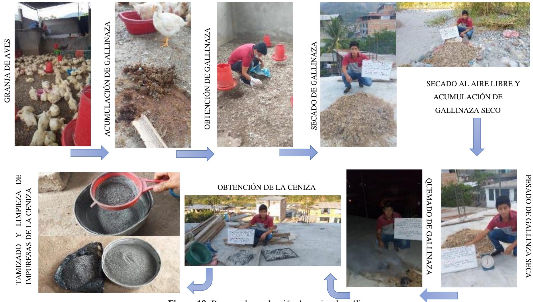
Figura 18: Proceso de producción de ceniza de gallinaza Fuente: Elaboración Propia.
