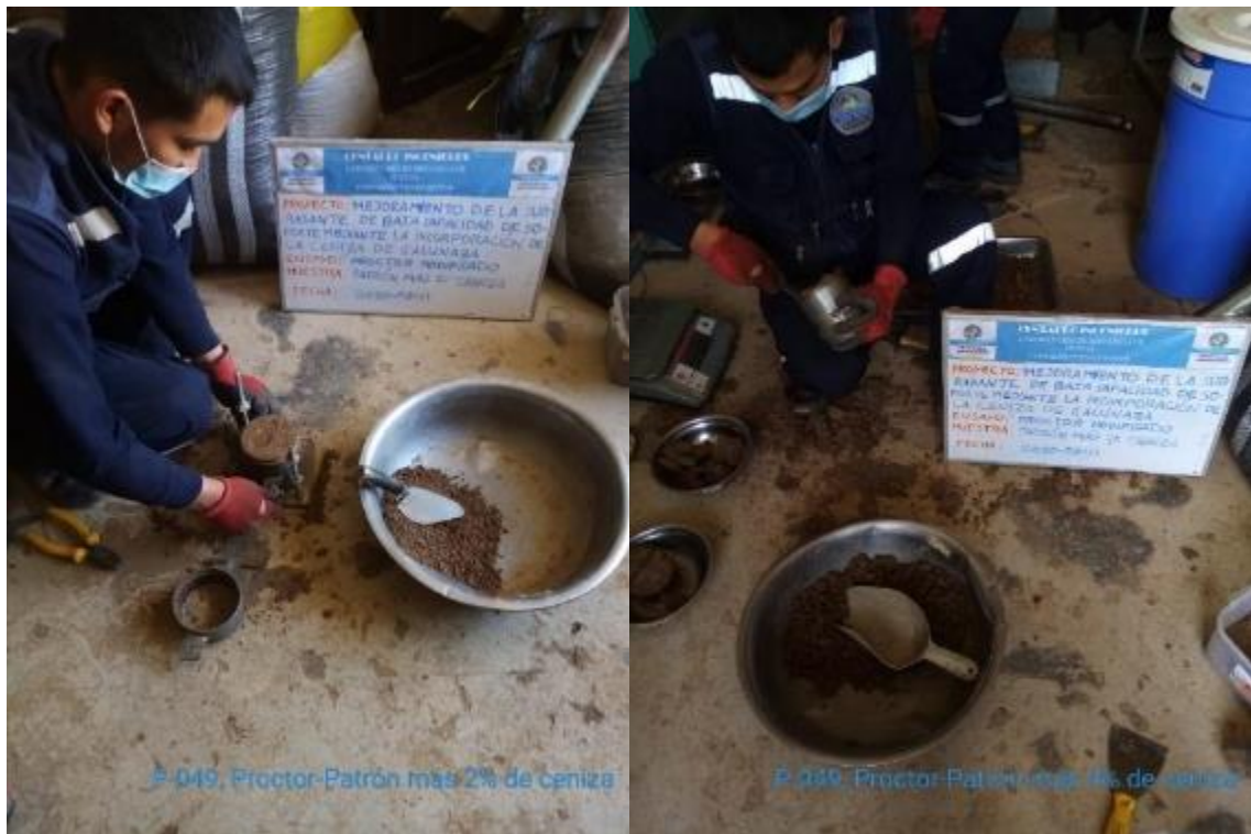
Figuras 34: Ensayo del Proctor Modificado de las Muestras.
