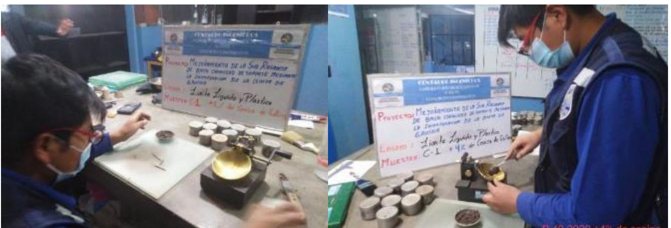
Figuras 28: Ensayo de Limites de Atterberg de las Muestras.
