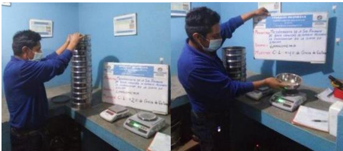
Figuras 27: Ensayo de Granulometría de las Muestras.
