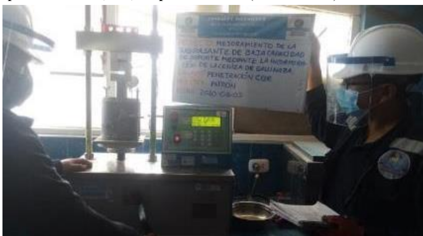
Figuras 35: Ensayos de CBR de las muestras.
