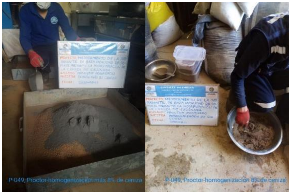
Figuras 33: Ensayo del Proctor Modificado de las Muestras (adicionado la ceniza de gallinaza y homogenización).
