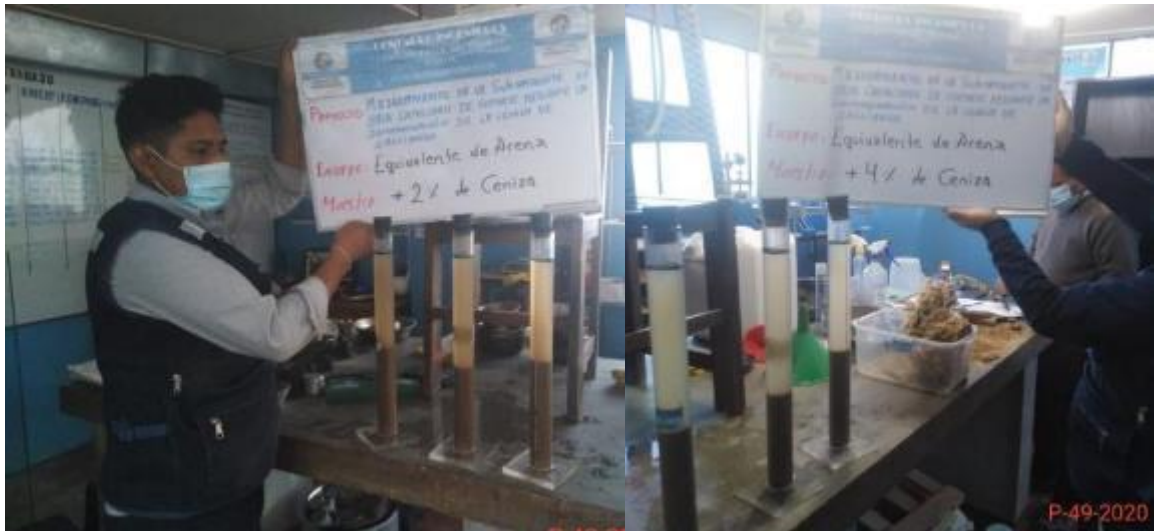
Figura 32: Ensayo de equivalente de arena de las muestras.
