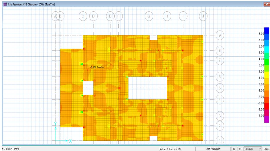
Figura 3.17. Cortantes en la losa maciza en la dirección X-X. Se muestran los momentos máximos obtenidos positivos y negativos en la losa.
