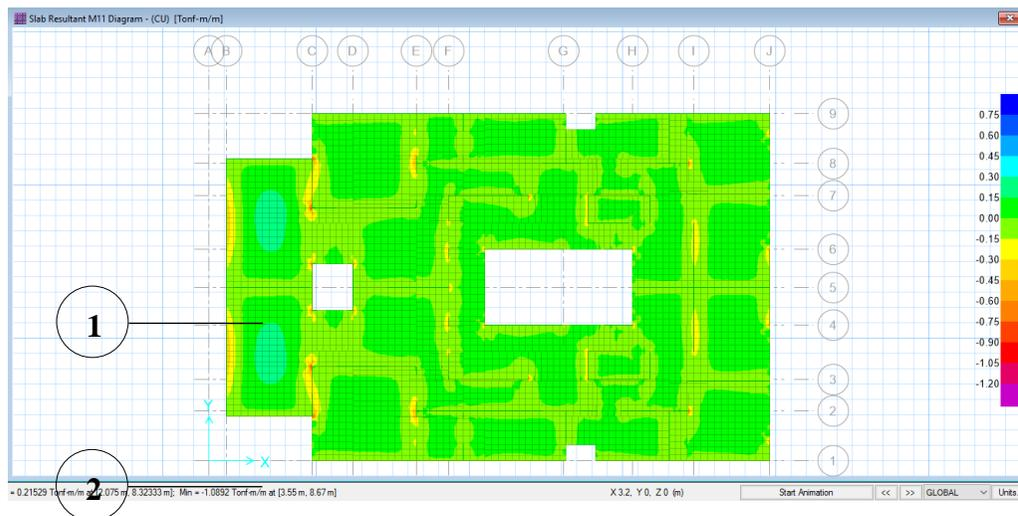
Figura 3.17. Momentos en la losa maciza en la dirección X-X. Se muestran los momentos máximos obtenidos positivos y negativos en la losa.
