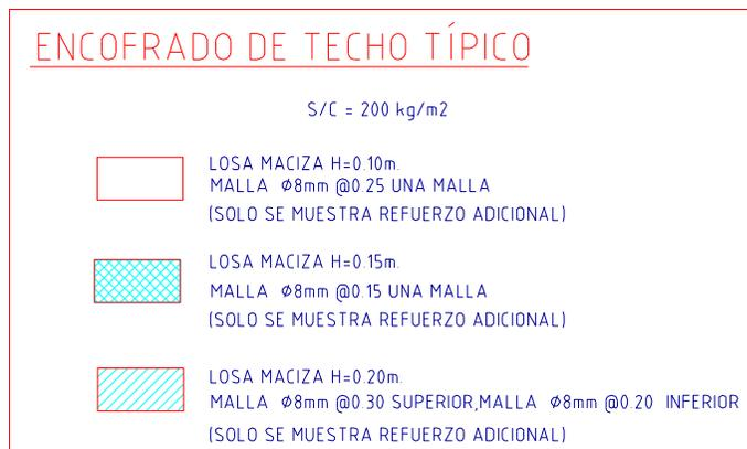
Figura 3.19. Acero de refuerzo en losas macizas.
