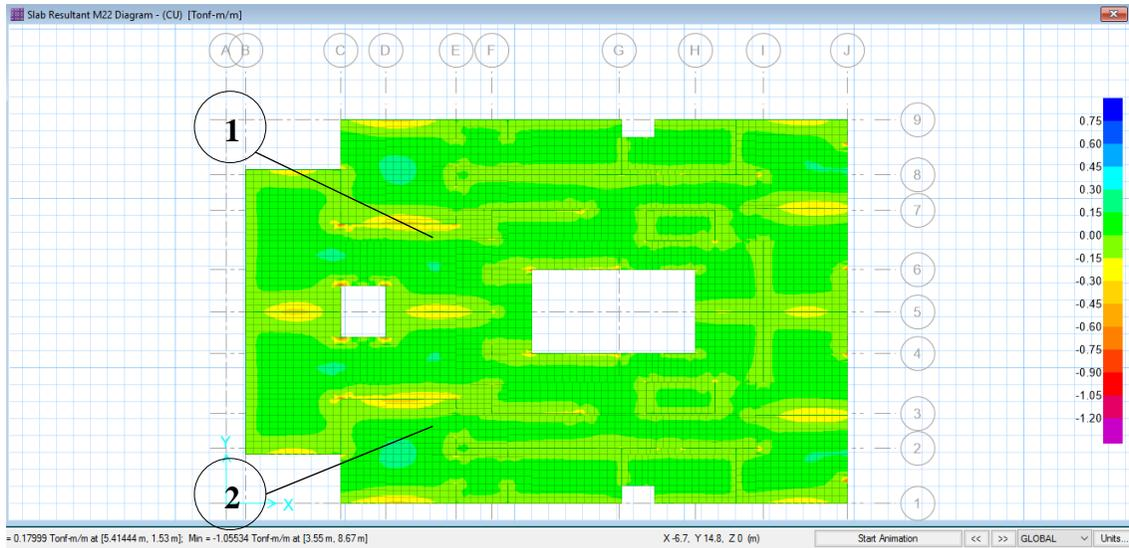
Figura 3.18. Momentos en la losa maciza en la dirección Y-Y. Se muestran los momentos máximos obtenidos positivos y negativos en la losa.
