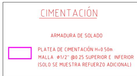
Figura 3.37. Detalle del refuerzo en platea de cimentación.
