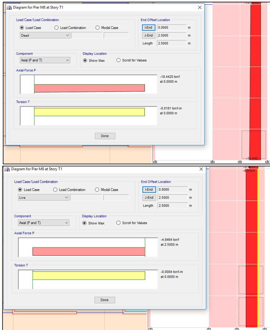
Figura 3.9. Valores de cargas de gravedad obtenidas del modelo estructural
