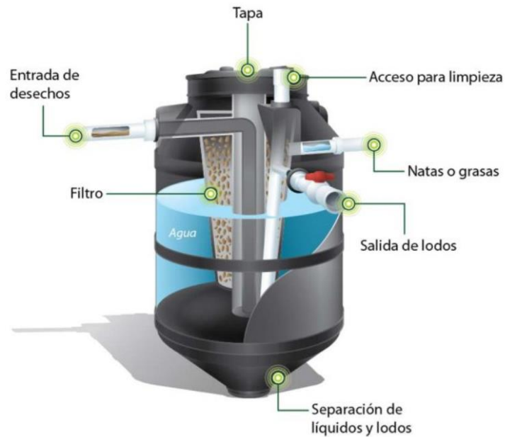
Figura 11 Partes de un tanque biodigestor Fuente: Imágenes google.
