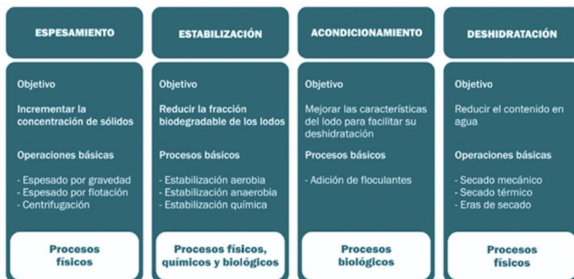
Figura N° 02 Tratamientos en la línea de lodos.
