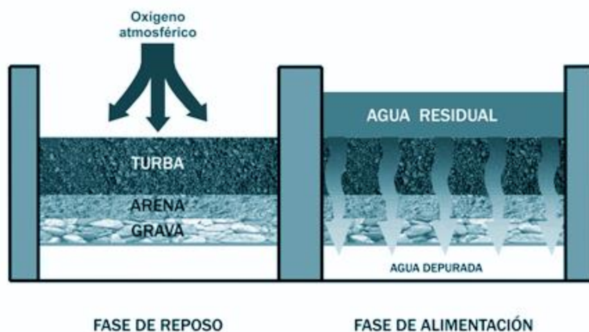
Figura N° 06 Filtro de turba en operación y en reposo
