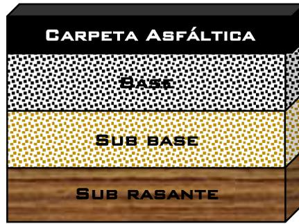
*Figura 2* Estructura del Pavimento Flexible
