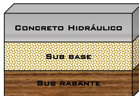
*Figura 1* Estructura del Pavimento Rígido
