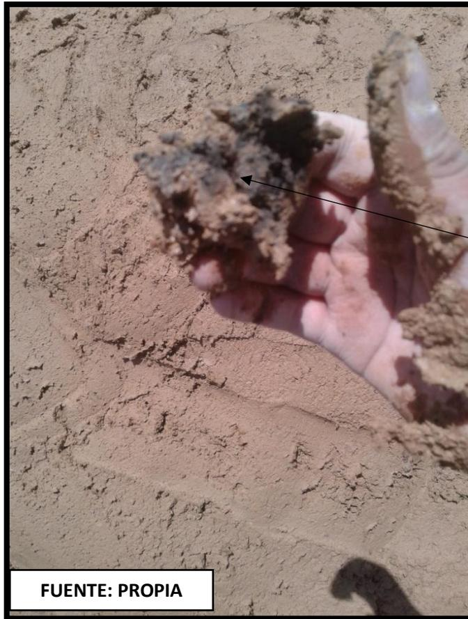
Al final de los trabajos del preparado de la mezcla para posteriormente ser moldeado los ladrillos, se observó inconsistencias en la masa como tierra negra y trozos de plástico
