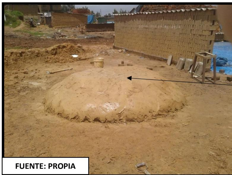
Como resultado se forma un cumulo de masa hidratada. Preparada y lista la masa se dejó reposar durante 15 – 20 horas
