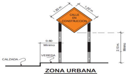
FIGURA 4.2.3.01 POSICION DE LAS SEÑALES EN ZONAS EN TRABAJO
