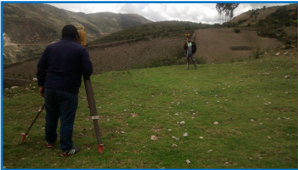
FOTO N.04: SE PUEDE OBSERVAR EL LEVANTAMIENTO TOPOGRAFICO DONDE SE VA DISEÑAR LA PLANTA DE TRATAMIENTO.
