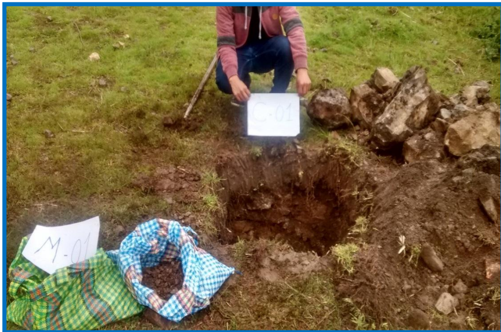
FOTO N. 06: SE OBSERVA LA EXCAVACION DE LA CALICATA N. 01 PARA SU ESTUDIO EN EL LABORATORIO DE SUELOS.
