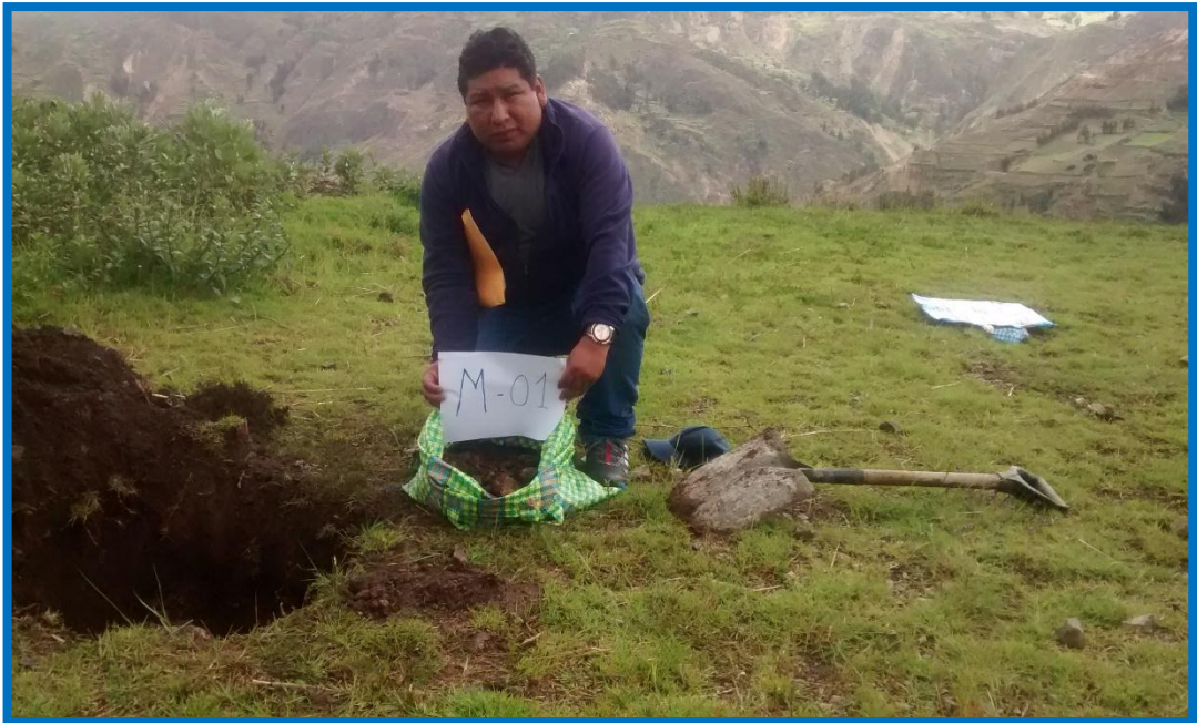
FOTO N.05: SE OBSERVA LA EXCAVACION DE LA CALICATA PARA LA MUESTRA N. 01 PARA SU RESPECTIVO ESTUDIO EN LABORATORIO.
