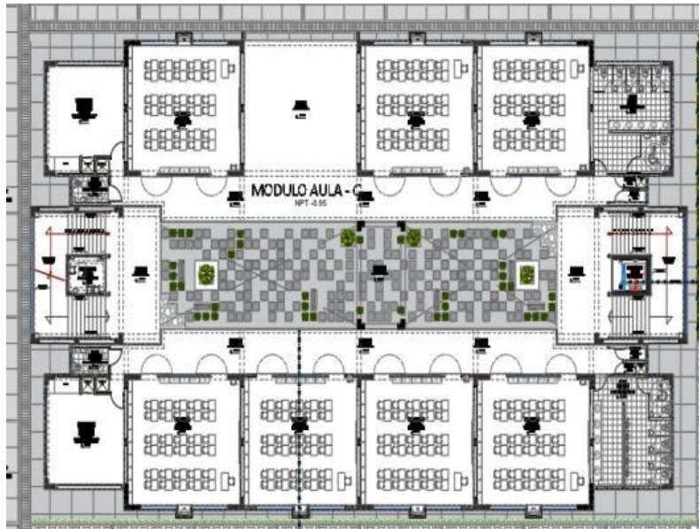
Figura 30. Plano arquitectónico módulo Aulas
