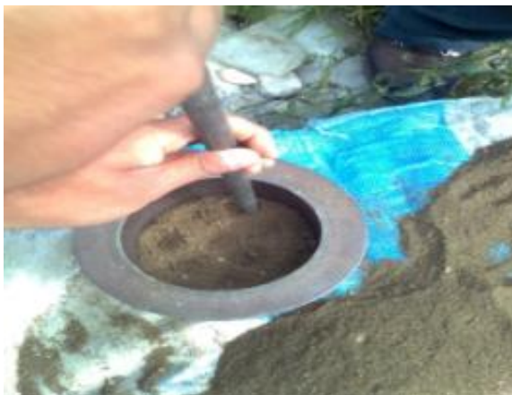
FOTOGRAFIA 31: Apasionando el agregado con la varilla compactadora (25 golpes)
