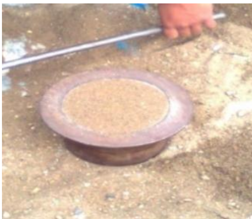
FOTOGRAFIA 23: Molde y barra compactadora utilizados en el ensayo
