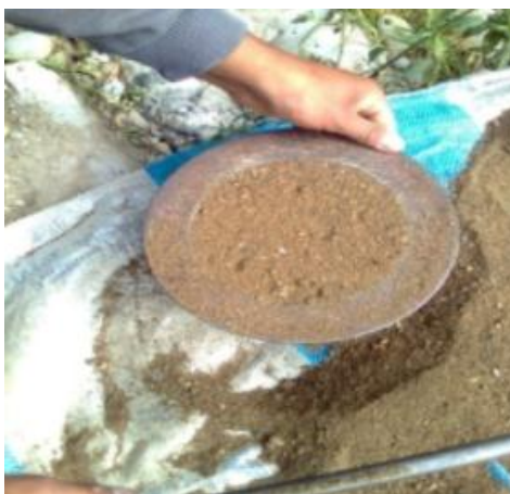
FOTOGRAFIA 33: Enrazando el recipiente o Eliminando el exceso de agregado
