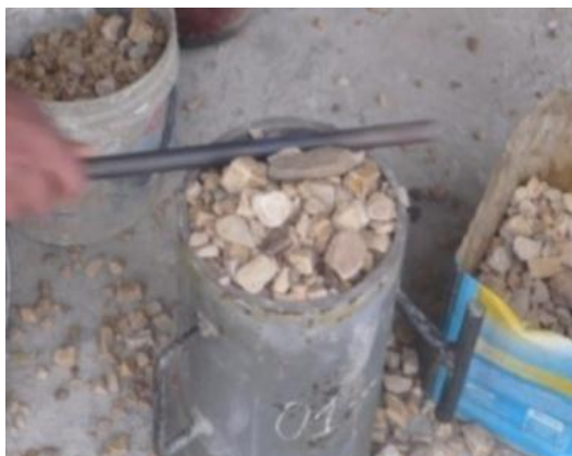
FOTOGRAFIA 39: Enrazado del agregado grueso
