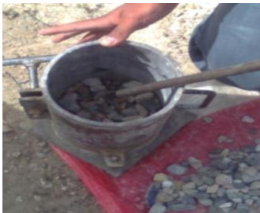
FOTOGRAFIA 36: Primera etapa de compactación (25 golpes)
