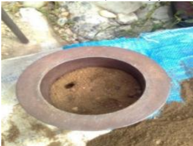
FOTOGRAFIA 30: Llenando el recipiente con el agregado fino
