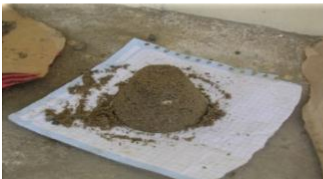
FOTOGRAFIA 18: Muestra en estado de SSS, puesto que se rebajó con referencia del principio
