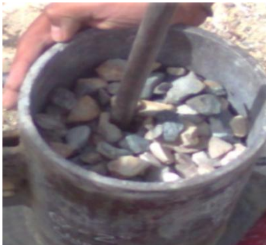
FOTOGRAFIA 37: Segunda etapa de compactación (25 golpes)
