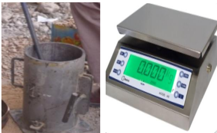
FOTOGRAFIA 35:/ Recipiente, barra compactadora y balanza
