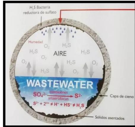
Figura 6. Formación de sulfuro
