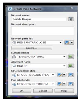
Figura 12. Configuracion de etiuqeta de tuberia
