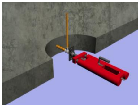
Figura 22. Tensión de los cables con la gata.
