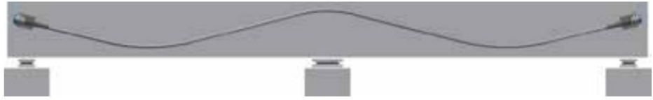
Figura 2. Esquema de cables en concreto postensado.
