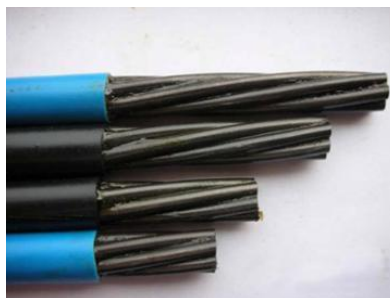
Figura 11. Cables no adheridos.
