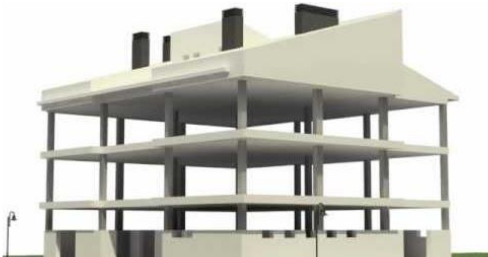
Figura 24. Estructura de sistema aporticado.
