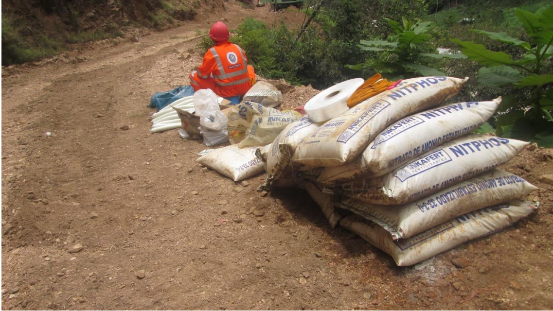
FOTOGRAFIA N° 19: Exposición del material para la voladura en ambientes inadecuados propenso a ser mojado por lluvias
