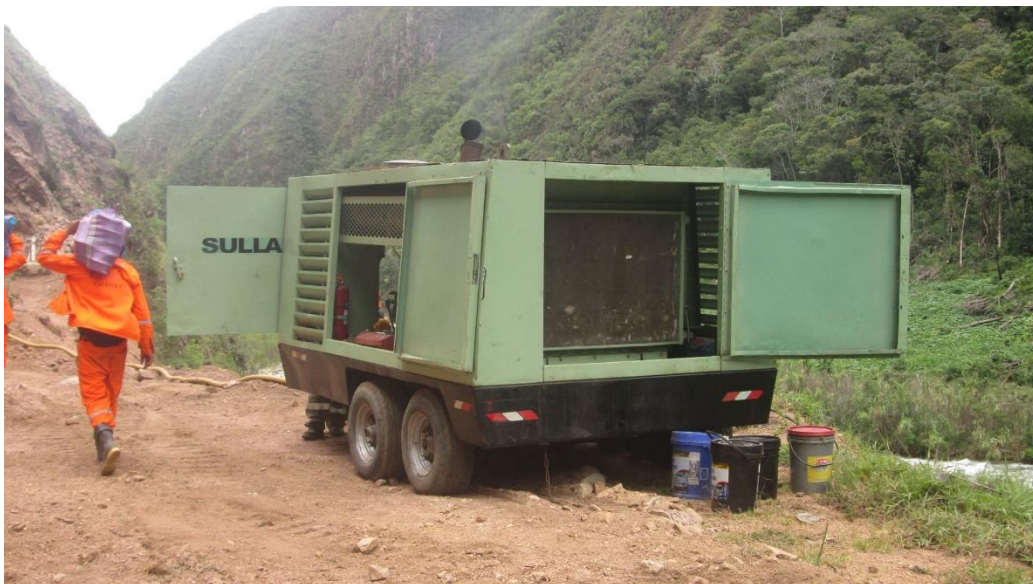
FOTOGRAFIA N° 16: maquinaria (compresora de aire) sin el adecuado estacionamiento – borde del río
