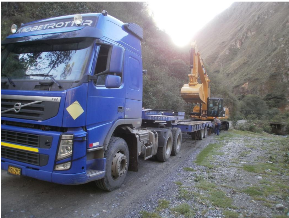
FOTOGRAFIA N° 26: remolque de maquinaria en lugares inadecuados ( lugares confinados)
