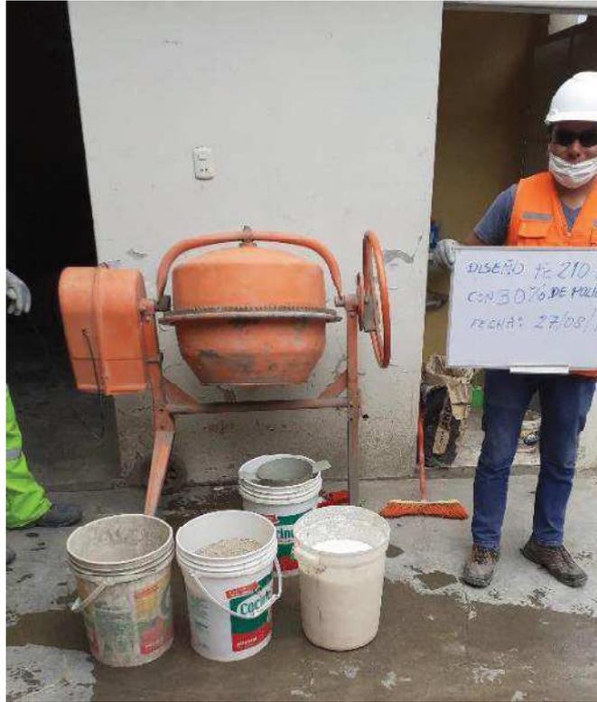
**Foto N° 03:** MATERIALES PARA LA PREPARACION DEL CONCRETO CON 30% DE POLIESTIRENO F'c 210, En la Fotografía se observa los materiales que se utilizó para la preparación del concreto con poliestireno.
