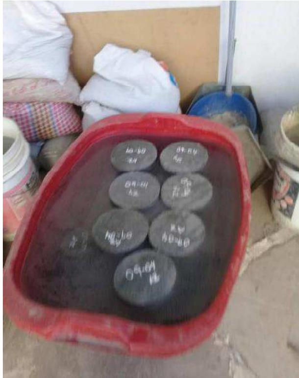
**Foto N° 13:** POZO DE CURADO DE PROBETAS
