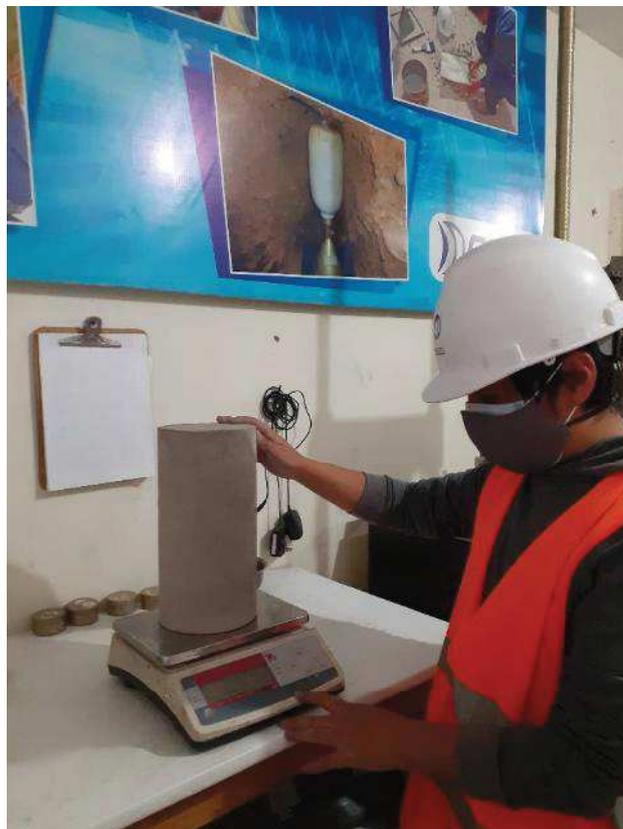
**Foto N° 11:** CONTROL DE PESO DE LA PROBETA, En la Fotografía se observa el control de peso con una balanza electrónica.
