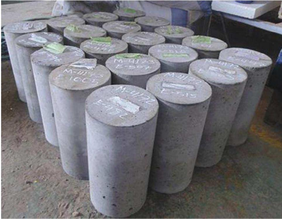
**Foto N° 12:** PROBETA EXTRAIDAS DEL MOLDE, En la Fotografía se observa el marcado de las probetas para poder ser diferenciadas.
