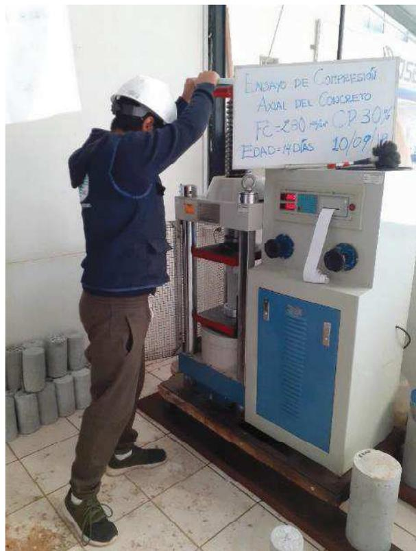
**Foto N° 15:** PROBETA CON POLIESTIRENO DESPUES DEL ENSAYO DE COMPRESION
