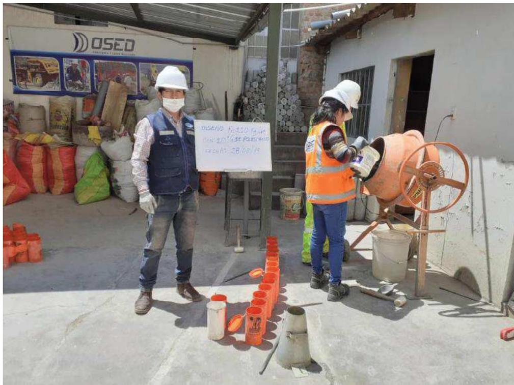
**Foto N° 05:** MATERIALES PARA LA PREPARACION DEL CONCRETO CON 20% DE POLIESTIRENO F'c 210, En la Fotografía se observa los materiales que se utilizó para la preparación del concreto con poliestireno.
