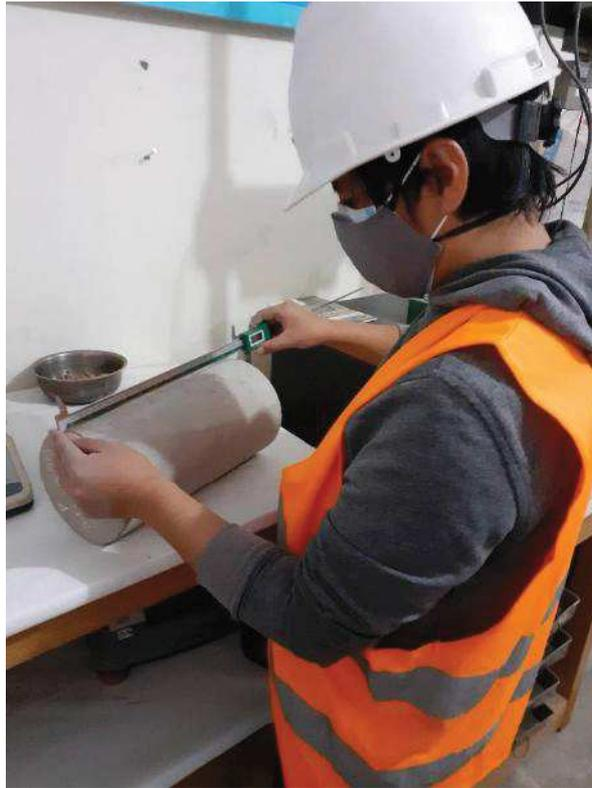
**Foto N° 10:** CONTROL DE DIMENSIONES DE LA PROBETA, En la Fotografía se observa la medición del diámetro de la probeta con el calibre digital.
