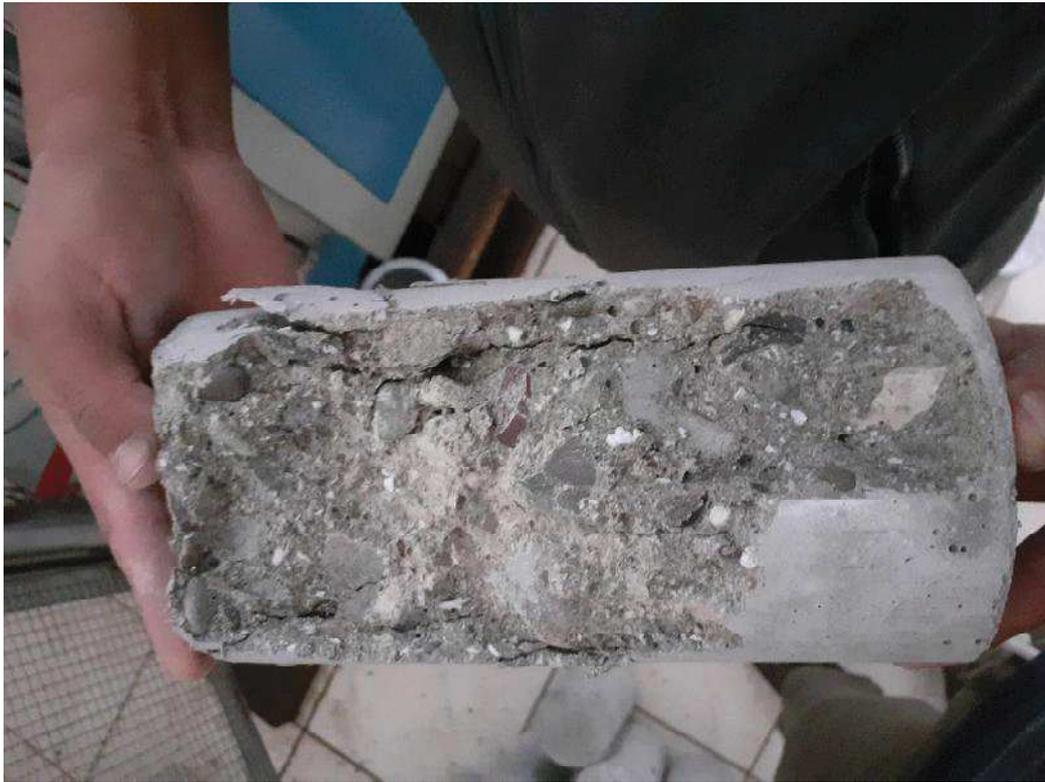
**Foto N° 16:** VISTA DE UNA PROBETA CON POLIESTIERNO DESPUES DEL ENSAYO DE COMPRESION.
