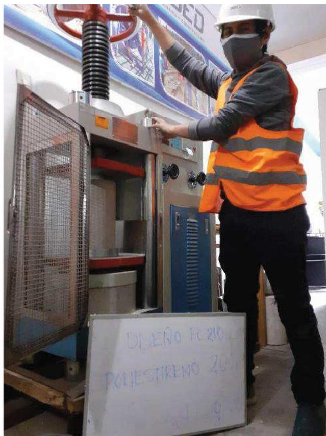
**Foto N° 12:** PROBETA SIN POLIESTIRENO ENSAYO DE COMPRESION SIMPLE.
