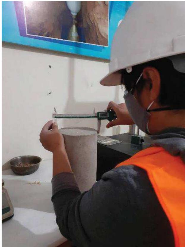
**Foto N° 10:** CONTROL DE DIMENSIONES DE LA PROBETA, En la Fotografía se observa la medición de la altura de la altura con el calibre digital.
