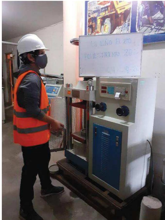
**Foto N° 14:** PROBETA CON POLIESTIRENO ENSAYO DE COMPRESION SIMPLE.
