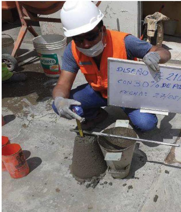
**Foto N° 07:** ENSAYO DEL REVENIMIENTO DEL CONCRETO CON POLIESTIERNO 30% FC 210, En la Fotografía se observa la medición del asentamiento.
