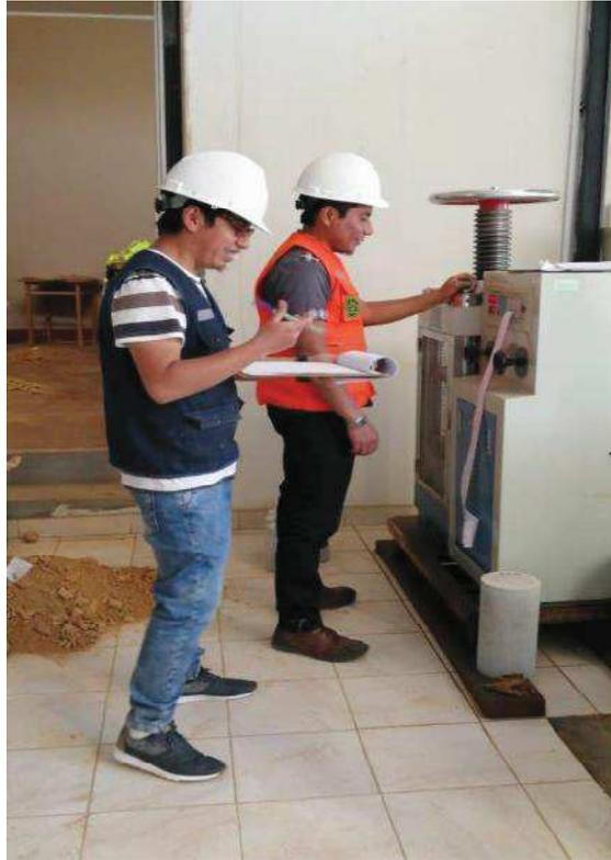
**Foto N° 11:** PROBETA SIN POLIESTIRENO ENSAYO DE COMPRESION SIMPLE.
