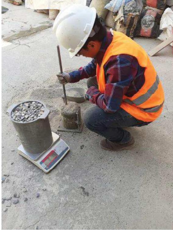
**Foto N° 01:** DETERMINAR EL PUC, En la Fotografía se observa el ensayo para determinar el peso unitario compactado del agregado grueso.
