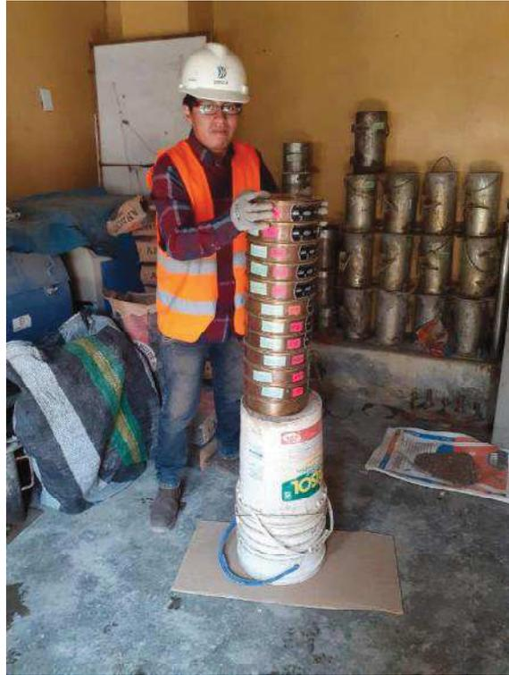
**Foto N° 03:** TAMIZADO DEL AGREGADO, En la Fotografía se observa el tamizado para el análisis granulométrico.
