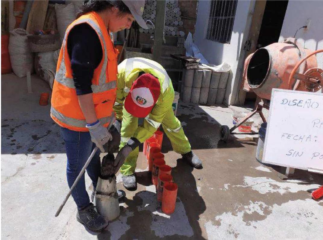
**Foto N° 07:** PREPARACION DE ENSAYO DE REVENIMIENTO, En la Fotografía se observa el llenado de cono de abrams.
