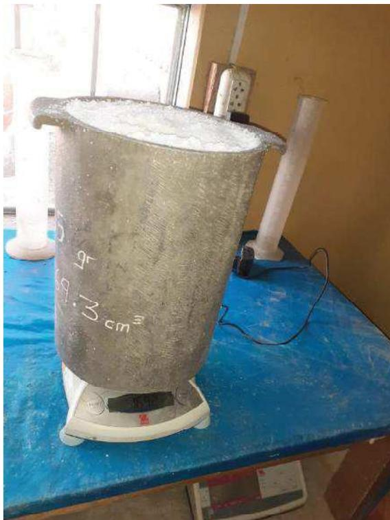
**Foto N° 02:** PESO UNITARIO, En la Fotografía se observa el procesamiento para la obtención del peso unitario del poliestireno triturado.
