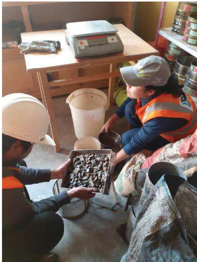
**Foto N° 04:** DETERMINAR EI PESO ESPECIFICO, En la Fotografía se observa el ensayo para determinar el peso específico del agregado fino.
