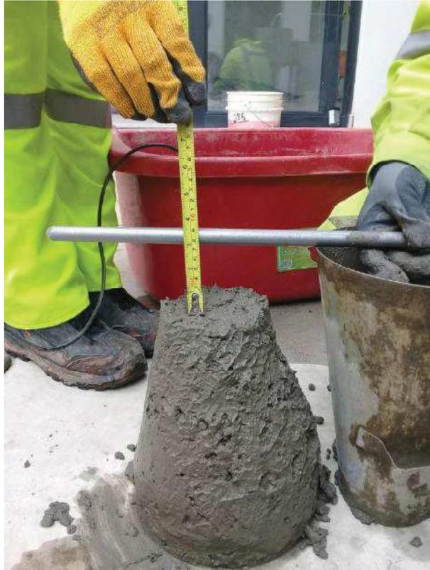
**Foto N° 09:** ENSAYO DEL REVENIMIENTO DEL CONCRETO FC 210, En la Fotografía se observa la medición del asentamiento.
