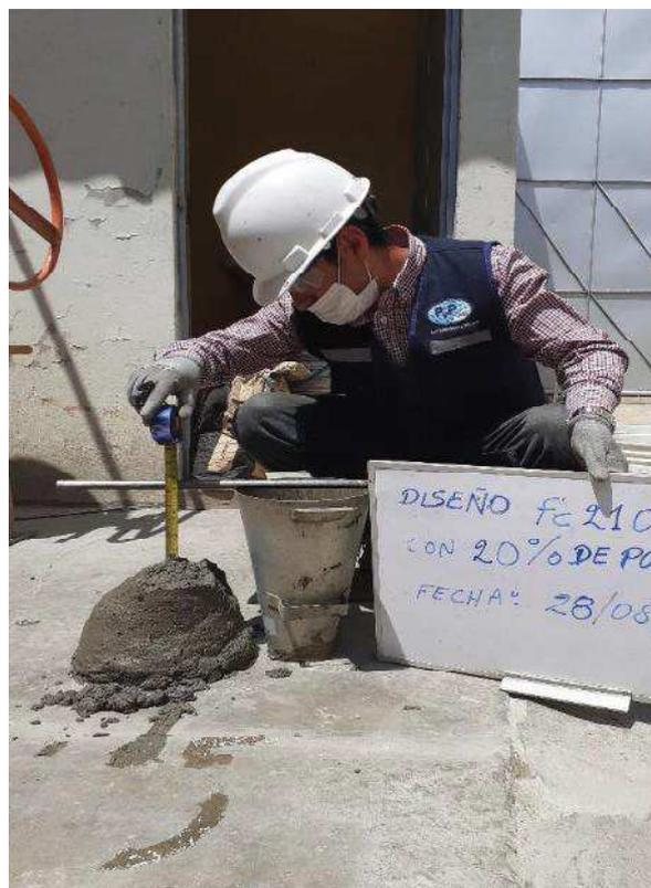
**Foto N° 09:** ENSAYO DEL REVENIMIENTO DEL CONCRETO CON POLIESTIERNO 20% FC 210, En la Fotografía se observa la medición del asentamiento.
