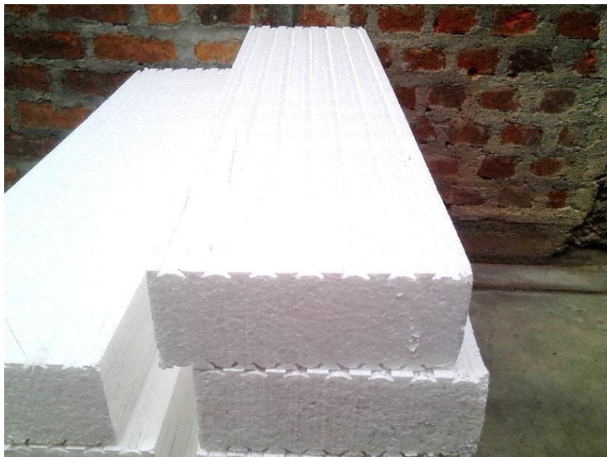
Imagen Nro. 45: Diseño y construcción del casetón – acabado.
