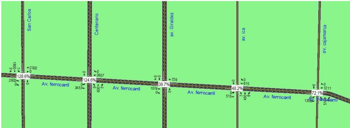
Figura 31. Capacidad de utilización de las intersecciones del corredor de la Av. Ferrocarril con 2 restricciones.
