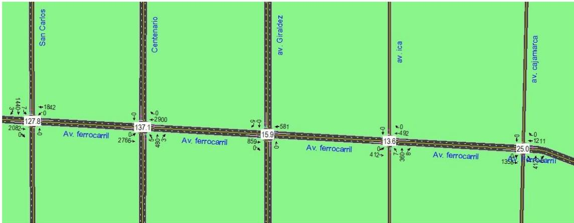
Figura 37. Retraso de las intersecciones del corredor de la Av. Ferrocarril con 3 restricciones.
