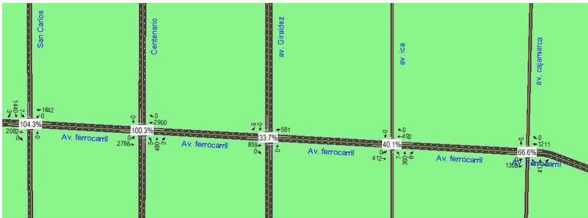
Figura 35. Capacidad de utilización de las intersecciones del corredor de la Av. Ferrocarril con 3 restricciones.
