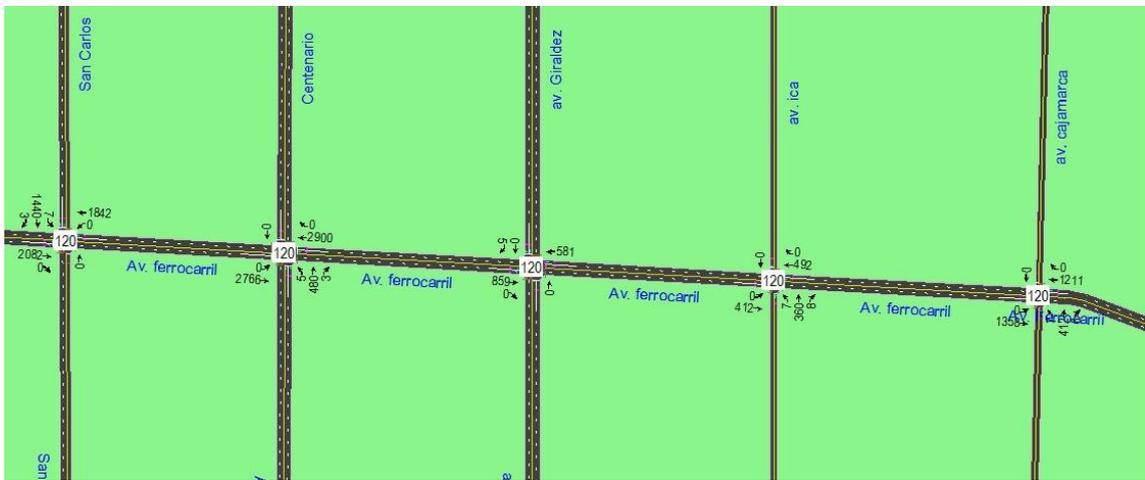
Figura 38. Tiempo de semáforos de las intersecciones del corredor de la Av. Ferrocarril con 2 restricciones.
