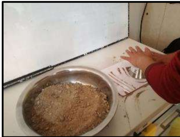
Fotografía 6.- ) Ensayo del material fino pasante del tamiz N°200
