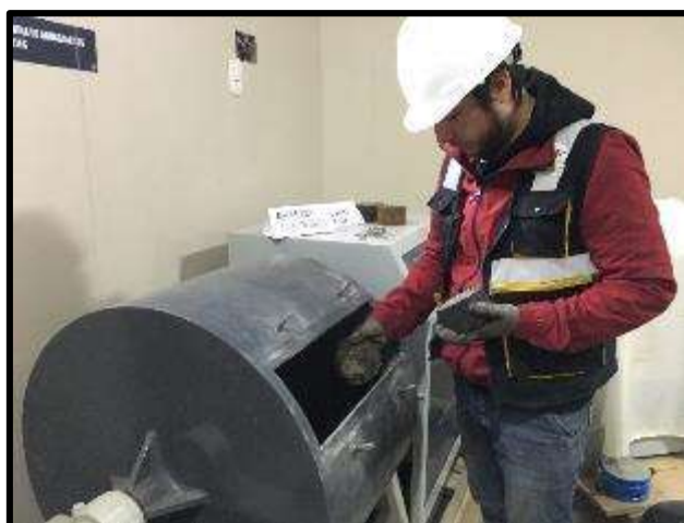
Fotografía 16.- Ensayo Cántabro a diseño de mezcla asfáltica con relleno mineral
