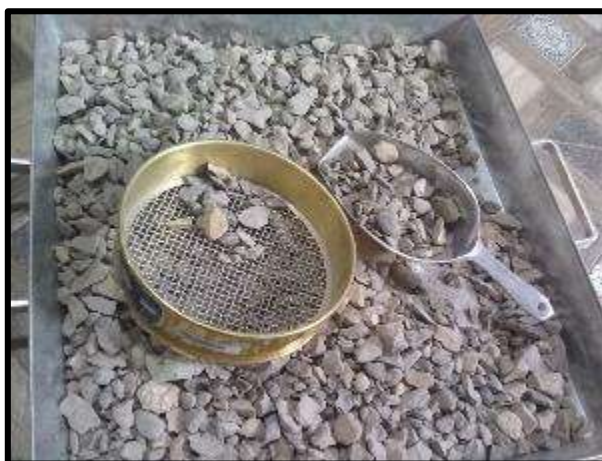
Fotografía 1.- Ensayo análisis Granulométrico del agregado Grueso
