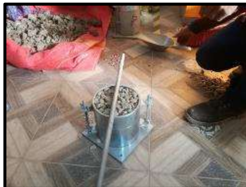
Fotografía 3.- Ensayo peso unitario y porcentaje de vacíos de agregados gruesos
