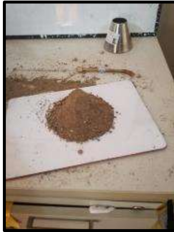
Fotografía 5.- Ensayo gravedad específica y absorción de agregados finos
