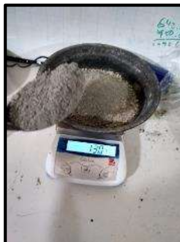
Fotografía 12.- Ensayo de análisis Granulométrico del Relleno Mineral
