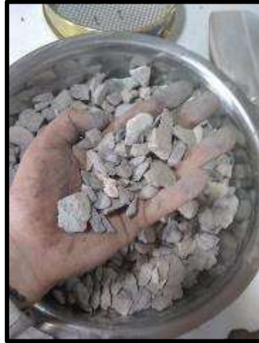
Fotografía 2.- Ensayo de porcentaje de caras fracturadas en los agregados
