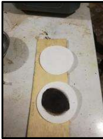
Fotografía 9.- Ensayo solubilidad de materiales asfálticos
