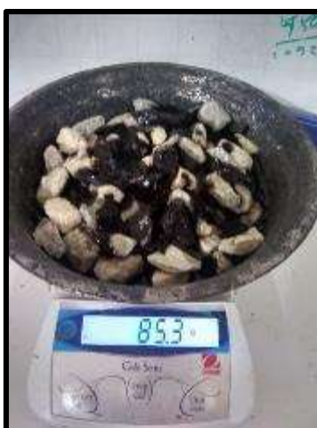
Fotografía 11.- Ensayo de cubrimiento y resistencia al desplazamiento
