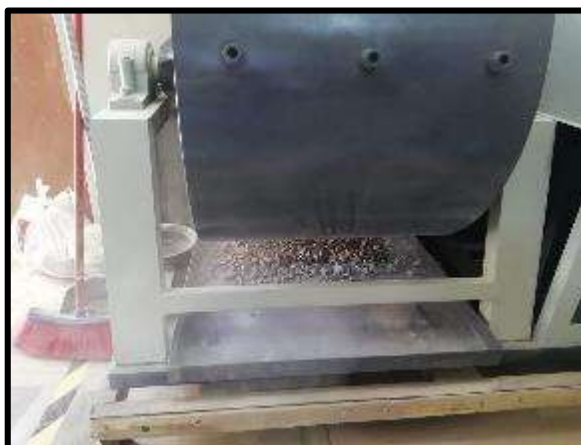
Fotografía 4.- Ensayo de abrasión de los Ángeles
