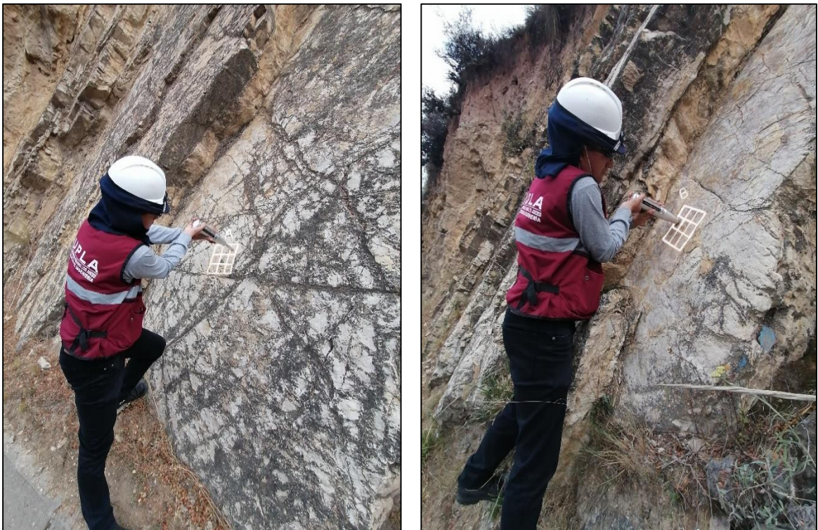
Fotografía 12. Resistencia a compresión en zonas determinadas.
