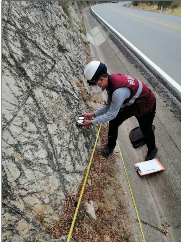
Fotografía 7. Toma de datos de buzamiento.
