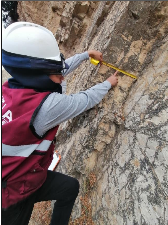
Fotografía 9. Toma de datos de espaciamento
