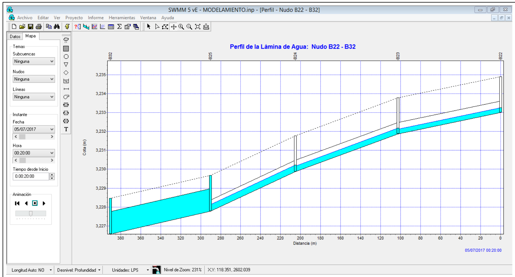
Figura 19. Perfil longitudinal desde el buzón B22 hasta el B32.
