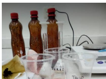
AFORAR CON SOLUCION TAMPON DE ACETATO DE SODIO pH 4.5
