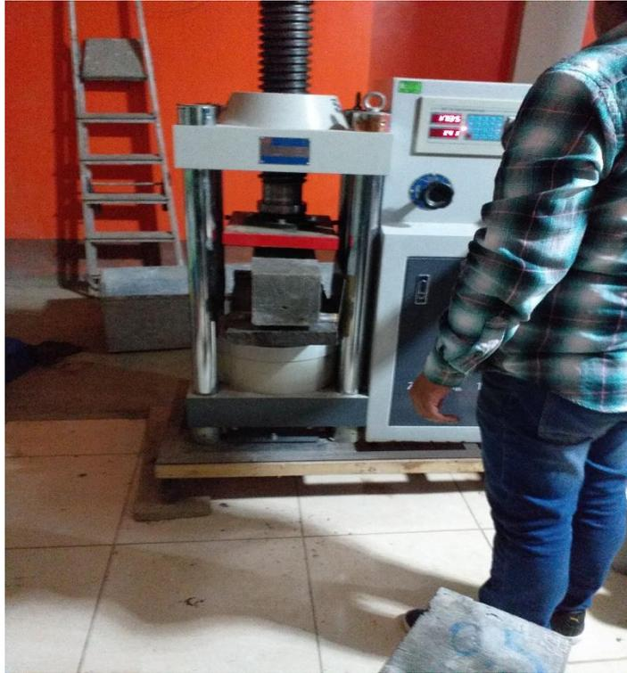
Fotografía 11. Vigas simples de concreto convencional ensayadas a flexión para 21 días de edad.
