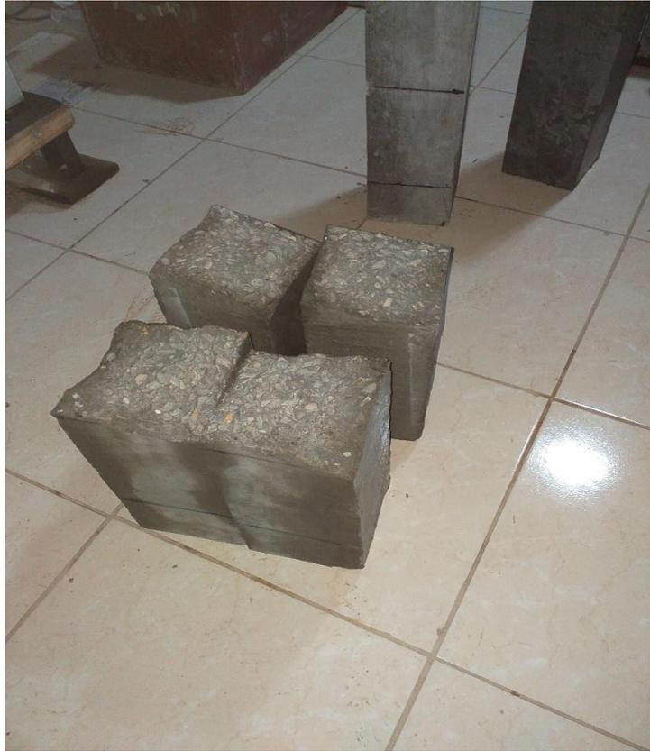
Fotografía 21. Vigas simples de concreto con polvo de vidrio añadido en relación al cemento roturadas en el ensayo a flexión.
