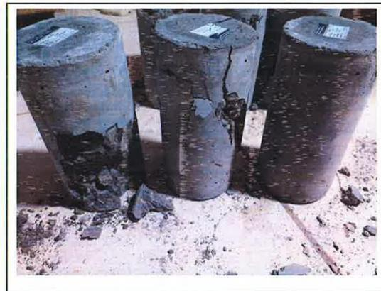
FOTO. 02.- ENSAYO DE ROTURA DE PROBETA - "INFLUENCIA DEL POLVO DE VIDRIO EN LAS PROPIEDADES DEL CONCRETO EN ESTADO FRESCO Y ENDURECIDO"
