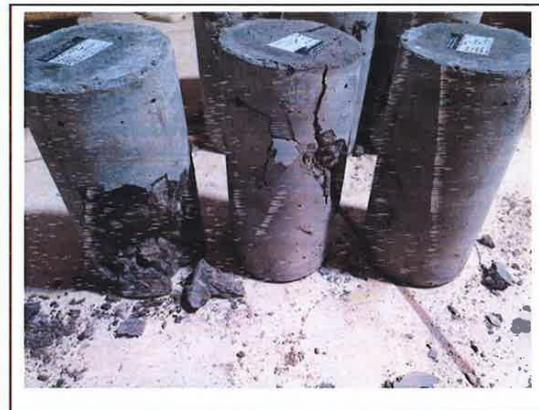
FOTO. 12.- ENSAYO DE ROTURA DE PROBETA - "INFLUENCIA DEL POLVO DE VIDRIO EN LAS PROPIEDADES DEL CONCRETO EN ESTADO FRESCO Y ENDURECIDO"
