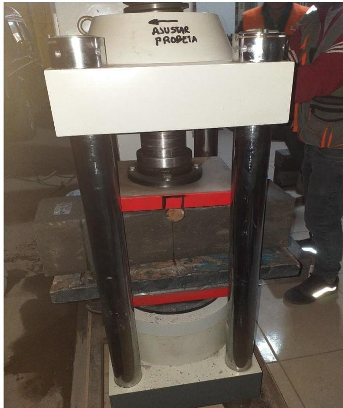
Fotografía 14. Vigas simples de concreto con polvo de vidrio añadidos ensayadas a flexión para 21 días de edad.
