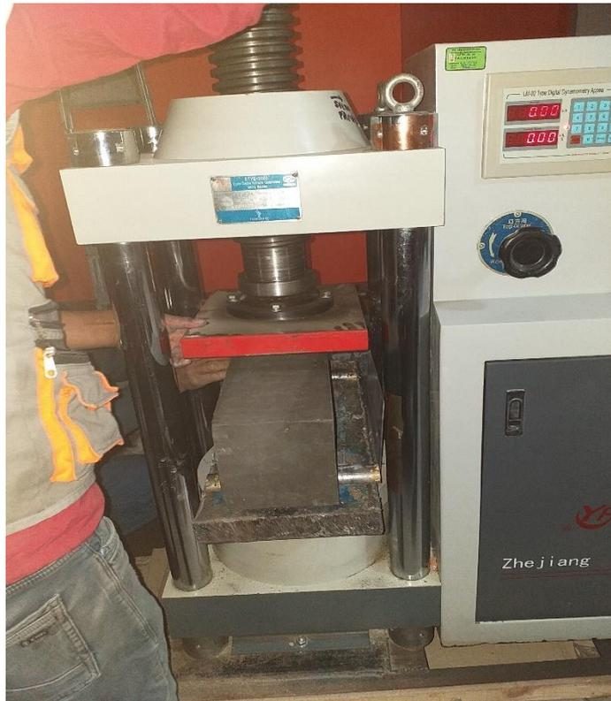
Fotografía 13. Vigas simples de concreto con polvo de vidrio añadidos ensayadas a flexión para 14 días de edad.
