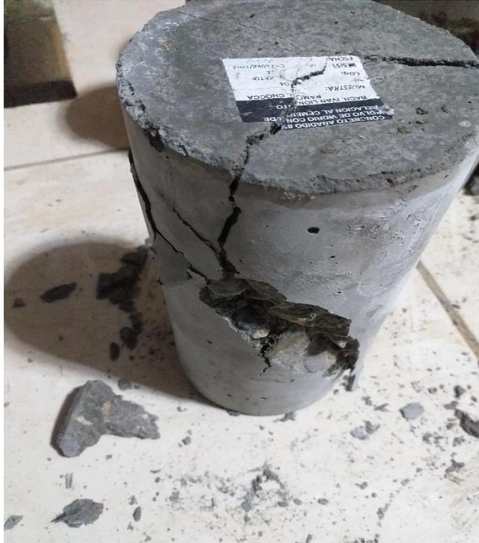
Fotografía 17. Probetas de concreto con polvo de vidrio añadido en relación al cemento roturadas en el ensayo a compresión simple a los 14 días.
