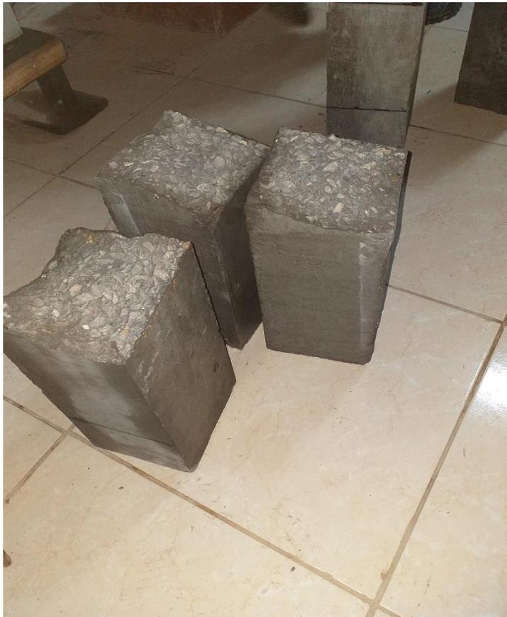
Fotografía 20. Vigas simples de concreto convencional roturadas en el ensayo a flexión.
