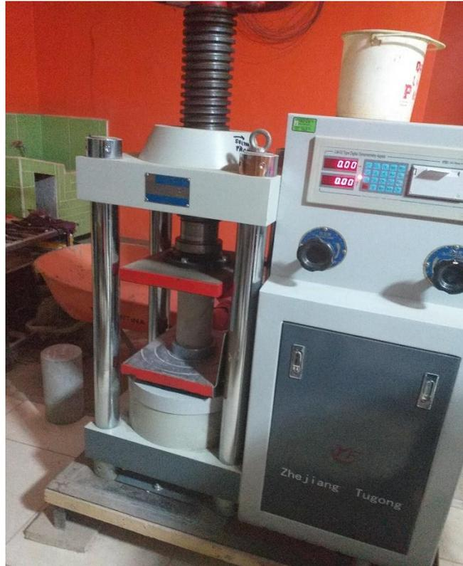
Fotografía 5. Probetas de concreto convencional ensayadas a compresión simple para 21 días de edad.
