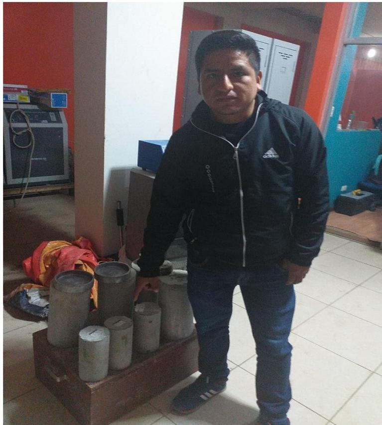
Fotografía 2. Probetas de concreto convencional que se usó para la rotura.
