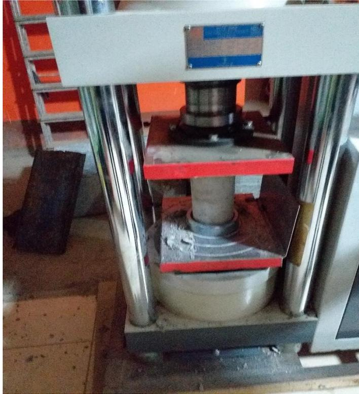
Fotografía 7. Probetas de concreto con polvo de vidrio añadido ensayadas a compresión simple para 14 días de edad.
