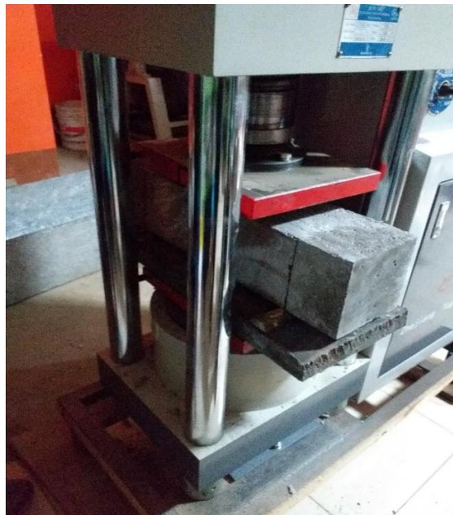
Fotografía 10. Vigas simples de concreto convencional ensayadas a flexión para 14 días de edad.
