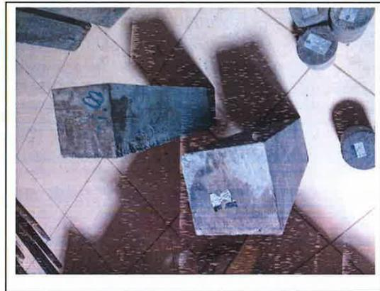
FOTO. 12.- ENSAYO DE ROTURA DE VIGA – "INFLUENCIA DEL POLVO DE VIDRIO EN LAS PROPIEDADES DEL CONCRETO EN ESTADO FRESCO Y ENDURECIDO"
