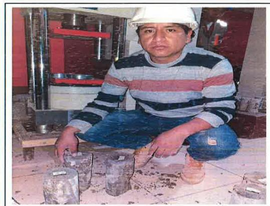
FOTO. 06.- ENSAYO DE ROTURA DE PROBETA - "INFLUENCIA DEL POLVO DE VIDRIO EN LAS PROPIEDADES DEL CONCRETO EN ESTADO FRESCO Y ENDURECIDO"
