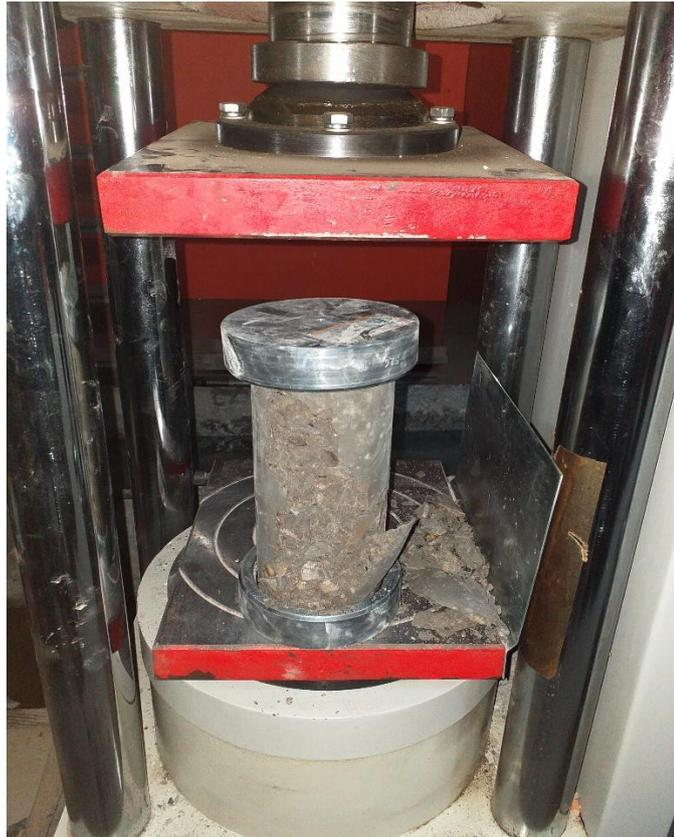
Fotografía 9. Probetas de concreto con polvo de vidrio añadido ensayadas a compresión simple para 28 días de edad.
