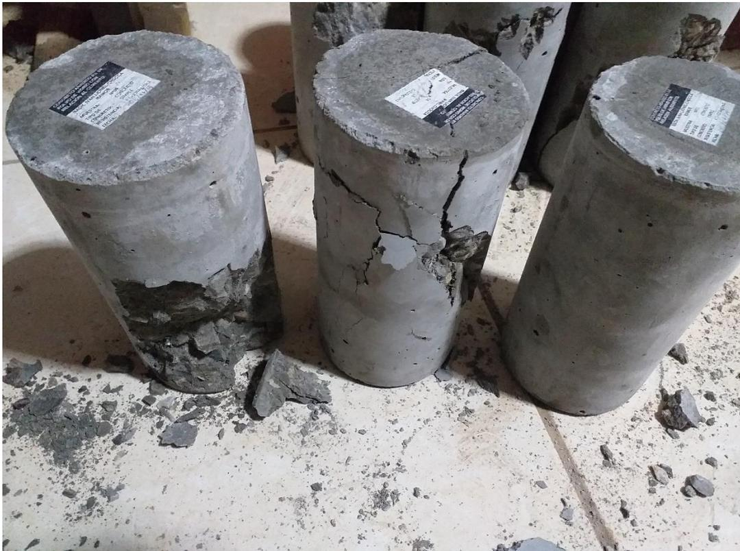
Fotografía 18. Probetas de concreto con polvo de vidrio añadido en relación al cemento roturadas en el ensayo a compresión simple a los 21 días.
