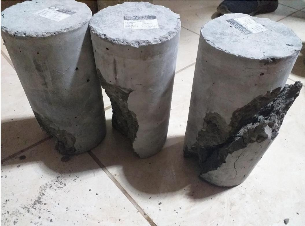
Fotografía 19. Probetas de concreto con polvo de vidrio añadido en relación al cemento roturadas en el ensayo a compresión simple a los 28 días.
