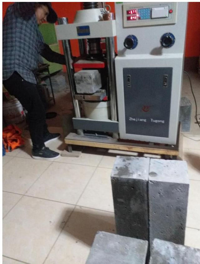
Fotografía 12. Vigas simples de concreto convencional ensayadas a flexión para 28 días de edad.
