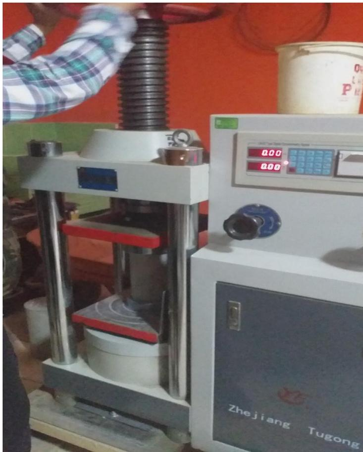
Fotografía 4. Probetas de concreto convencional ensayadas a compresión simple para 14 días de edad.
