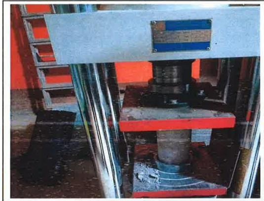
FOTO. 07.- ENSAYO DE ROTURA DE PROBETA - "INFLUENCIA DEL POLVO DE VIDRIO EN LAS PROPIEDADES DEL CONCRETO EN ESTADO FRESCO Y ENDURECIDO"
