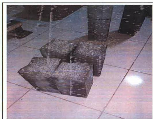
FOTO. 10.- ENSAYO DE ROTURA DE VIGA – "INFLUENCIA DEL POLVO DE VIDRIO EN LAS PROPIEDADES DEL CONCRETO EN ESTADO FRESCO Y ENDURECIDO"
