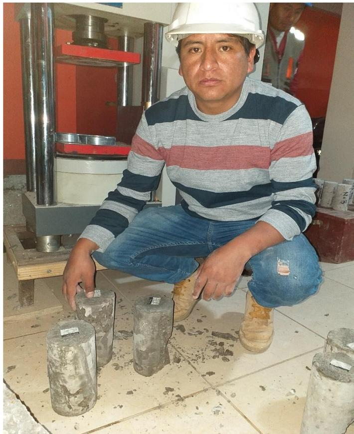
Fotografía 16. Probetas de concreto convencional roturadas en el ensayo a compresión simple.
