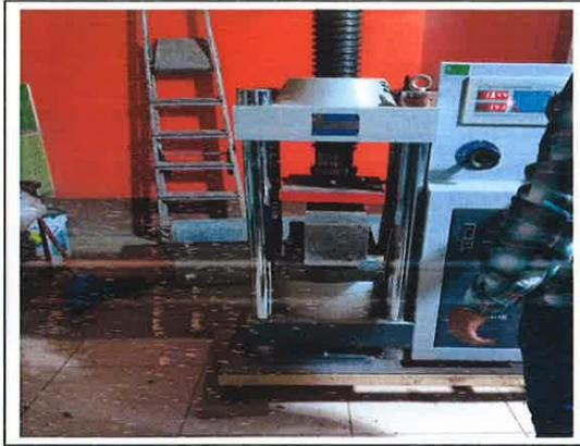
FOTO. 11.- ENSAYO DE ROTURA DE VIGA – "INFLUENCIA DEL POLVO DE VIDRIO EN LAS PROPIEDADES DEL CONCRETO EN ESTADO FRESCO Y ENDURECIDO"
