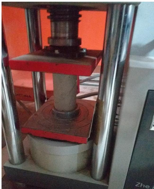
Fotografía 6. Probetas de concreto convencional ensayadas a compresión simple para 28 días de edad.
