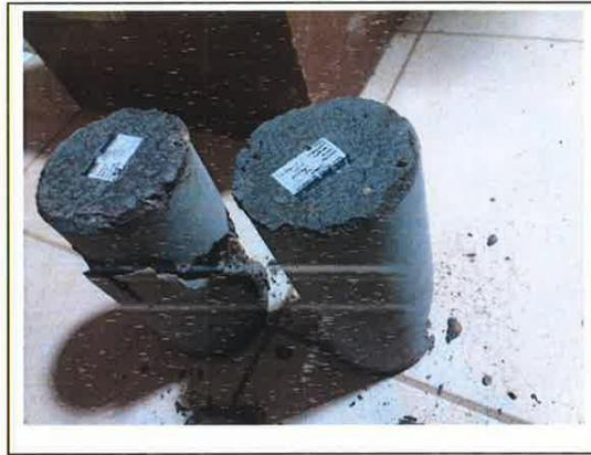
FOTO. 09.- ENSAYO DE ROTURA DE PROBETA - "INFLUENCIA DEL POLVO DE VIDRIO EN LAS PROPIEDADES DEL CONCRETO EN ESTADO FRESCO Y ENDURECIDO"
