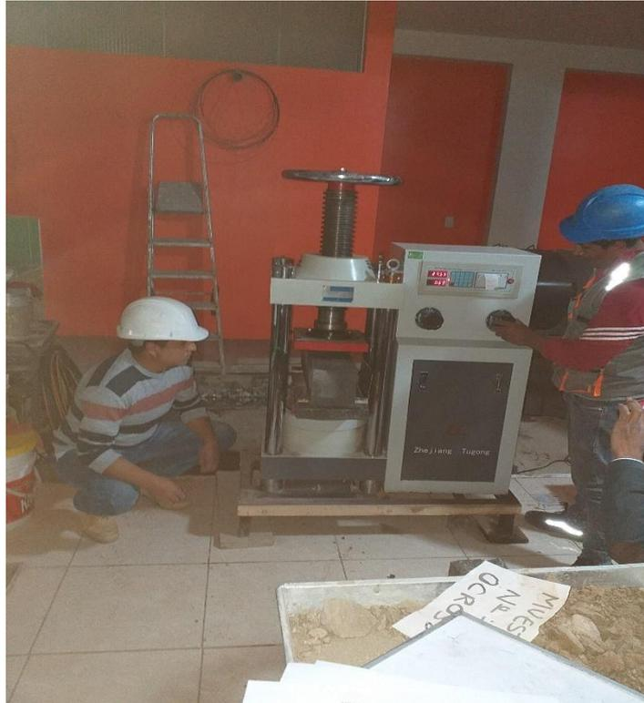
Fotografía 15. Vigas simples de concreto con polvo de vidrio añadido ensayadas a flexión para 28 días de edad.
