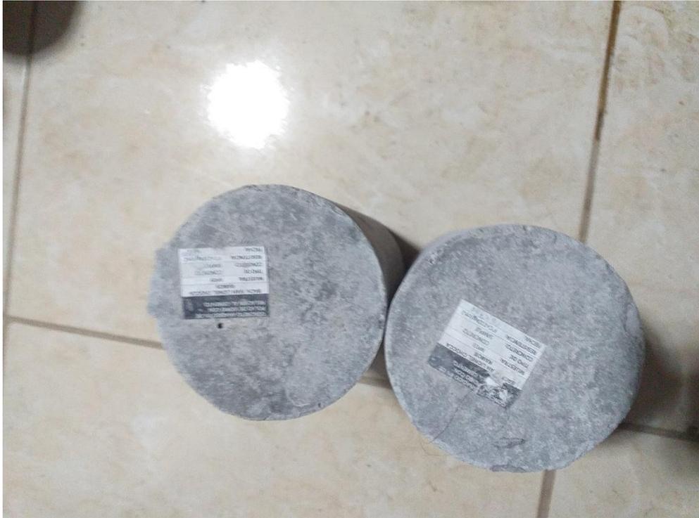
Fotografía 3. Probetas de concreto con polvo de vidrio añadido que se usó para la rotura.
