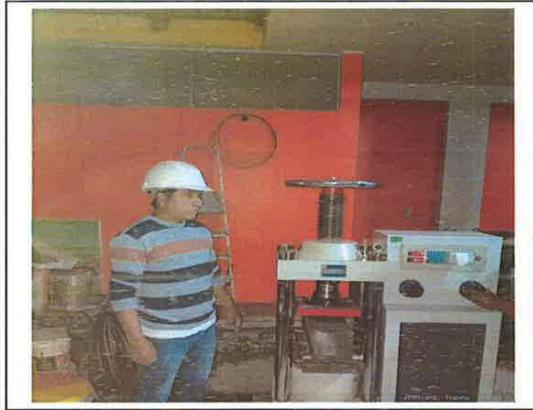
FOTO. 01.- ENSAYO DE ROTURA DE PROBETA – "INFLUENCIA DEL POLVO DE VIDRIO EN LAS PROPIEDADES DEL CONCRETO EN ESTADO FRESCO Y ENDURECIDO"
