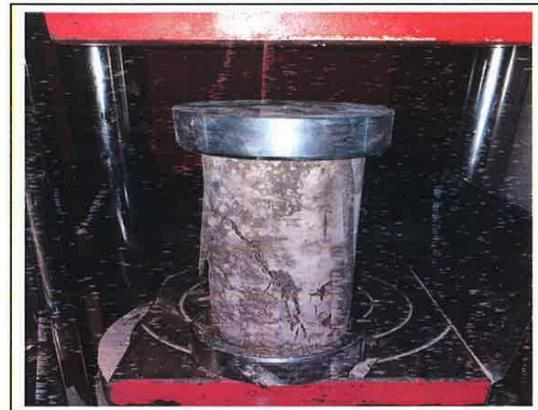
FOTO. 08.- ENSAYO DE ROTURA DE PROBETA - "INFLUENCIA DEL POLVO DE VIDRIO EN LAS PROPIEDADES DEL CONCRETO EN ESTADO FRESCO Y ENDURECIDO"
