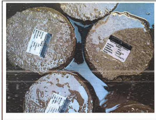
FOTO. 05.- ENSAYO DE ROTURA DE PROBETA - "INFLUENCIA DEL POLVO DE VIDRIO EN LAS PROPIEDADES DEL CONCRETO EN ESTADO FRESCO Y ENDURECIDO"
