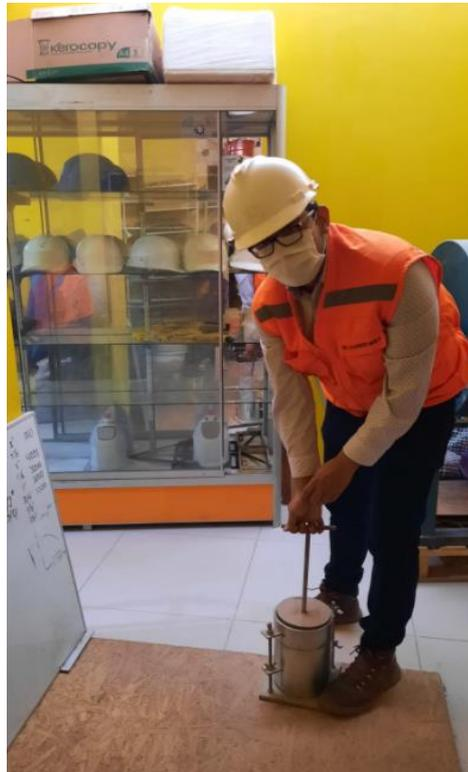
**Figura 08.** Ensayo de proctor modificado
