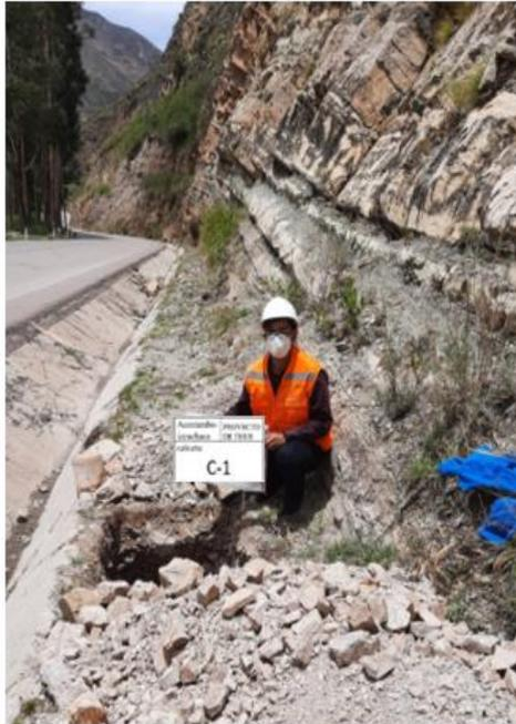
**Figura 05.** Excavación de la calicata 01 km 0+22
