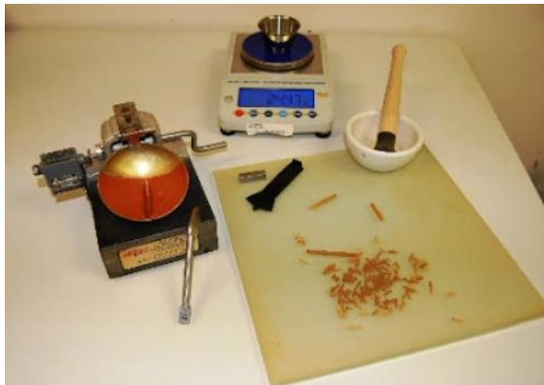
**Figura 07.** Equipos utilizados para el ensayo de límites de consistencia.
