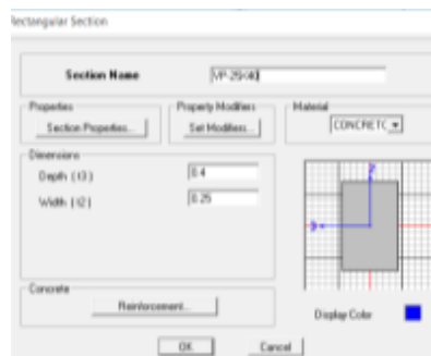
Figura 54 Definiendo la viga VP segundo modelo Fuente: Elaboración propia.
