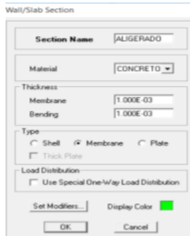
Figura 32 Definición del aligerado Fuente: Elaboración propia.
