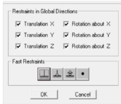
Figura 44 Apoyos fijos en la base Fuente: Elaboración propia.
