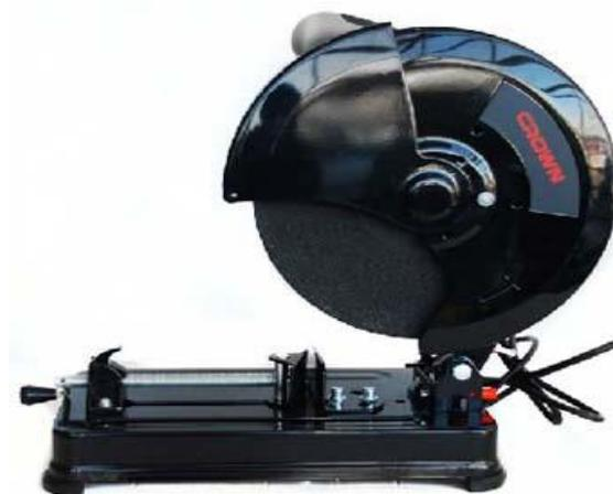
*Figura 1.* Tronzadora con disco abrasivo.
