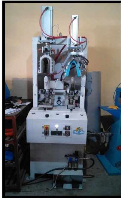
FIGURA 45: Selladora der talón en frio y caliente.
