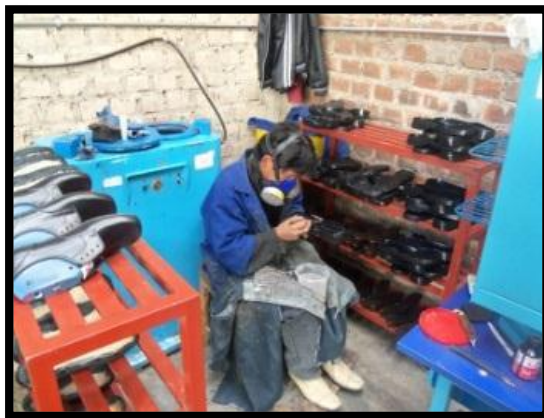
FIGURA 12: Pegado de la planta.
