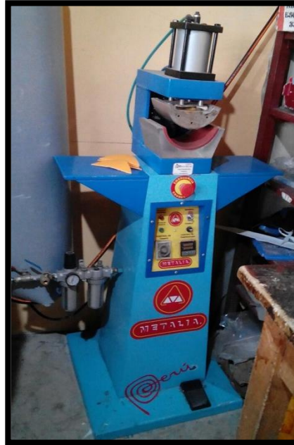
FIGURA 42: Selladora de puntera.
