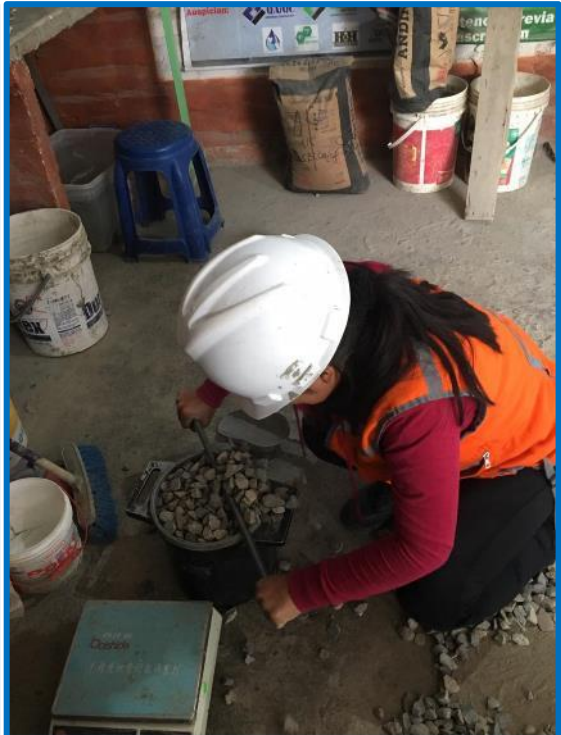
Collage fotográfico 03: Proceso de ensayo de Peso Unitario Compactado del agregado grueso.
