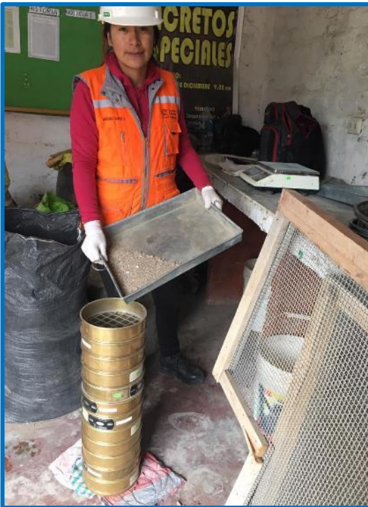
Collage fotográfico 05: Proceso de ensayo de granulometría del agregado fino (cantera intersección Orcotuna – Sicaya).
