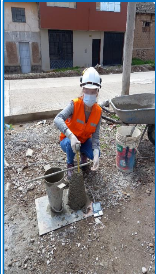
Collage fotográfico 08: Proceso de ensayo de asentamiento del concreto.
