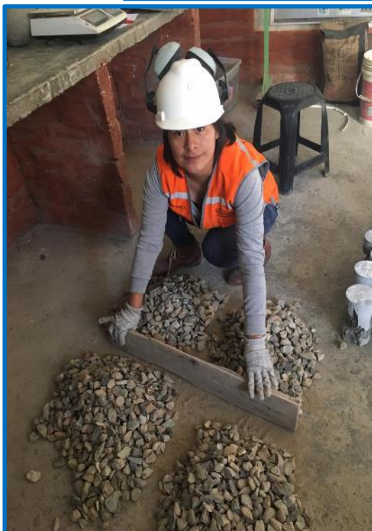
Collage fotográfico 02: Proceso de cuarteo del agregado grueso cantera intersección río Mantaro – río Cunas).
