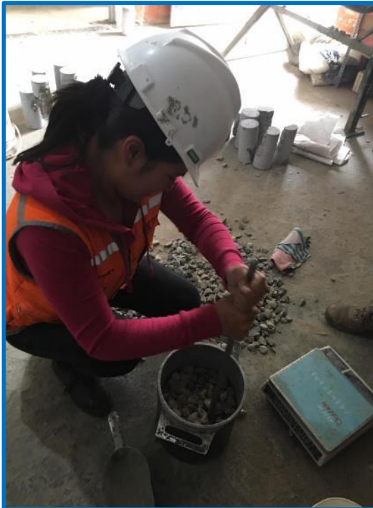
Collage fotográfico 03: Proceso de ensayo de Peso Unitario Compactado del agregado grueso.
