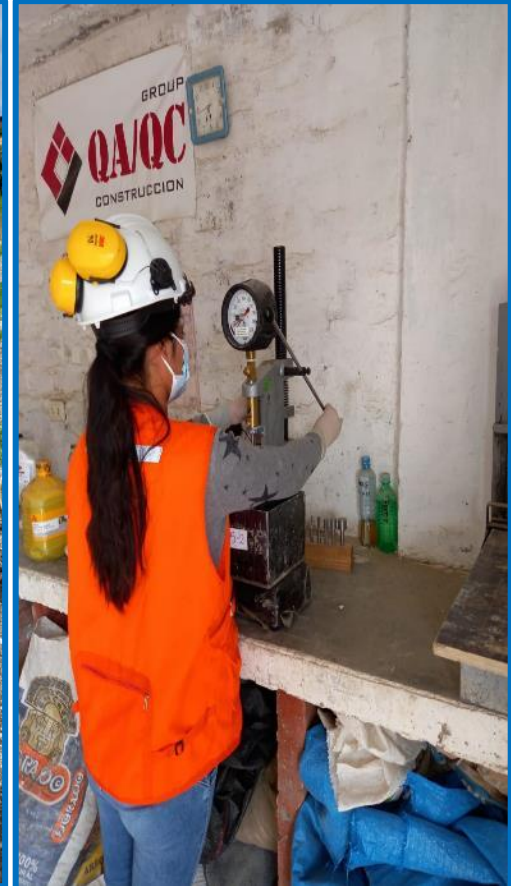
Collage fotográfico 07: Proceso de ensayo de tiempo de fragua del concreto.
