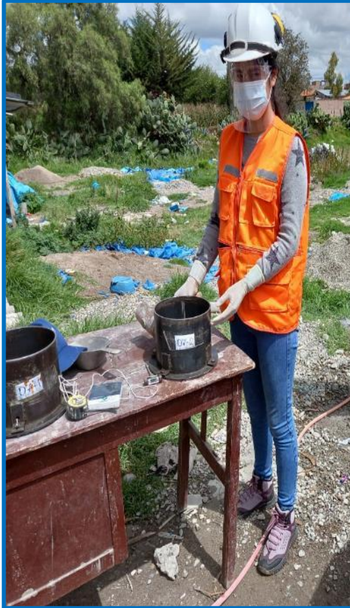
Collage fotográfico 07: Proceso de ensayo de tiempo de fragua del concreto.
