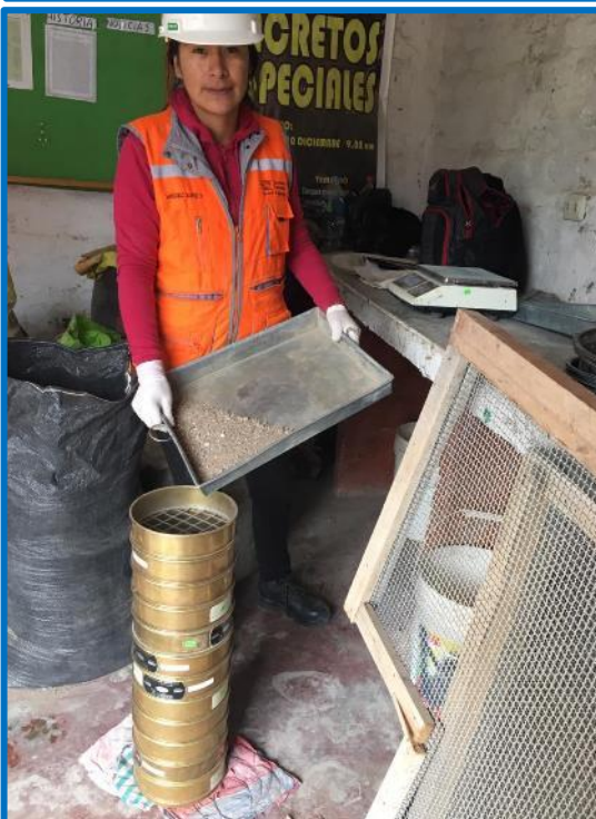
Collage fotográfico 04: Proceso de ensayo de granulometría del agregado fino (cantera intersección Orcotuna – Sicaya).
