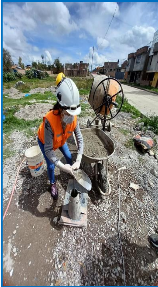
Collage fotográfico 08: Proceso de ensayo de asentamiento del concreto.
