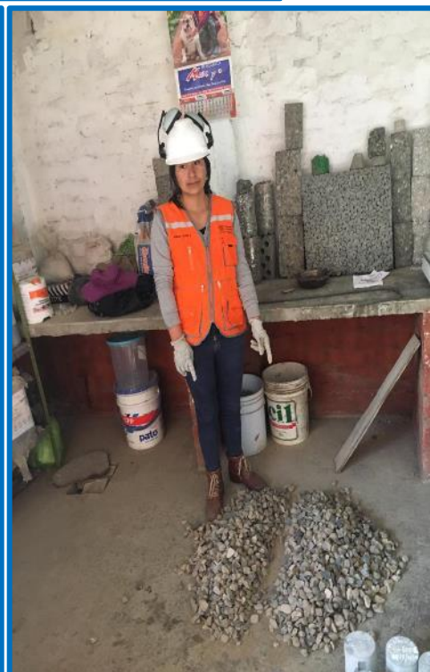
Collage fotográfico 02: Proceso de cuarteo del agregado grueso cantera intersección río Mantaro – río Cunas).
