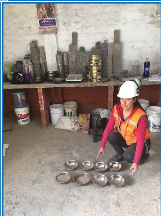
Collage fotográfico 04: Proceso de ensayo de granulometría del agregado fino (cantera intersección Orcotuna – Sicaya).
