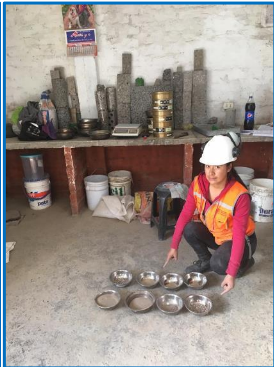
Collage fotográfico 05: Proceso de ensayo de granulometría del agregado fino (cantera intersección Orcotuna – Sicaya).
