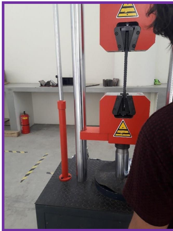
FOTON°4: REALIZANDO EL ENSAYO DE TRACCIÓN EN EL LABORATORIO DE ESTRUCTURAS DE LA UPLA
