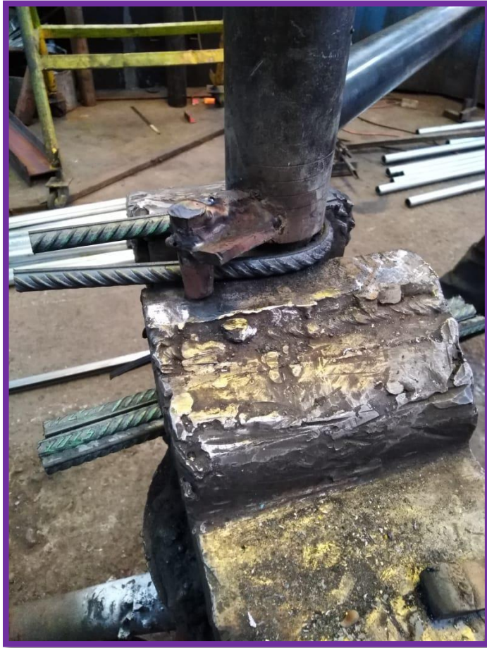
FOTON°5: REALIZANDO EL ENSAYO DE DOBLADO CON MAQUINA DOBLADORA DE ESTRIBOS
