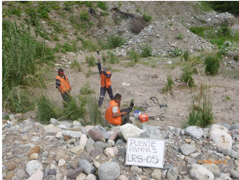
Fotografía 10: Se puede observar los instantes previos al impacto correspondiente al Shot 03 de la línea LRS-05 empleado para la generación de las ondas sísmicas.
