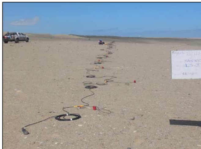
Figura 3.3. Trazo de la línea de inspección en la que se ponen marcas para ubicar c/u de los geófonos y la fuente de energía (Fuente Propia, 10/10/16)
