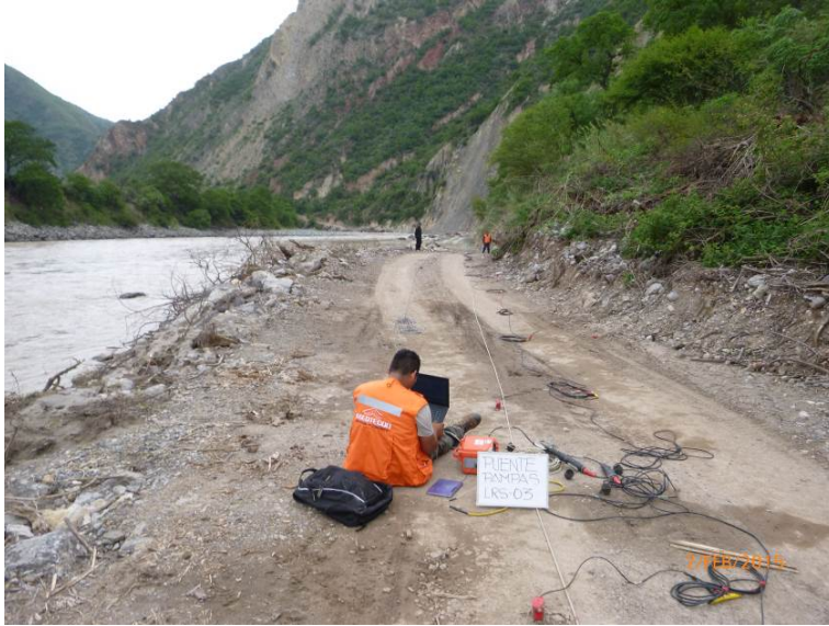
Fotografía 05: Zona de trabajo de la Línea LRS-03 Se puede apreciar el tendido de los cables.
