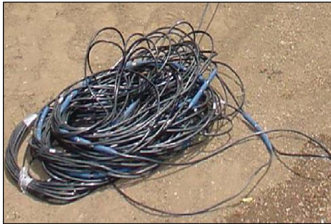
Figura 2.2. Cable de conexión de geófonos – Equipos de la Empresa Ingeotecon E.I.R.L.
