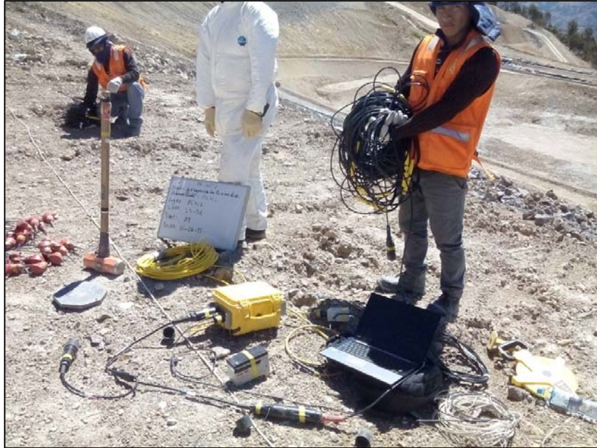
Figura 2.6. Sistema de disparo: interruptor de martillo (izquierda) y cable de extensión del trigger (derecha) – Equipos de la Empresa INGEOTECON E.I.R.L.
