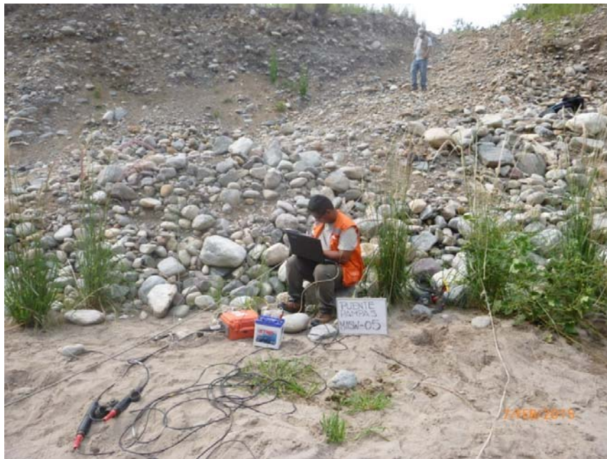
Fotografía 010: Momento previo al impacto correspondiente al Shot 03 empleado para la generación de las ondas sísmicas. Sondaje MASW-05. Se puede apreciar el tendido de los cables.
