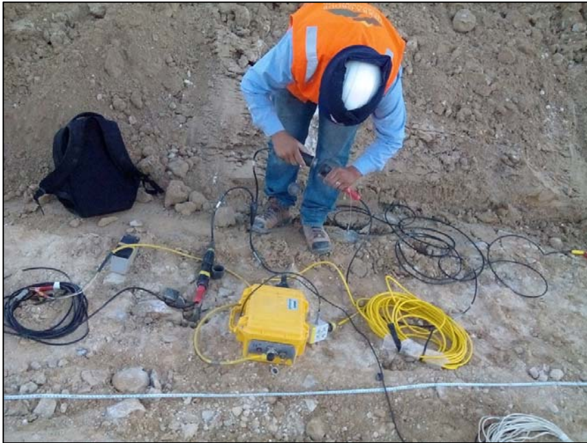
Figura 2.3. Sismógrafo Modelo GEODE de 24 canales (Geometrics, 2001)
