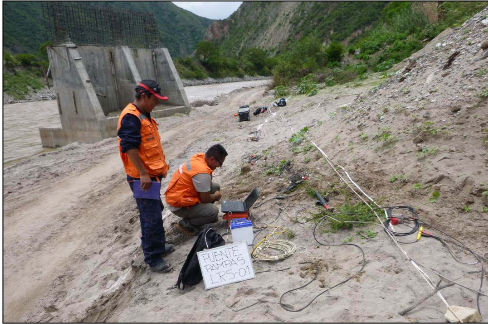
Fotografía N° 04: Disposición del tendido de la línea de refracción sísmica LRS-01, ejecutada en el Estribo Izquierdo del Puente Vehicular Interregional Pampas.
