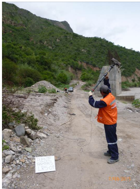
Fotografía 02: Se puede observar los instantes previos al impacto correspondiente al Shot 03 de la línea LRS-01 empleado para la generación de las ondas sísmicas.
