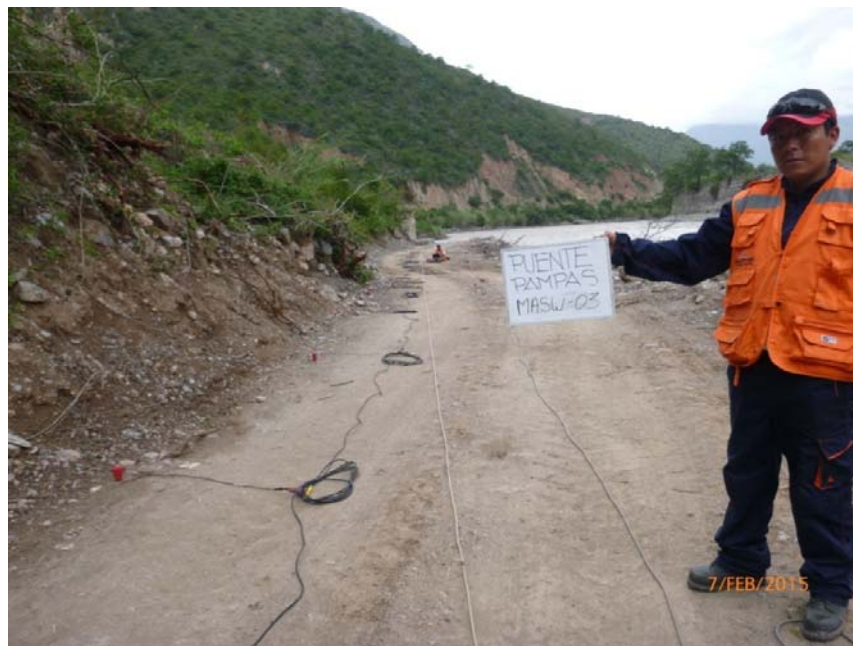
Fotografía 06: Momento previo al impacto correspondiente al Shot 03 empleado para la generación de las ondas sísmicas. Sondaje MASW-03. Se puede apreciar el tendido de los cables.
