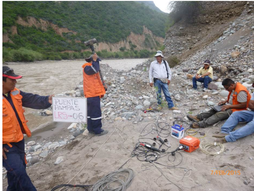
Fotografía 12: Se puede observar los instantes previos al impacto correspondiente al Shot 03 de la línea LRS-06 empleado para la generación de las ondas sísmica
