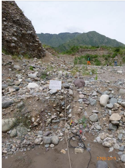
Fotografía 07: Vista panorámica de la línea de refracción sísmica LRS-04. Se puede apreciar el tendido de los cables.
