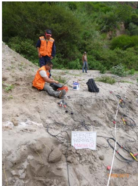
Fotografía 04: Área de trabajo del Sondaje MASW-02. Puede apreciarse el tendido de cables y la colocación de los sensores sobre el terreno. Además se observa el equipo de toma de datos.
