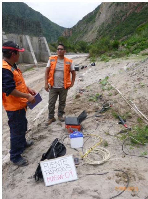
Fotografía 02: Momento previo al impacto correspondiente al Shot 03 empleado para la generación de las ondas sísmicas. Sondaje MASW-01. Se puede apreciar el tendido de los cables.
