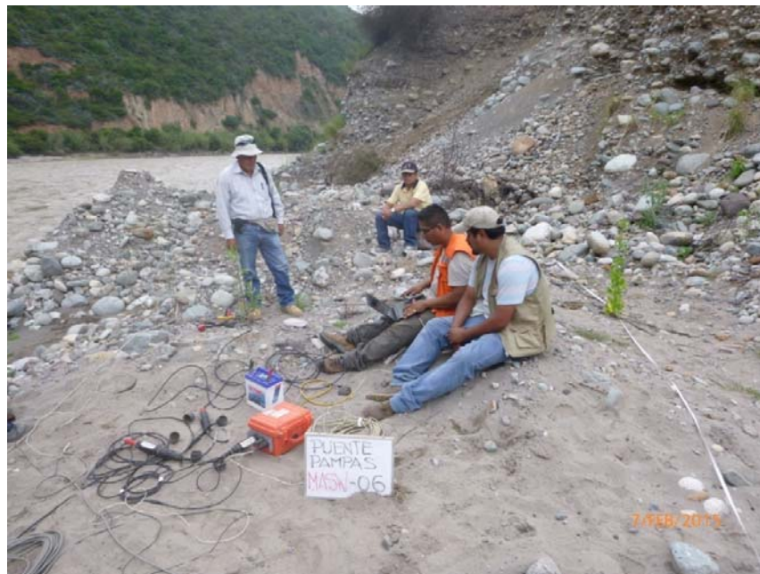
Fotografía 12: Momento previo al impacto correspondiente al Shot 03 empleado para la generación de las ondas sísmicas. Sondaje MASW-06. Se puede apreciar el tendido de los cables.
