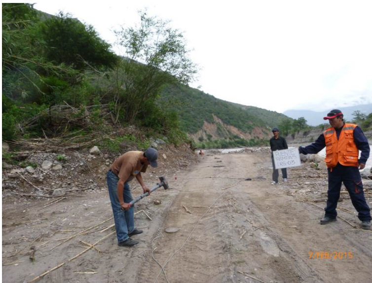
Fotografía 06: Momentos previos al impacto correspondiente al Shot 01 de la línea LRS-03 empleado para la generación de las ondas sísmicas.
