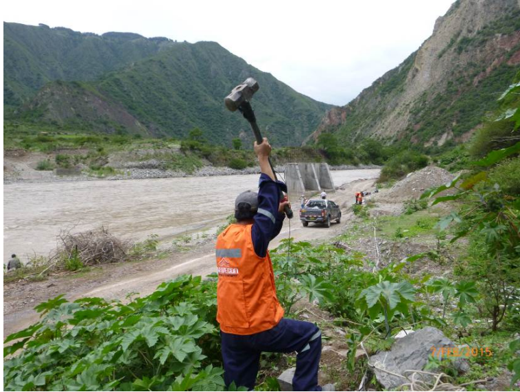
Fotografía 03: Vista panorámica de la línea de refracción sísmica LRS-02. Se puede apreciar los instantes previos al impacto correspondiente al Shot 03 de la línea LRS-02 empleado para la generación de las ondas sísmicas.
