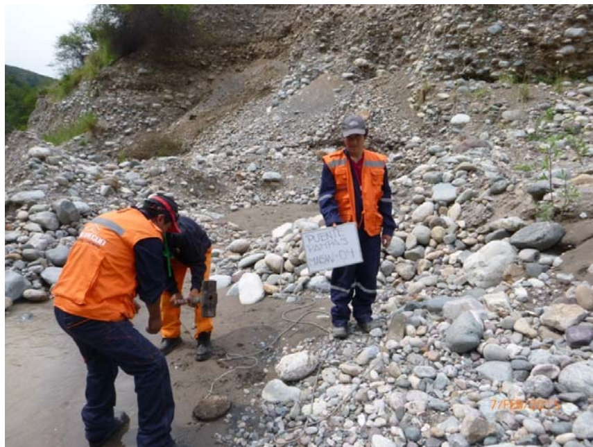
Fotografía 08: Momento previo al impacto correspondiente al Shot 03 empleado para la generación de las ondas sísmicas. Sondaje MASW-04.
