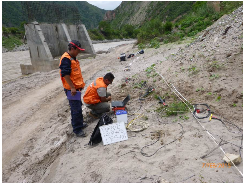
Fotografía 01: Vista panorámica de la línea de refracción sísmica LRS-01. Se puede apreciar el tendido de los cables.
