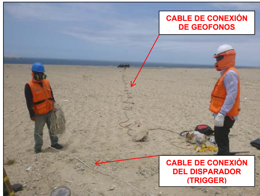
Figura 3.7. Ubicación de cable de conexión de geófonos (izquierda) y del dispositivo disparador o trigger (derecha) – (Fuente Propia – 11/10/16).
