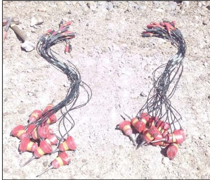
Figura 3.6. Receptores o Geófonos (Geometrics, 2001)
