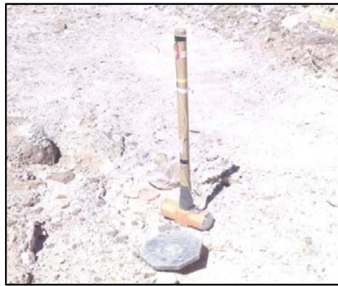
Figura 2.5. Martillo y plato de golpe – Equipos de la Empresa INGEOTECN E.I.R.L.
