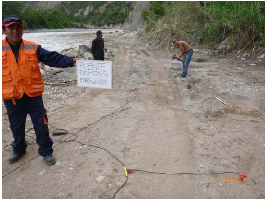
Fotografía 05: Vista panorámica de la línea de refracción sísmica MASW-03. Se puede apreciar el tendido de los cables.
