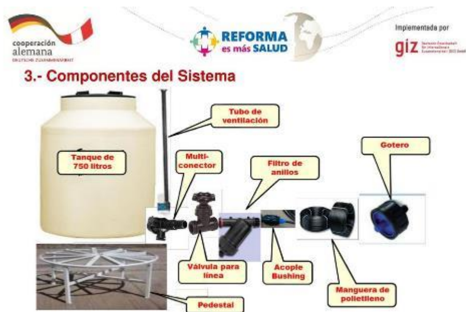
Figura 12 Componentes de un sistema de cloración fuente: http://repositorio.unsm.edu.pe/bitstream/handle//SBR.pdf , virtual página 47
