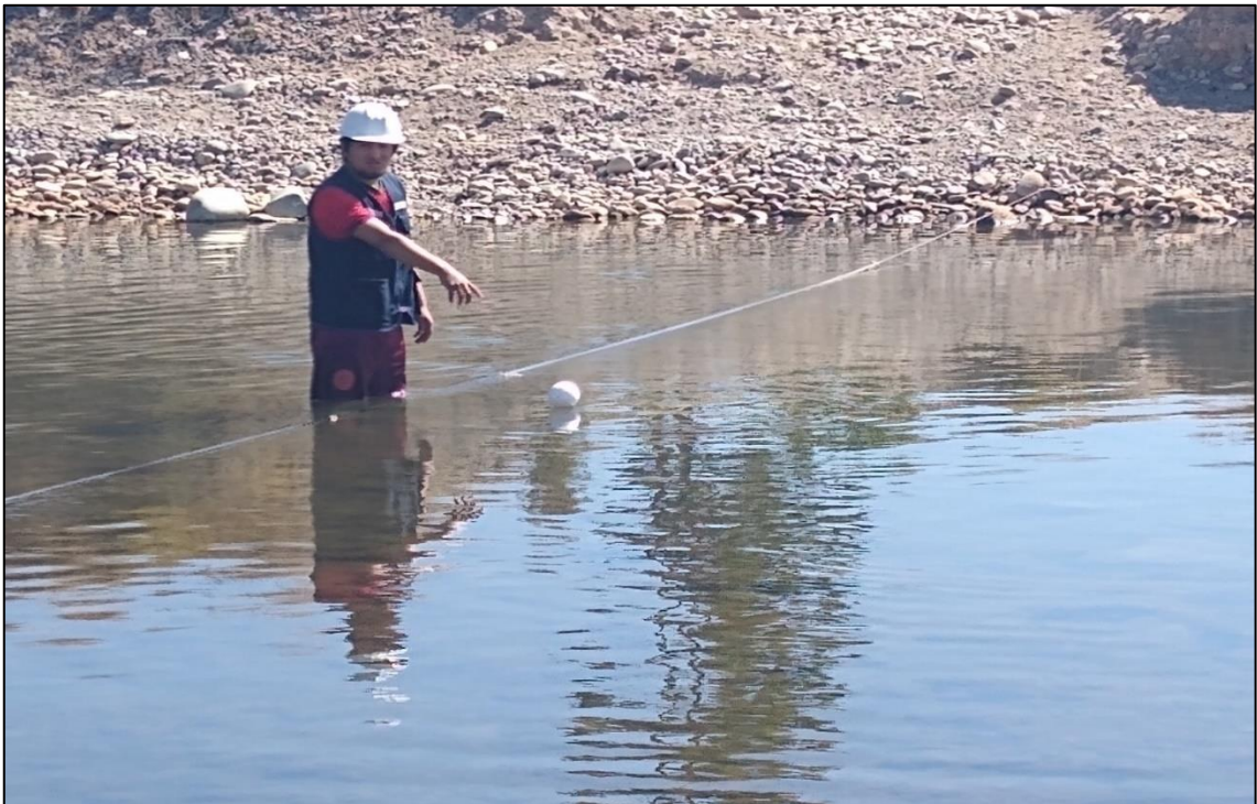
Fotografía 6. Medición de la velocidad del caudal del río Yacus en el punto inicial del tramo.
