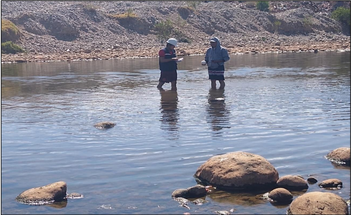
Fotografía 7. Medición de la velocidad del río Yacus en el punto final del tramo.
