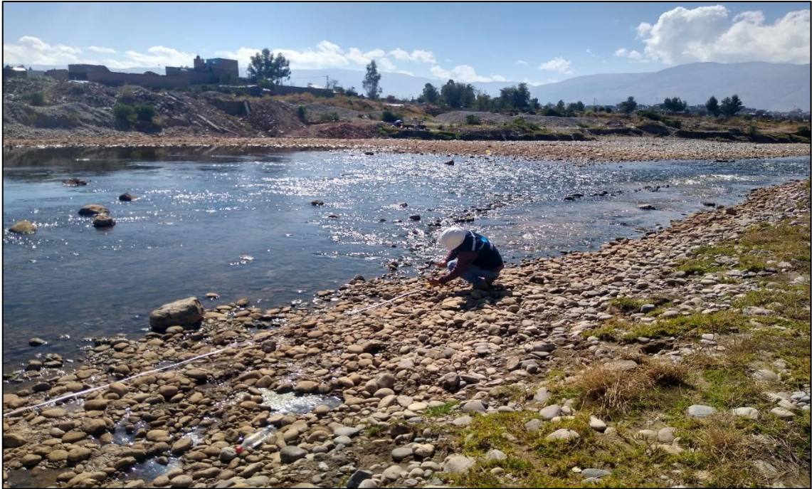
Fotografía 5. Medición de longitud para el cálculo de velocidad del caudal del río Yacus.
