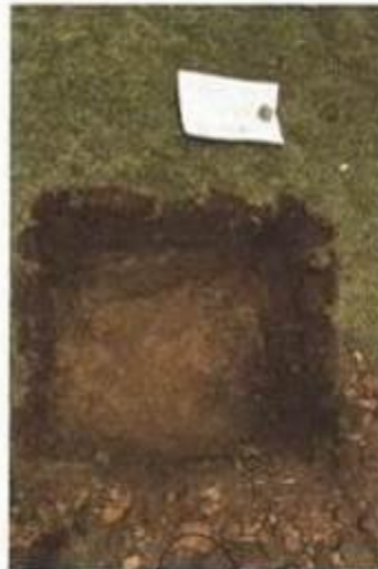
IMAGEN N° 02 – Calicata N°02 en el Reservorio con fines de Cimentación.
