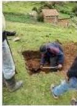
Imagen 2: La calicata Nº1 tiene que ser llenada con un recipiente de capacidad suficiente.
