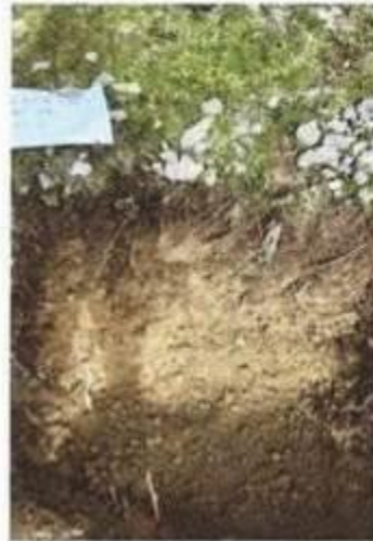
IMAGEN N° 01 – Calicata N°01, en la Línea de Conducción.
