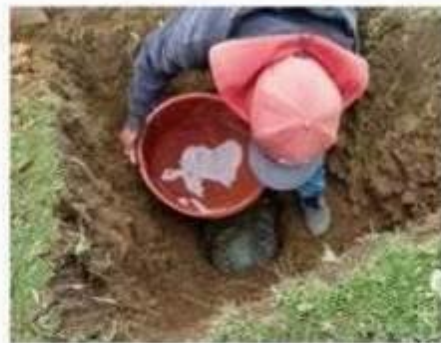
Imagen 2: La calicata Nº1 tiene que ser llenada con un recipiente de capacidad suficiente.
