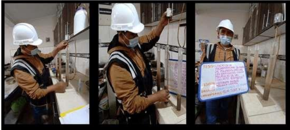
Fotografía 22, Fotografía 23 y Fotografía 24: Se realizó el método de ensayo para el valor equivalente de arena según NTP 339.089
