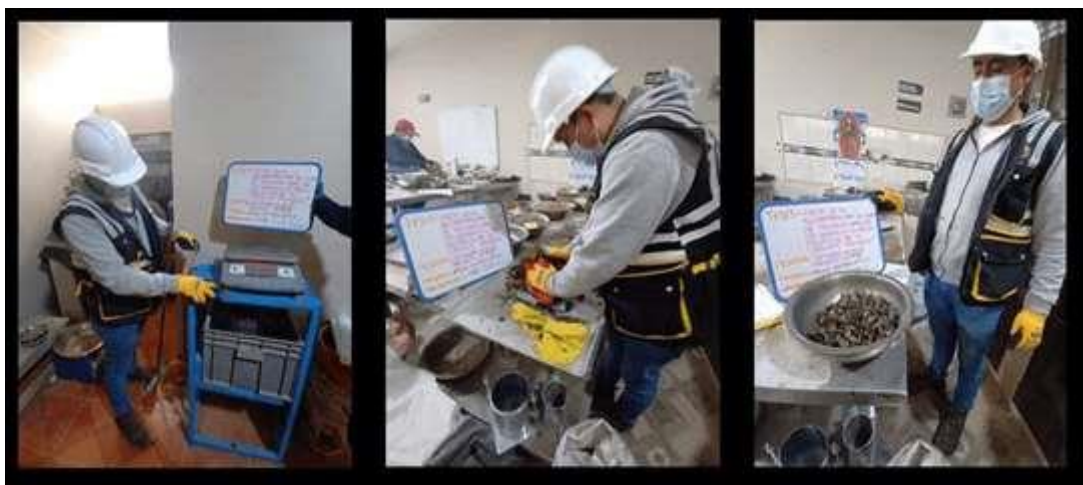
Fotografía 11, Fotografía 12 y Fotografía 13: Se realizó el ensayo para determinar el peso específico del agregado grueso
