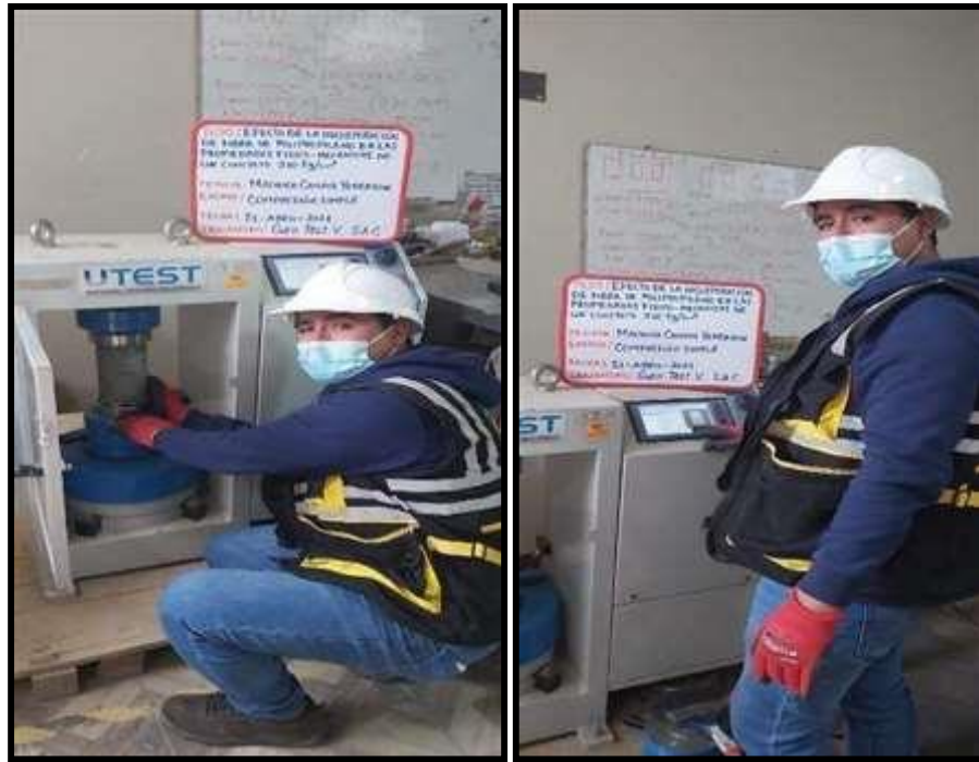
fotografía 63 y fotografía 64: Se acomodo la probeta a los 21 días y se introdujo los datos al equipo de compresión
