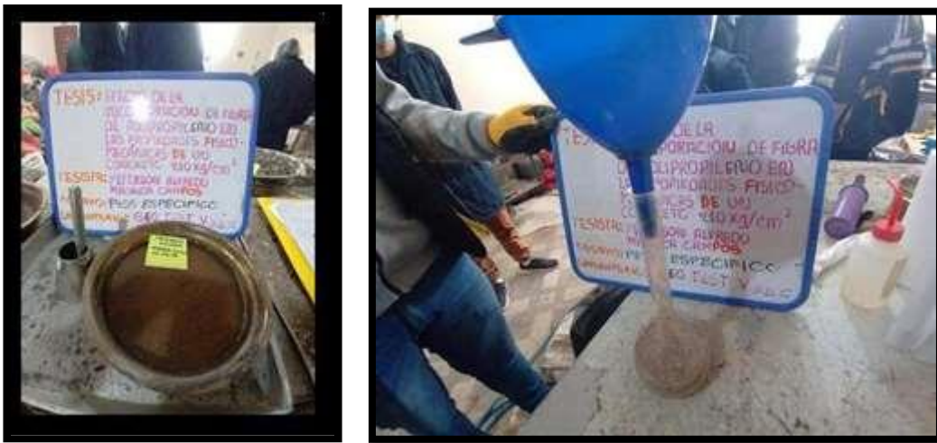
Fotografía 17, Fotografía 18: Se determinó el método de ensayo normalizado para el peso específico y absorción del agregado fino según la NTP 400 022
