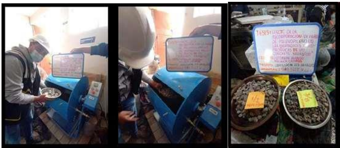
Fotografía 25, Fotografía 26 y Fotografía 27: Este ensayo tiene por objeto determinar la proporción relativa del contenido de polvo fino nocivo, o material arcilloso, en los suelos o agregados finos.
