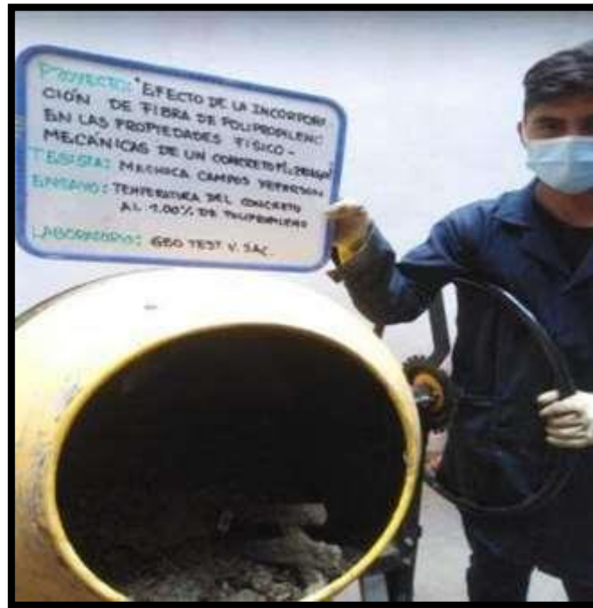
Fotografía 37: Vista de agregados, agua y fibra de polipropileno al 1% para visualizar el efecto de reacción del concreto al adherir este tipo de aditivo
