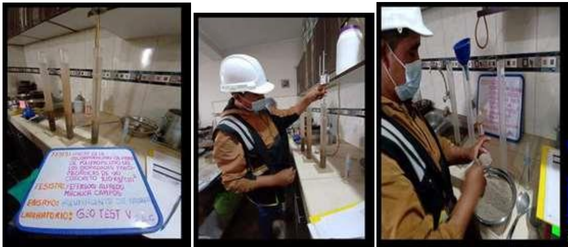
Fotografía 25, Fotografía 26 y Fotografía 27: Este ensayo tiene por objeto determinar la proporción relativa del contenido de polvo fino nocivo, o material arcilloso, en los suelos o agregados finos.
