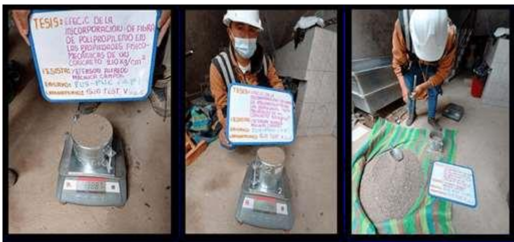
Fotografía 2, Fotografía 3 y Fotografía 4: Realización del ensayo para determinar PUS – PUC del agregado fino según la NTP 400.017.
