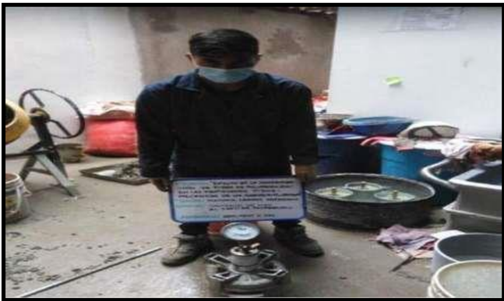
Fotografía 40: Medición del contenido de aire en el concreto patrón mediante el método de presión y la NTP 339.085
