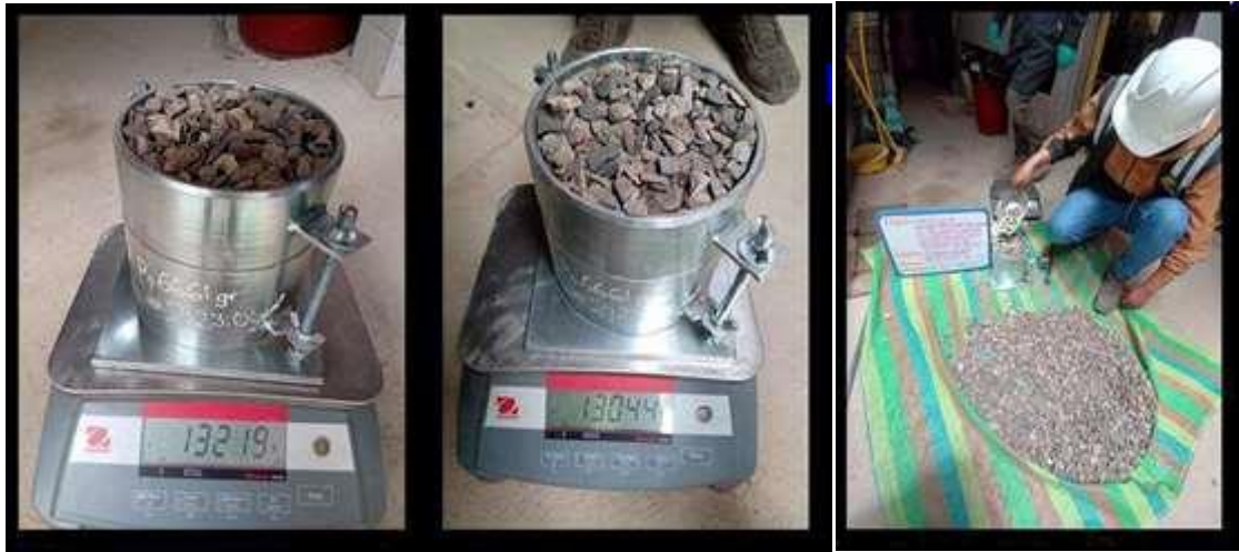
Fotografía 8, Fotografía 9 y Fotografía 10: Ensayo para determinar el PUS – PUC del agregado grueso
