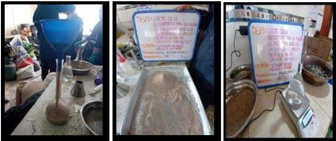
Fotografía 19, Fotografía 20 y Fotografía 21: Realización del ensayo peso específico y absorción del agregado fino
