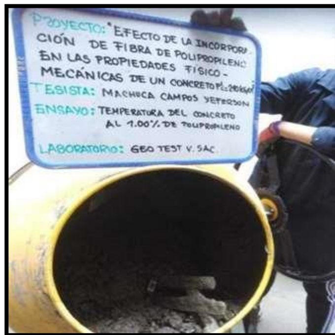
Fotografía 37: Vista de agregados, agua y fibra de polipropileno al 1% para visualizar el efecto de reacción del concreto al adherir este tipo de aditivo
