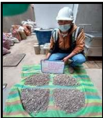
Fotografía 1: Ensayo de granulometría del agregado fino y grueso de acuerdo a la NTP 400.012
