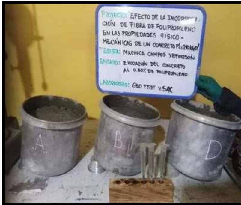
Fotografía 41: Ensayo de exudación del concreto realizado y la fibra de polipropileno al 0.50% para la determinación correspondiente
