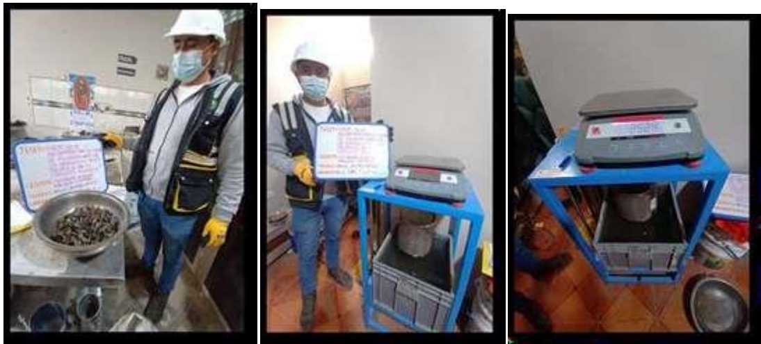
Fotografía 11, Fotografía 12 y Fotografía 13: Se realizó el ensayo para determinar el peso específico del agregado grueso
