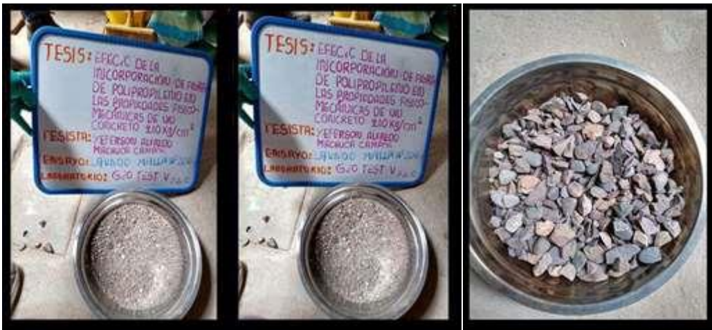
Fotografía 34, Fotografía 35 y Fotografía 36: Se realizó el ensayo de los materiales mas finos que pasan por el tamiz N°200 por lavado según la NTP 400.018
