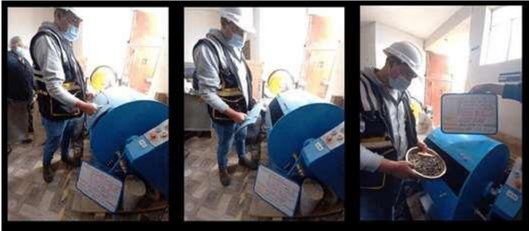
Fotografía 31, Fotografía 32 y Fotografía 33: Este ensayo tiene por objeto determinar la resistencia de agregados, ensayo que es elegido por el método B según la NTP 400.019
