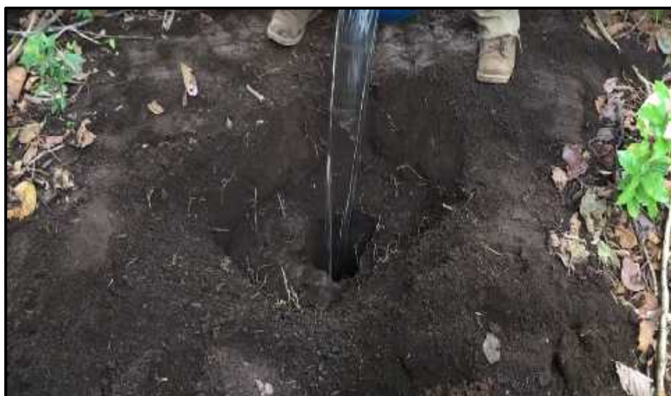
FIGURA A4. Se muestra en la imagen el llenado de agua en el agujero de para La prueba de infiltración.
