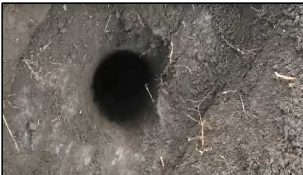
FIGURA A3. Se muestra en la imagen el agujero de 0.30 cm de profundidad y 0.30 cm de diámetro para La prueba de infiltración.
