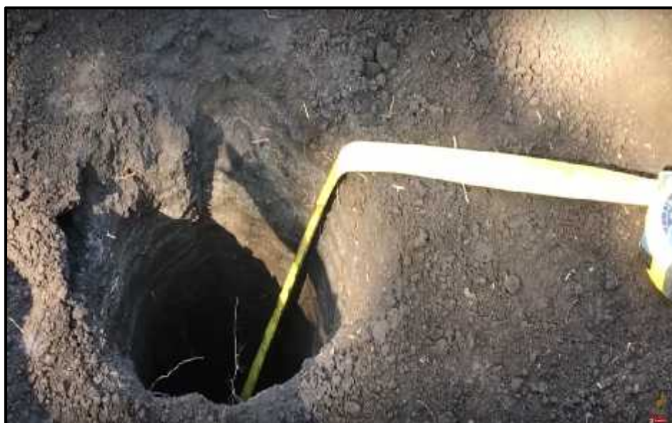
FIGURA A5. Se muestra en la imagen la medida de la profundidad del hoyo para proceder llenar este de agua y realizar la prueba de infiltración.
