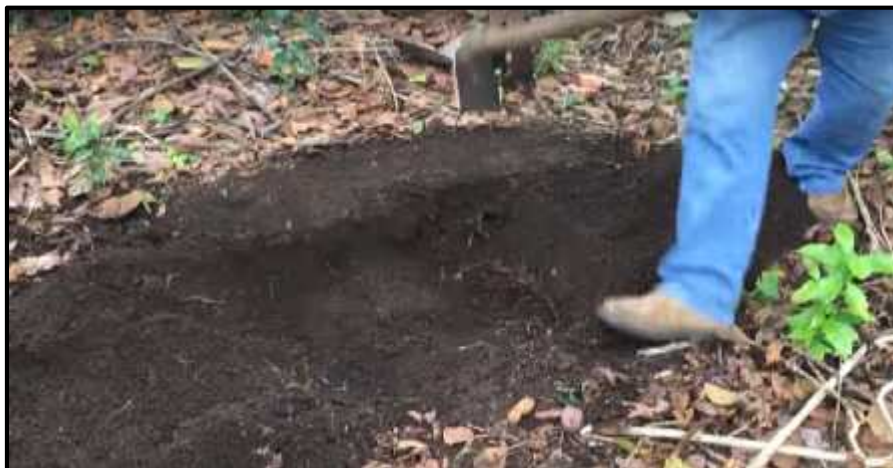
FIGURA A1. Se muestra en la imagen la limpieza y excavación del terreno en un área aproximado de 1 m 2 , para la realización de la prueba de infiltración.
