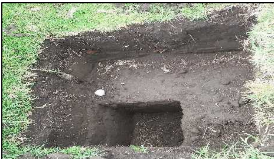
Figura A8. Se muestra en la figura el pozo de percolación excavado listo para realizar las pruebas de test de percolación previamente saturado durante la noche, para obtener datos que simulen y sean compensables aun en tiempos de precipitaciones pluviales.
