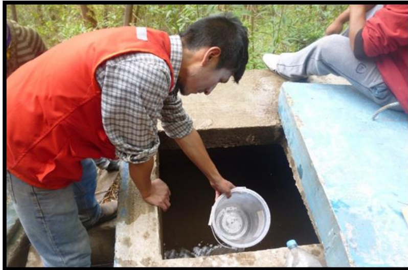
Figura 11. Imagen del aforo de agua con método volumétrico
