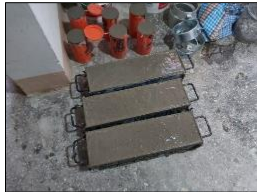
Fotografía 45. Elaboración de probetas y vigas del concreto con sustitución parcial del agregado fino por viruta de acero en 12 %.
