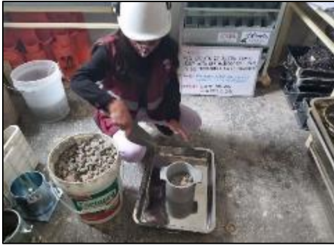
Fotografía 7. Vista de la determinación del peso unitario del agregado grueso y fino.
