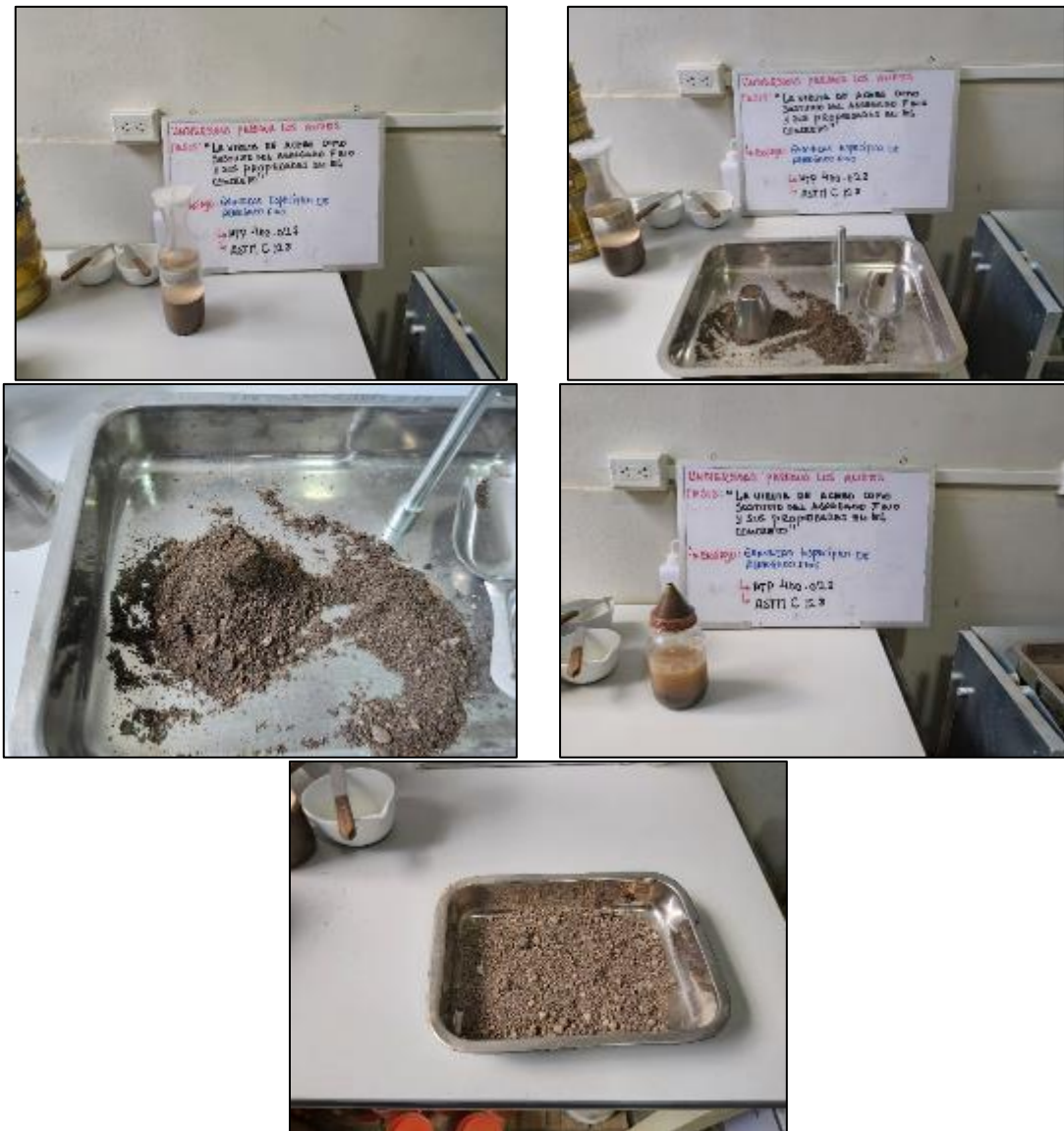
Fotografía 9. Ensayo para determinar la densidad, densidad relativa y absorción de los agregados finos.
