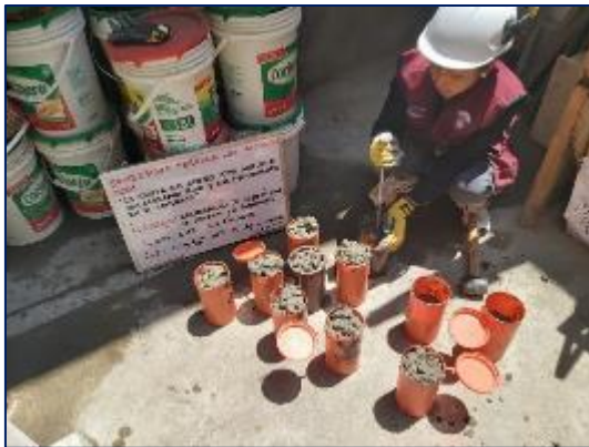
Fotografía 94. Elaboración de probetas y vigas del concreto con sustitución parcial del agregado fino por viruta de acero en 4 %.
