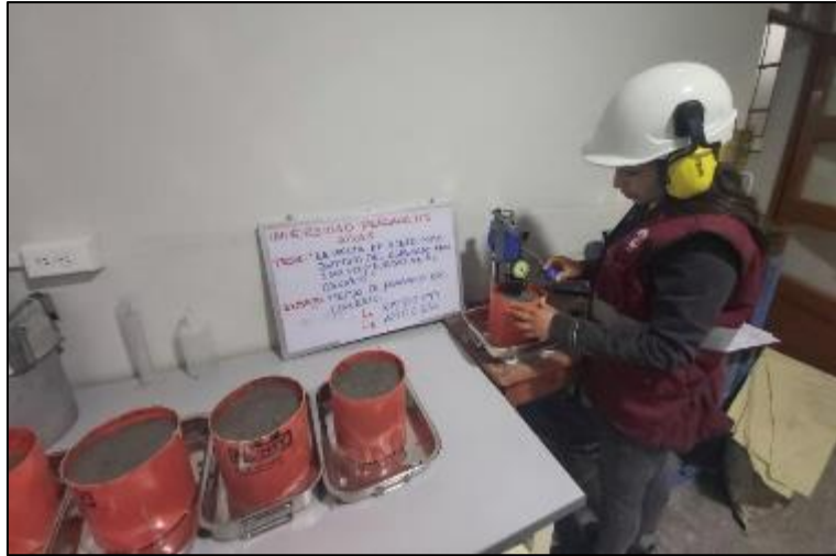
Fotografía 23. Medición del tiempo de fragua del concreto con sustitución parcial del agregado fino por viruta de acero en 4 %.
