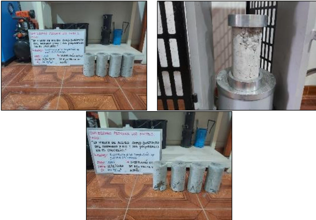
Fotografía 51. Ensayo de resistencia a compresión del concreto con sustitución parcial del agregado fino por viruta de acero en 4 % a los 7 días.
