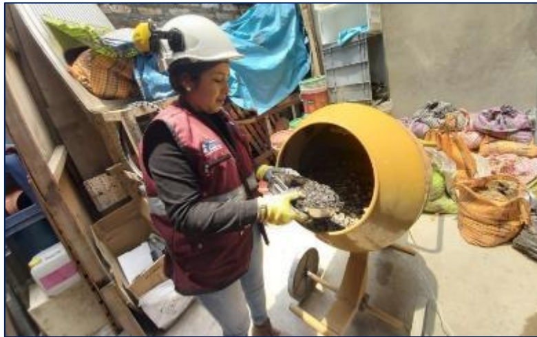
Fotografía 39. Proceso de mezclado del concreto con sustitución parcial del agregado fino por viruta de acero en 12 %.
