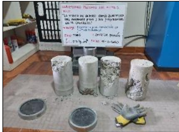
Fotografía 118. Ensayo de resistencia a compresión del concreto patrón a los 7 días.
