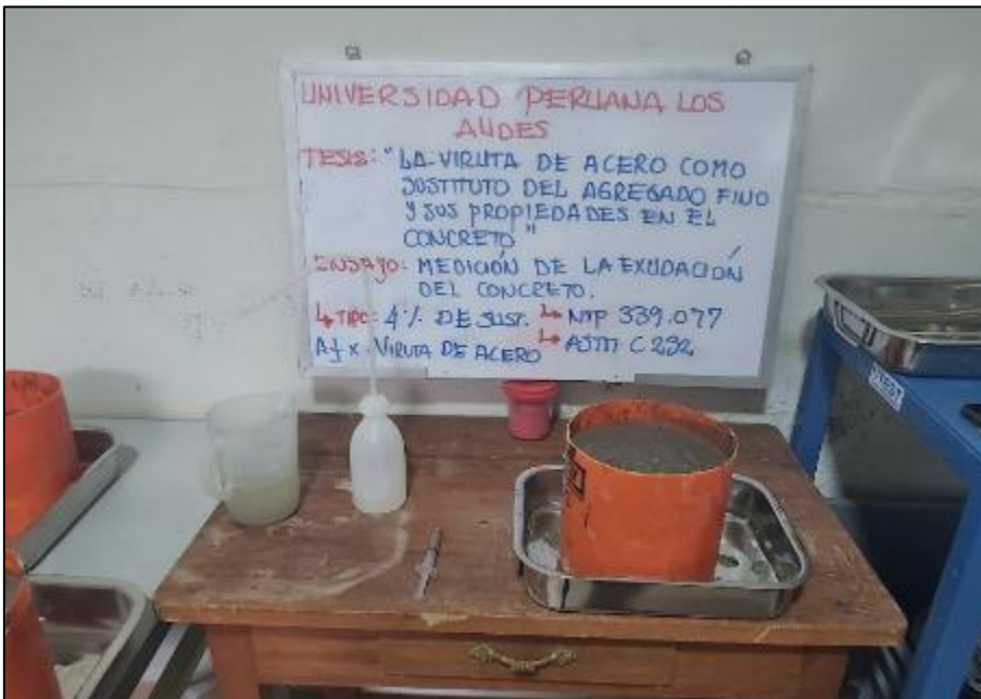
Fotografía 92. Medición de la exudación del concreto con sustitución parcial del agregado fino por viruta de acero en 4 %.
