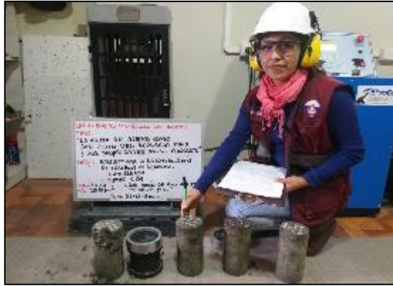
Fotografía 130. Ensayo de resistencia a compresión del concreto con sustitución parcial del agregado fino por viruta de acero en 12 % a los 7 días.
