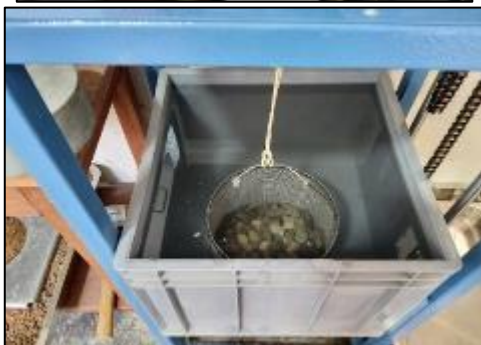
Fotografía 8. Ensayo para determinar la densidad, densidad relativa y absorción de los agregados gruesos.
