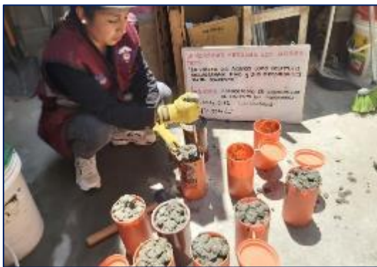
Fotografía 101. Elaboración de probetas y vigas del concreto con sustitución parcial del agregado fino por viruta de acero en 6 %.
