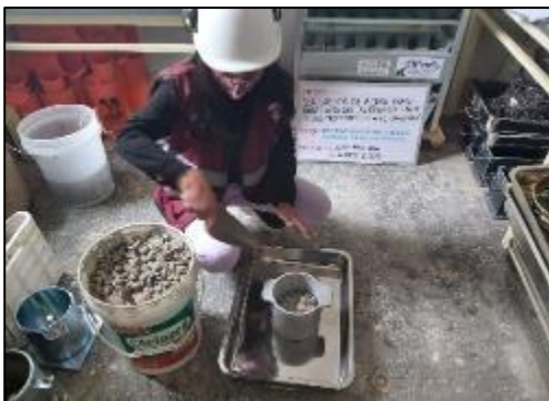
Fotografía 77. Vista de la determinación del peso unitario del agregado grueso y fino.
