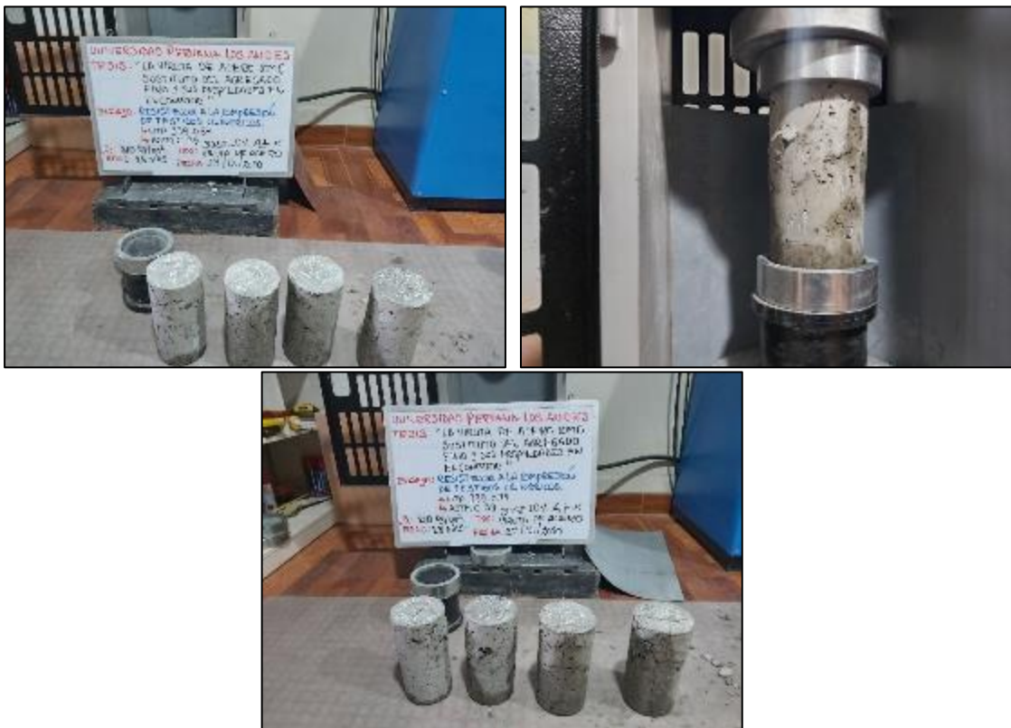
Fotografía 59. Ensayo de resistencia a compresión del concreto con sustitución parcial del agregado fino por viruta de acero en 10 % a los 28 días.
