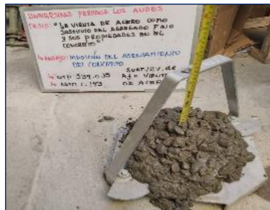
Fotografía 110. Medición del asentamiento del concreto con sustitución parcial del agregado fino por viruta de acero en 12 %.
