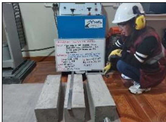
Fotografía 71. Ensayo de resistencia a flexión del concreto con sustitución parcial del agregado fino por viruta de acero en 12 % a los 14 días.
