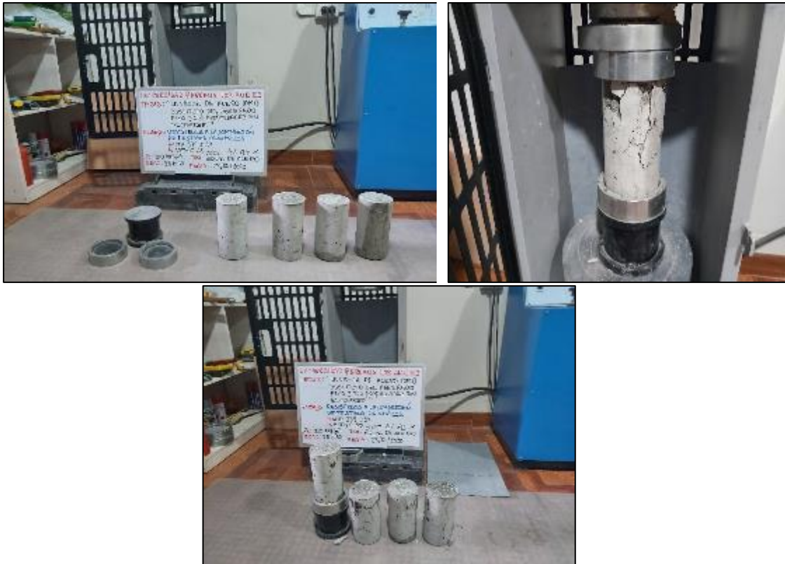
Fotografía 53. Ensayo de resistencia a compresión del concreto con sustitución parcial del agregado fino por viruta de acero en 4 % a los 28 días.
