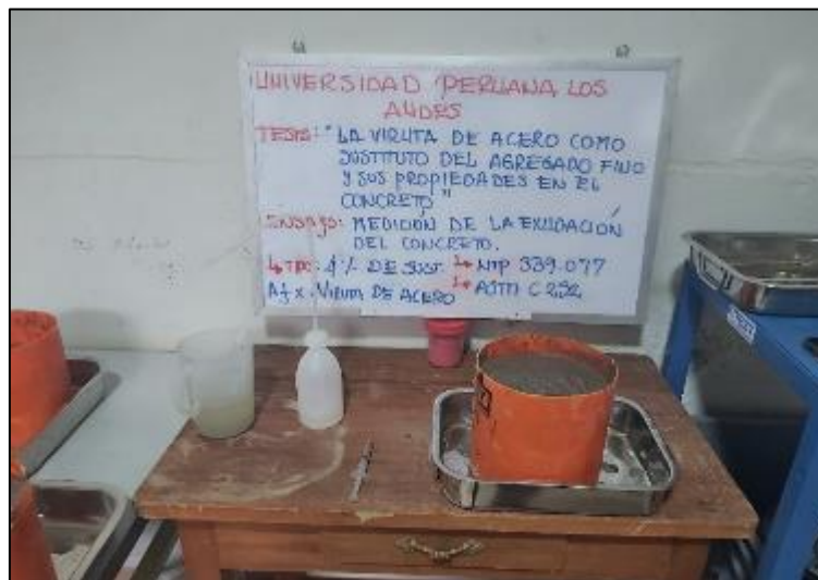
Fotografía 22. Medición de la exudación del concreto con sustitución parcial del agregado fino por viruta de acero en 4 %.
