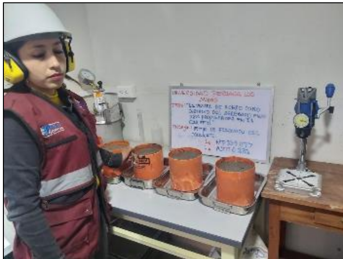
Fotografía 86. Medición del tiempo de fraguado del concreto patrón.
