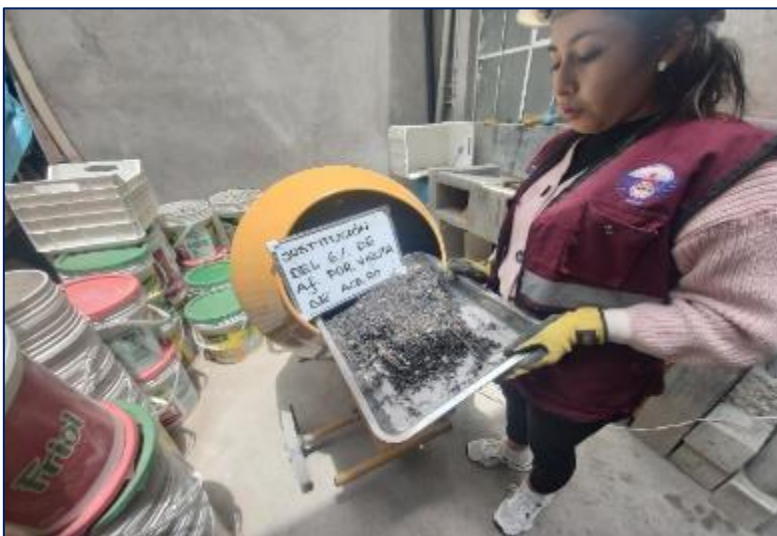
Fotografía 95. Proceso de mezclado del concreto con sustitución parcial del agregado fino por viruta de acero en 6 %.
