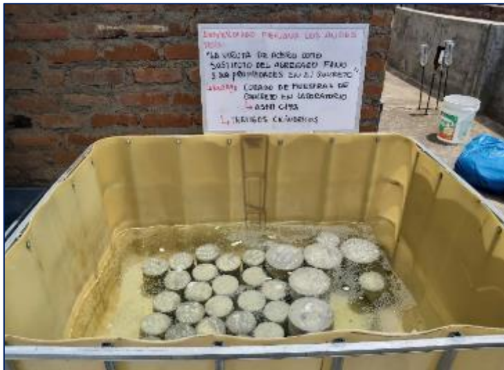
Fotografía 116. Curado de probetas de concreto.
