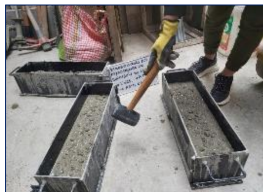
Fotografía 86. Medición del tiempo de fraguado del concreto patrón.
