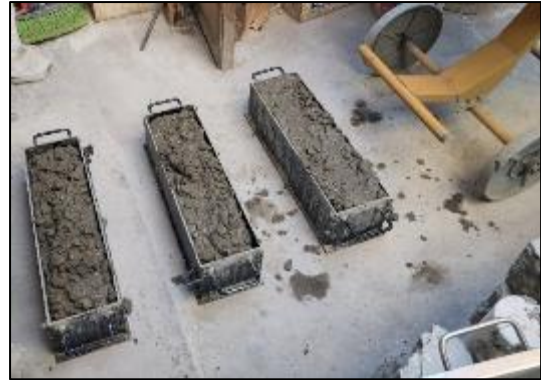
Fotografía 31. Elaboración de probetas y vigas del concreto con sustitución parcial del agregado fino por viruta de acero en 6 %.
