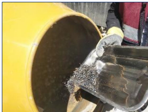
Fotografía 32. Proceso de mezclado del concreto con sustitución parcial del agregado fino por viruta de acero en 10 %.
