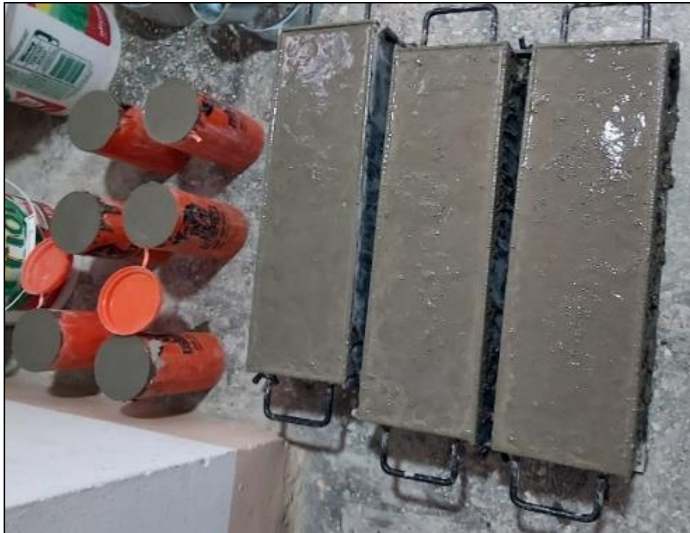
Fotografía 87. Elaboración de probetas y vigas del concreto patrón.
