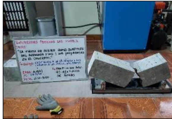
Fotografía 134. Ensayo de resistencia a flexión del concreto patrón a los 28 días.
