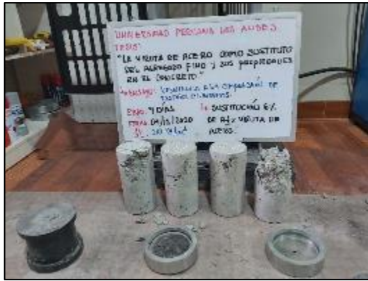
Fotografía 54. Ensayo de resistencia a compresión del concreto con sustitución parcial del agregado fino por viruta de acero en 6 % a los 7 días.
