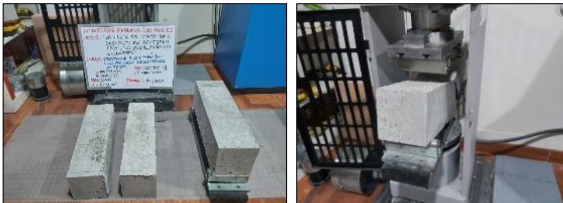
Fotografía 139. Ensayo de resistencia a flexión del concreto con sustitución parcial del agregado fino por viruta de acero en 10 % a los 14 días.
