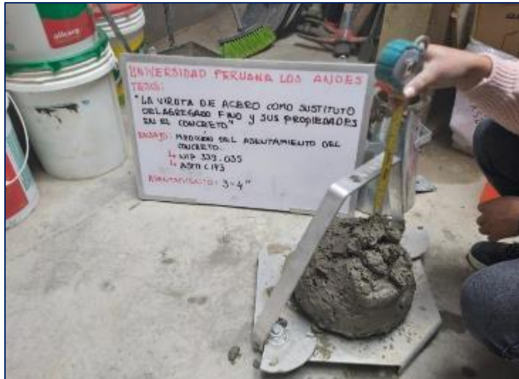
Fotografía 82. Medición del asentamiento del concreto patrón.
