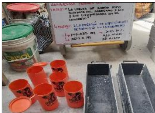
Fotografía 108. Elaboración de probetas y vigas del concreto con sustitución parcial del agregado fino por viruta de acero en 10 %.
