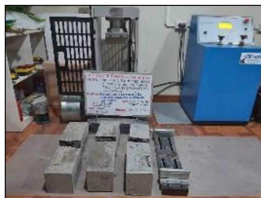
Fotografía 72. Ensayo de resistencia a flexión del concreto con sustitución parcial del agregado fino por viruta de acero en 10 % a los 28 días.
