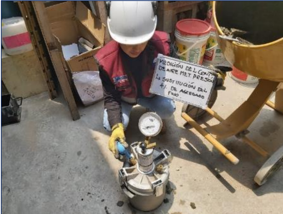
Fotografía 91. Medición del contenido de aire del concreto con sustitución parcial del agregado fino por viruta de acero en 4 %.
