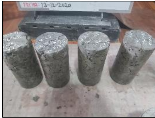
Fotografía 128. Ensayo de resistencia a compresión del concreto con sustitución parcial del agregado fino por viruta de acero en 10 % a los 14 días.
