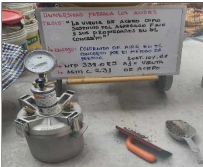
Fotografía 105. Medición del contenido de aire del concreto con sustitución parcial del agregado fino por viruta de acero en 10 %.
