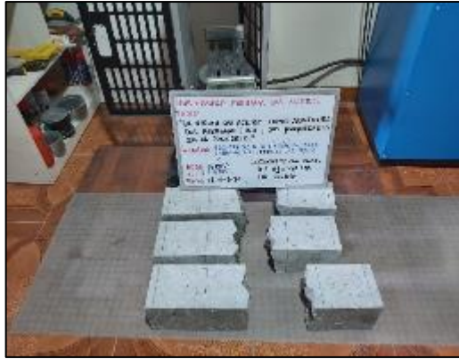
Fotografía 65. Ensayo de resistencia a flexión del concreto con sustitución parcial del agregado fino por viruta de acero en 4 % a los 14 días.
