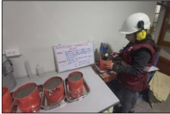
Fotografía 44. Medición del tiempo de fragua del concreto con sustitución parcial del agregado fino por viruta de acero en 12 %.
