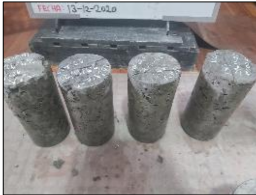
Fotografía 58. Ensayo de resistencia a compresión del concreto con sustitución parcial del agregado fino por viruta de acero en 10 % a los 14 días.
