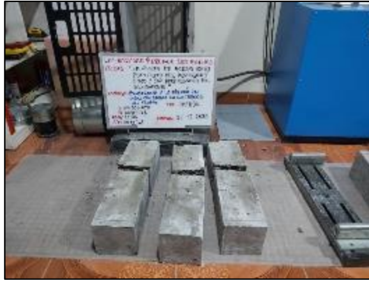
Fotografía 134. Ensayo de resistencia a flexión del concreto patrón a los 28 días.
