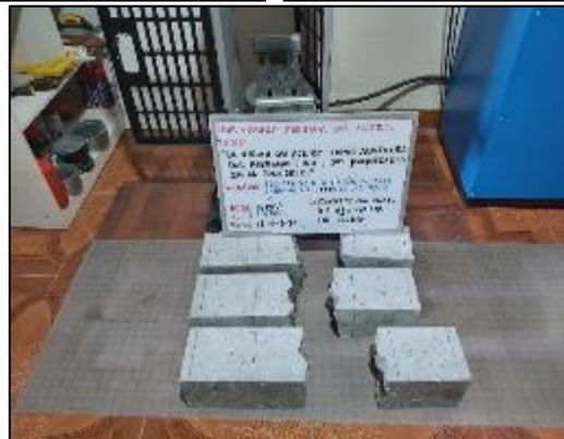
Fotografía 135. Ensayo de resistencia a flexión del concreto con sustitución parcial del agregado fino por viruta de acero en 4 % a los 14 días.
