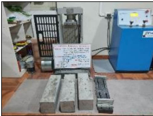
Fotografía 142. Ensayo de resistencia a flexión del concreto con sustitución parcial del agregado fino por viruta de acero en 12 % a los 28 días.
