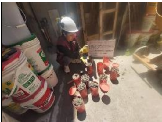
Fotografía 86. Medición del tiempo de fraguado del concreto patrón.
