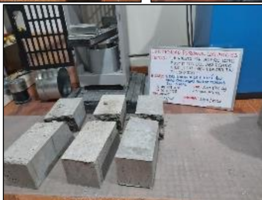
Fotografía 140. Ensayo de resistencia a flexión del concreto con sustitución parcial del agregado fino por viruta de acero en 10 % a los 28 días.
