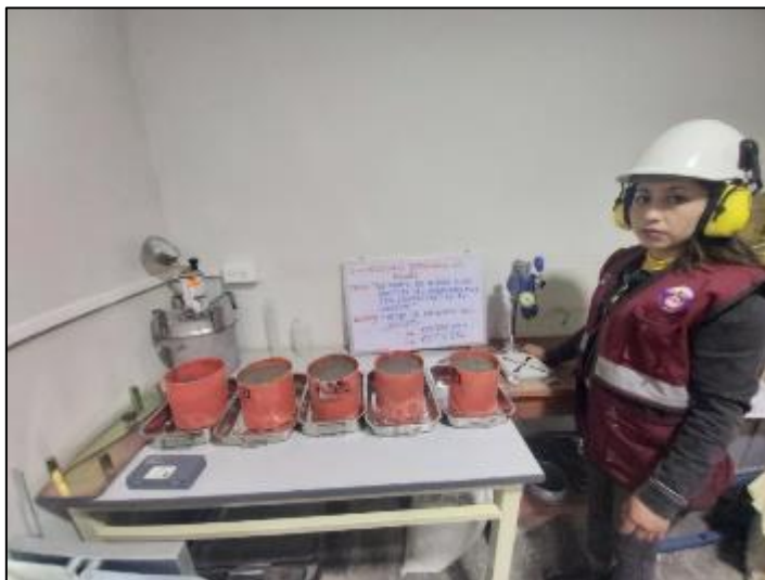
Fotografía 107. Medición del tiempo de fragua del concreto con sustitución parcial del agregado fino por viruta de acero en 10 %.
