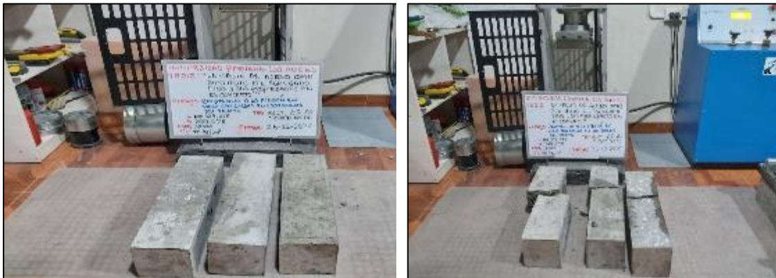
Fotografía 68. Ensayo de resistencia a flexión del concreto con sustitución parcial del agregado fino por viruta de acero en 6 % a los 28 días.
