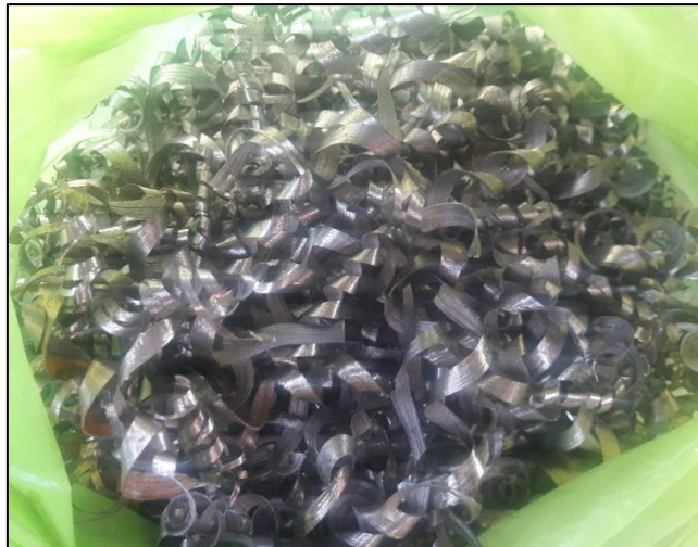
Figura 2. Viruta de acero obtenido de los desechos de empresa metalmecánica. Fuente: Pacheco (2016).
