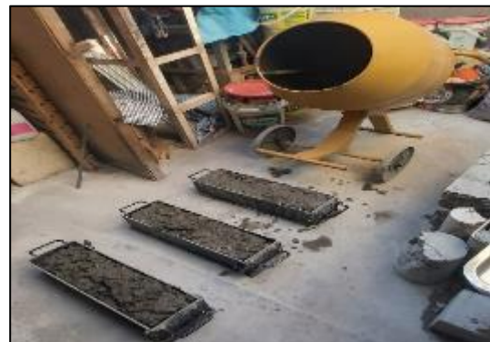
Fotografía 108. Elaboración de probetas y vigas del concreto con sustitución parcial del agregado fino por viruta de acero en 10 %.
