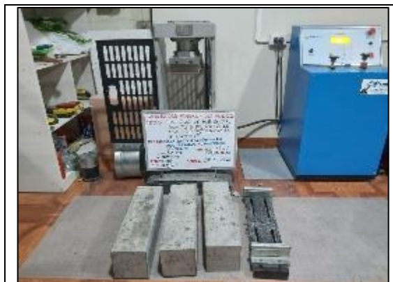
Fotografía 72. Ensayo de resistencia a flexión del concreto con sustitución parcial del agregado fino por viruta de acero en 10 % a los 28 días.
