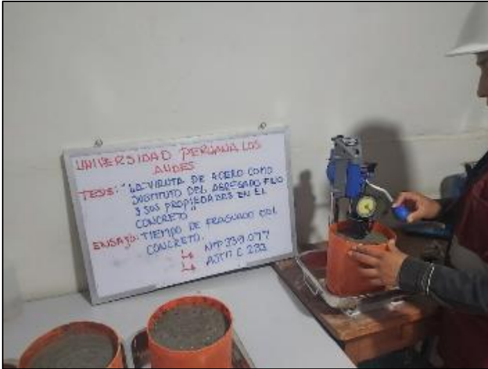
Fotografía 100. Medición del tiempo de fragua del concreto con sustitución parcial del agregado fino por viruta de acero en 6 %.
