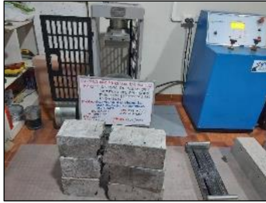
Fotografía 136. Ensayo de resistencia a flexión del concreto con sustitución parcial del agregado fino por viruta de acero en 4 % a los 28 días.
