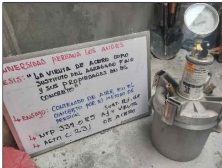
Fotografía 42. Medición del contenido de aire del concreto con sustitución parcial del agregado fino por viruta de acero en 12 %.
