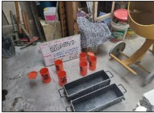
Fotografía 115. Elaboración de probetas y vigas del concreto con sustitución parcial del agregado fino por viruta de acero en 12 %.
