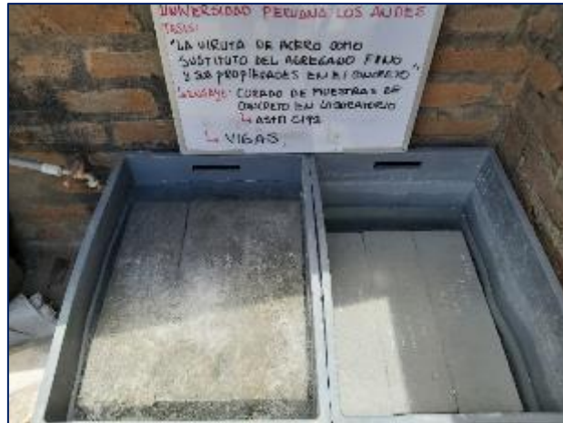
Fotografía 47. Curado de vigas de concreto.
