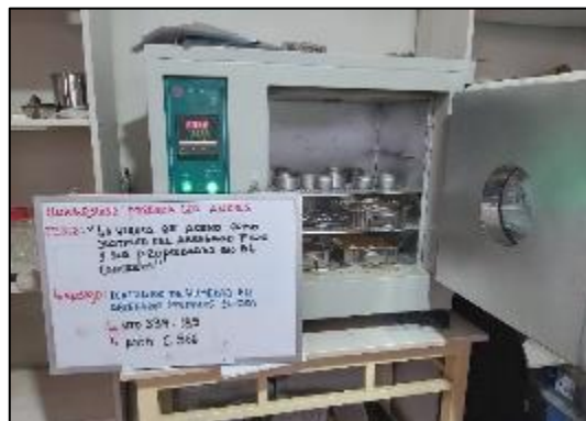
Fotografía 6. Vista de agregados en el horno para determinar el contenido de humedad.
