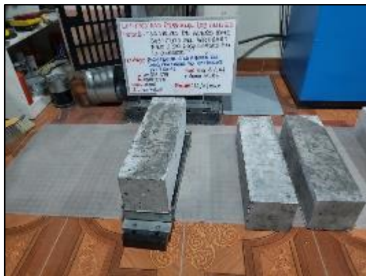
Fotografía 135. Ensayo de resistencia a flexión del concreto con sustitución parcial del agregado fino por viruta de acero en 4 % a los 14 días.
