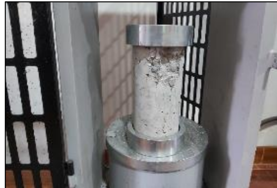
Fotografía 120. Ensayo de resistencia a compresión del concreto patrón a los 28 días.
