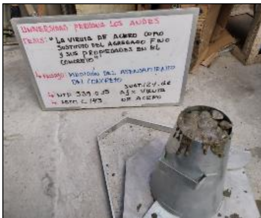
Fotografía 40. Medición del asentamiento del concreto con sustitución parcial del agregado fino por viruta de acero en 12 %.
