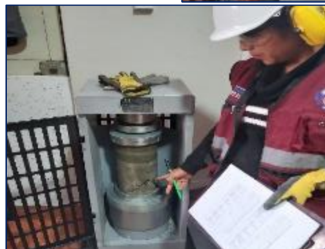
Fotografía 119. Ensayo de resistencia a compresión del concreto patrón a los 14 días.
