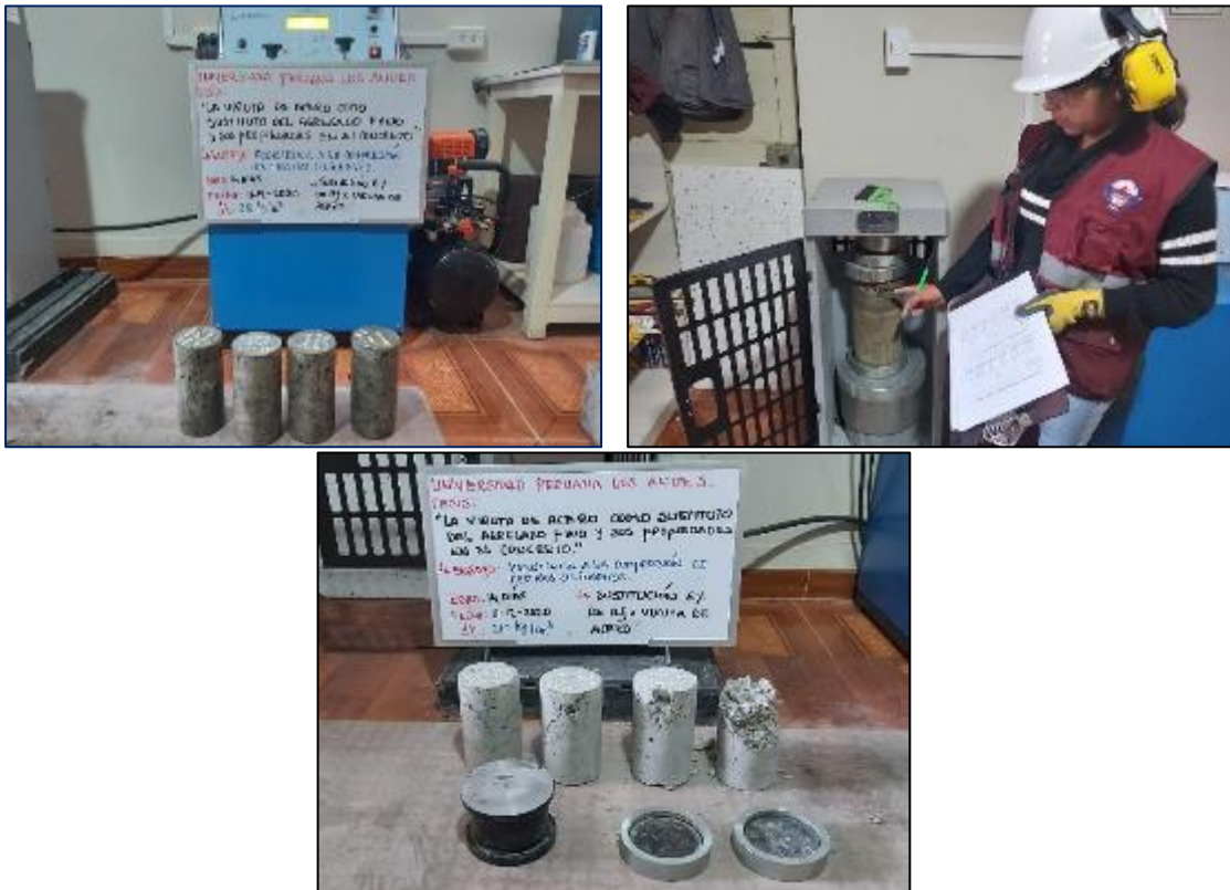
Fotografía 55. Ensayo de resistencia a compresión del concreto con sustitución parcial del agregado fino por viruta de acero en 6 % a los 14 días.
