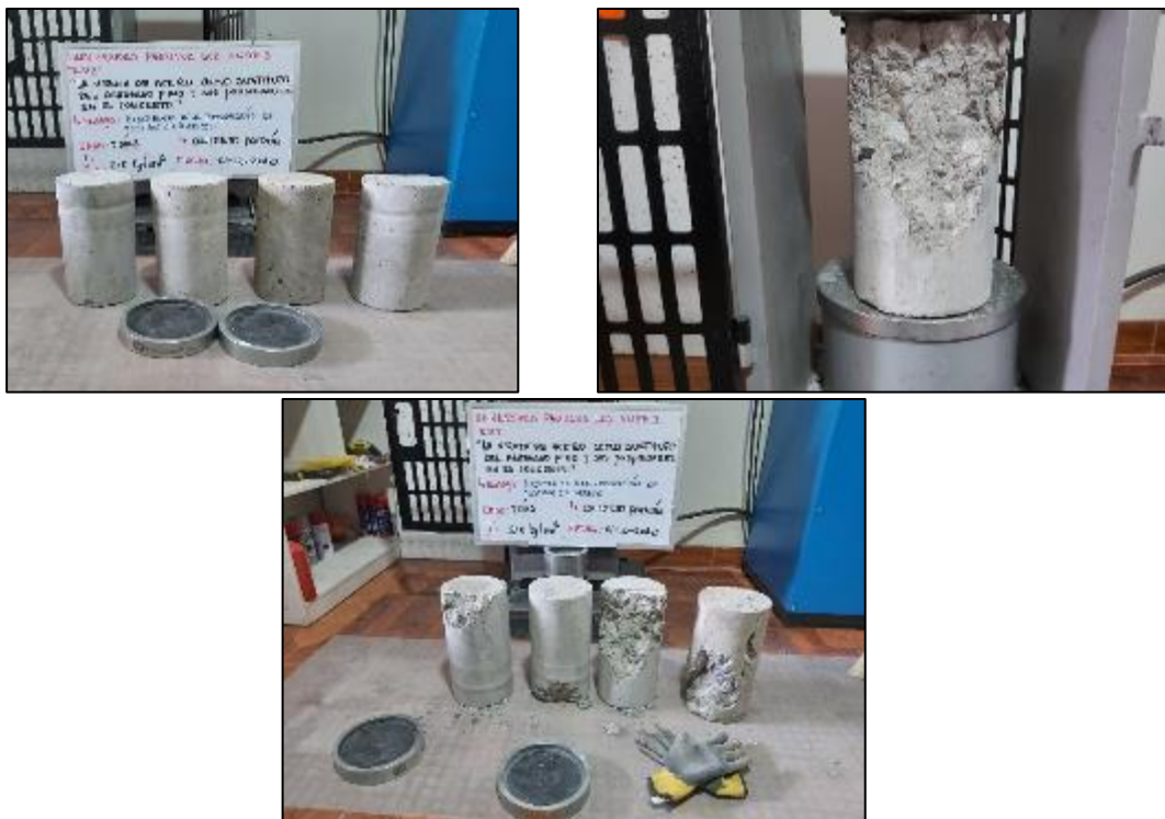
Fotografía 48. Ensayo de resistencia a compresión del concreto patrón a los 7 días.
