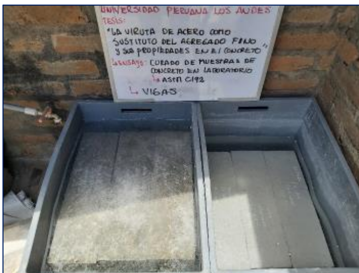
Fotografía 117. Curado de vigas de concreto.
