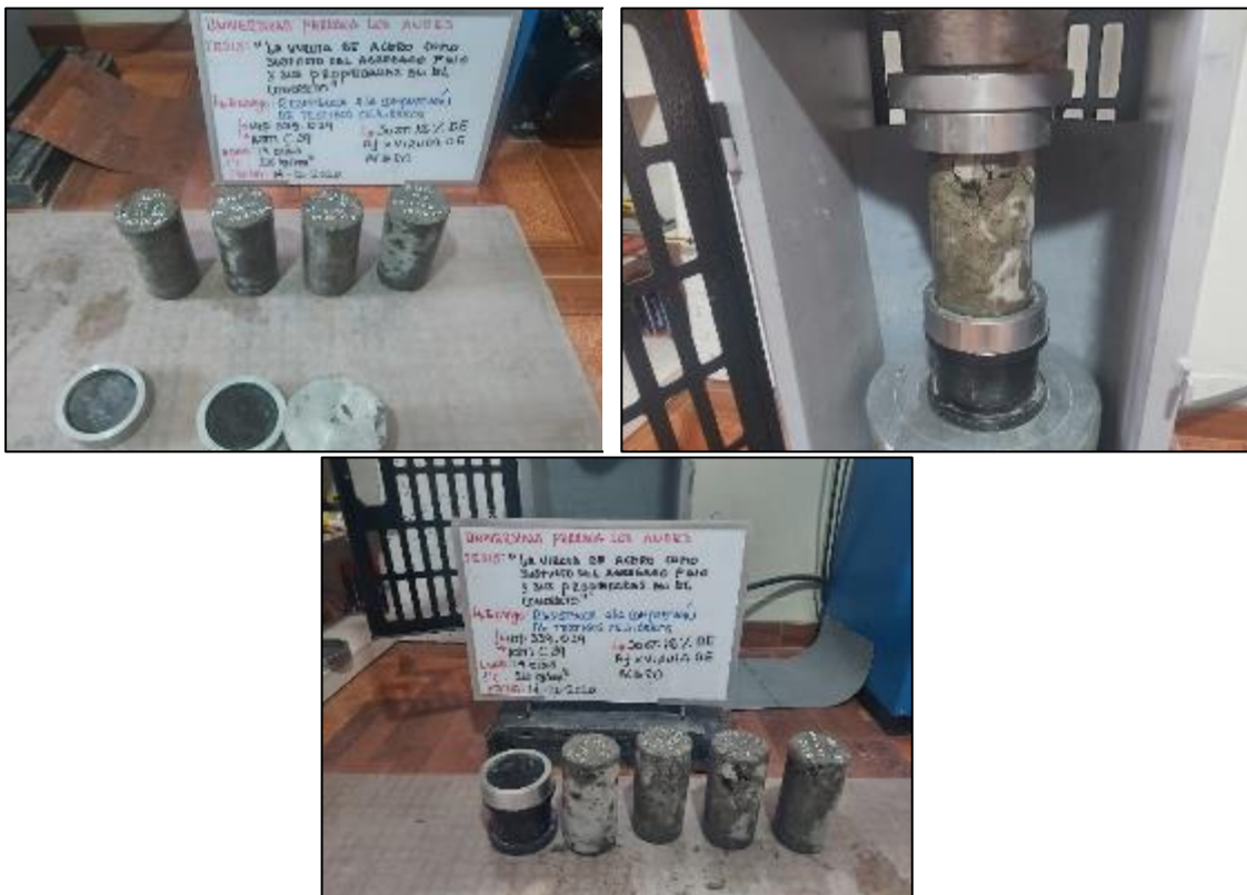
Fotografía 61. Ensayo de resistencia a compresión del concreto con sustitución parcial del agregado fino por viruta de acero en 12 % a los 14 días.
