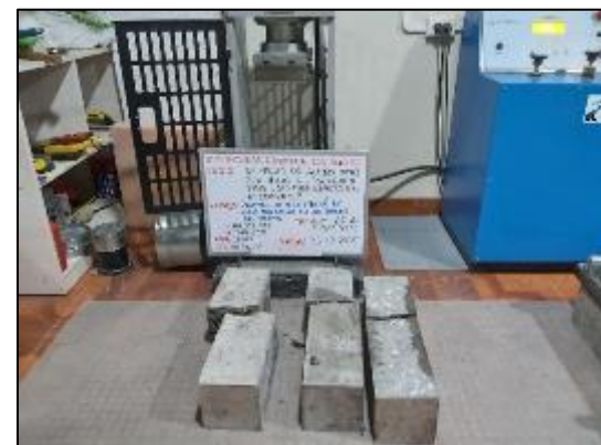
Fotografía 138. Ensayo de resistencia a flexión del concreto con sustitución parcial del agregado fino por viruta de acero en 6 % a los 28 días.
