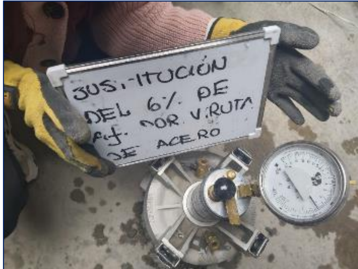
Fotografía 28. Medición del contenido de aire del concreto con sustitución parcial del agregado fino por viruta de acero en 6 %.
