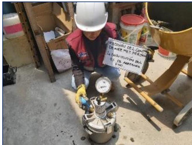
Fotografía 21. Medición del contenido de aire del concreto con sustitución parcial del agregado fino por viruta de acero en 4 %.
