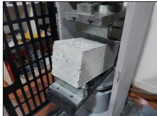
Fotografía 136. Ensayo de resistencia a flexión del concreto con sustitución parcial del agregado fino por viruta de acero en 4 % a los 28 días.
