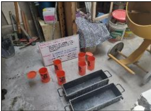
Fotografía 45. Elaboración de probetas y vigas del concreto con sustitución parcial del agregado fino por viruta de acero en 12 %.
