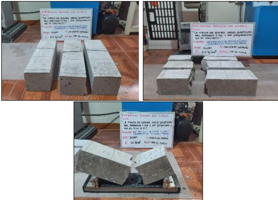
Fotografía 133. Ensayo de resistencia a flexión del concreto patrón a los 14 días.
