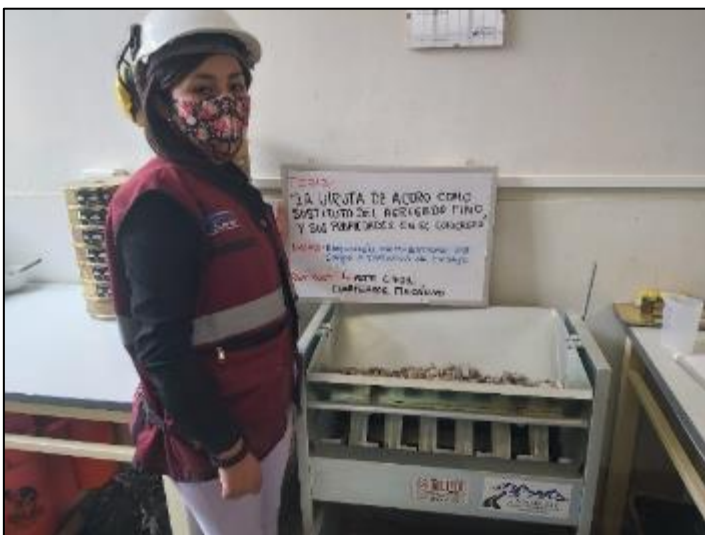
Fotografía 74. Vista el equipo cuarteador mecánico para la realización del cuarteo del agregado grueso.
