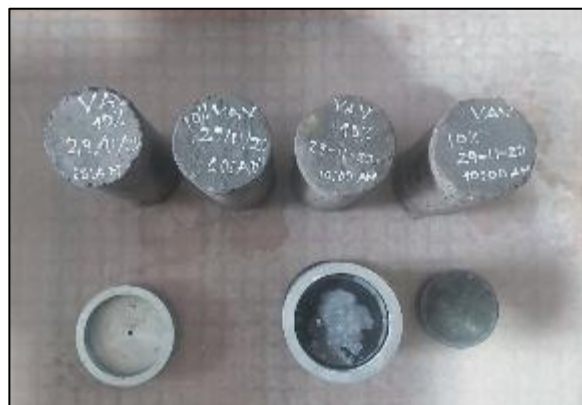
Fotografía 127. Ensayo de resistencia a compresión del concreto con sustitución parcial del agregado fino por viruta de acero en 10 % a los 7 días.
