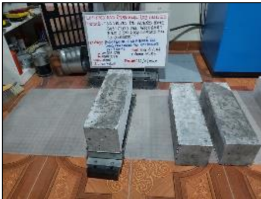
Fotografía 65. Ensayo de resistencia a flexión del concreto con sustitución parcial del agregado fino por viruta de acero en 4 % a los 14 días.
