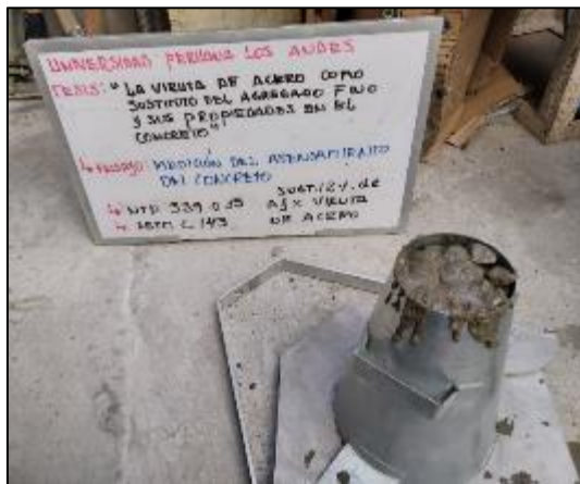
Fotografía 110. Medición del asentamiento del concreto con sustitución parcial del agregado fino por viruta de acero en 12 %.
