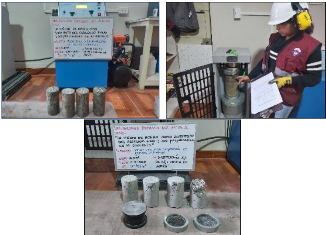
Fotografía 125. Ensayo de resistencia a compresión del concreto con sustitución parcial del agregado fino por viruta de acero en 6 % a los 14 días.
