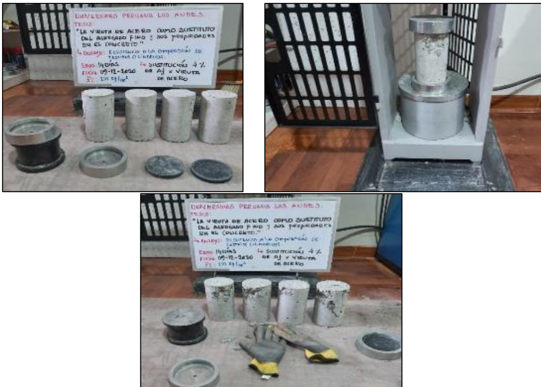
Fotografía 52. Ensayo de resistencia a compresión del concreto con sustitución parcial del agregado fino por viruta de acero en 4 % a los 14 días.
