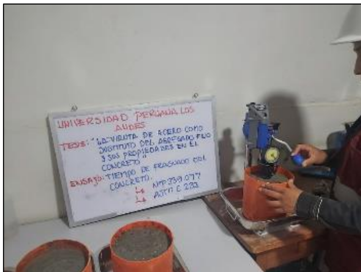
Fotografía 30. Medición del tiempo de fragua del concreto con sustitución parcial del agregado fino por viruta de acero en 6 %.
