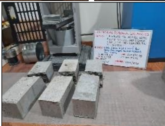
Fotografía 70. Ensayo de resistencia a flexión del concreto con sustitución parcial del agregado fino por viruta de acero en 10 % a los 28 días.
