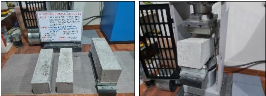
Fotografía 69. Ensayo de resistencia a flexión del concreto con sustitución parcial del agregado fino por viruta de acero en 10 % a los 14 días.
