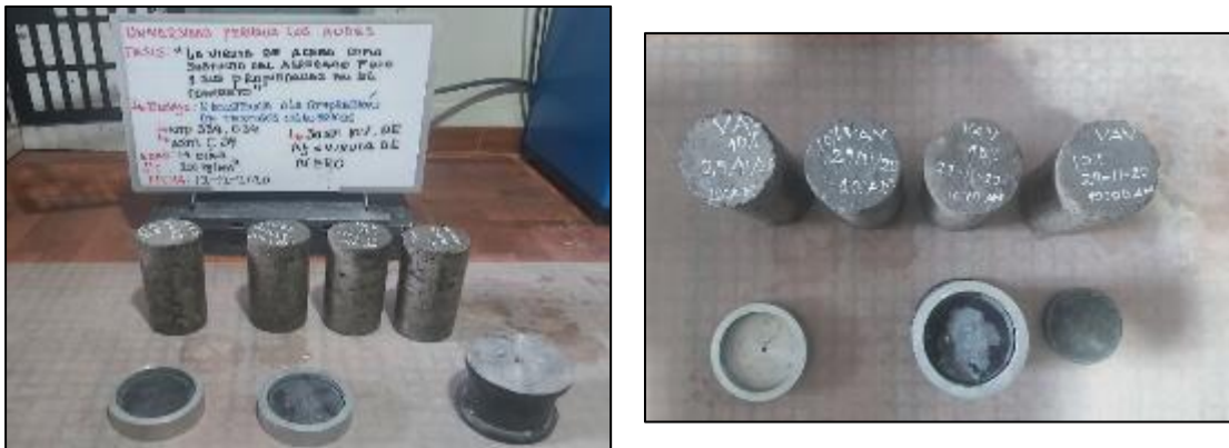
Fotografía 57. Ensayo de resistencia a compresión del concreto con sustitución parcial del agregado fino por viruta de acero en 10 % a los 7 días.
