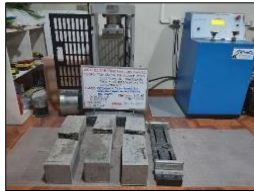
Fotografía 142. Ensayo de resistencia a flexión del concreto con sustitución parcial del agregado fino por viruta de acero en 12 % a los 28 días.
