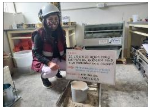
Fotografía 77. Vista de la determinación del peso unitario del agregado grueso y fino.
