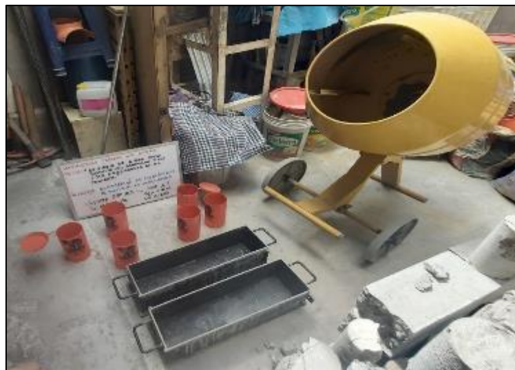
Fotografía 11. Proceso de mezclado del concreto patrón de f'c : 210 kg/cm 2 .
