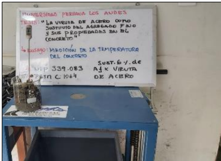
Fotografía 27. Medición de la temperatura del concreto con sustitución parcial del agregado fino por viruta de acero en 6 %.
