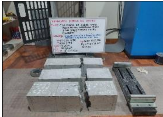
Fotografía 139. Ensayo de resistencia a flexión del concreto con sustitución parcial del agregado fino por viruta de acero en 10 % a los 14 días.
