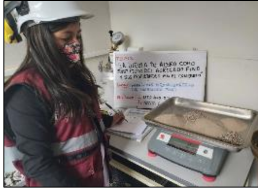
Fotografía 75. Realización del ensayo para determinar la granulometría del agregado fino y grueso.
