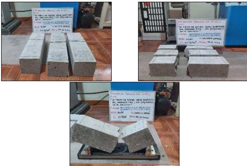
Fotografía 63. Ensayo de resistencia a flexión del concreto patrón a los 14 días.
