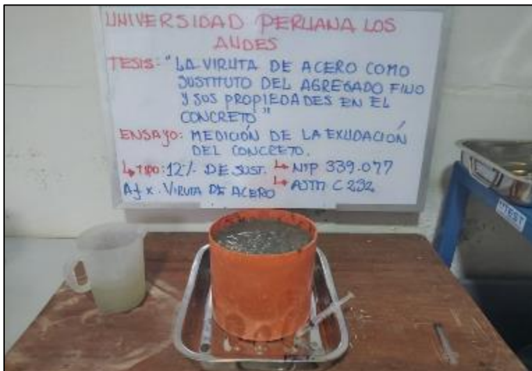
Fotografía 113. Medición de la exudación del concreto con sustitución parcial del agregado fino por viruta de acero en 12 %.
