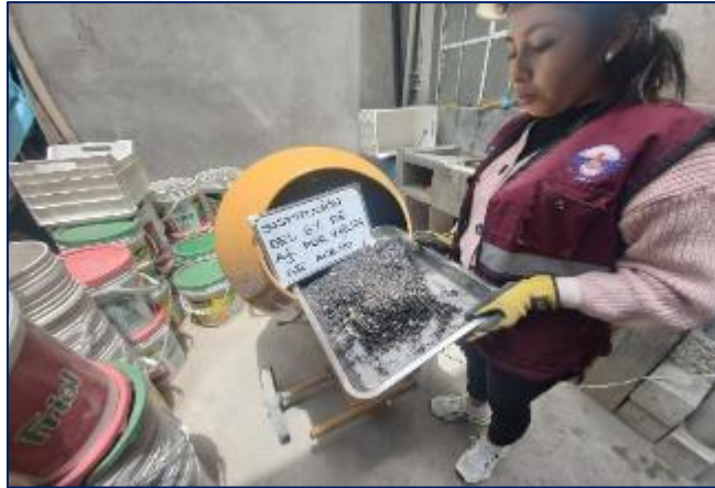
Fotografía 25. Proceso de mezclado del concreto con sustitución parcial del agregado fino por viruta de acero en 6 %.
