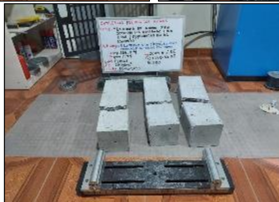
Fotografía 137. Ensayo de resistencia a flexión del concreto con sustitución parcial del agregado fino por viruta de acero en 6 % a los 14 días.
