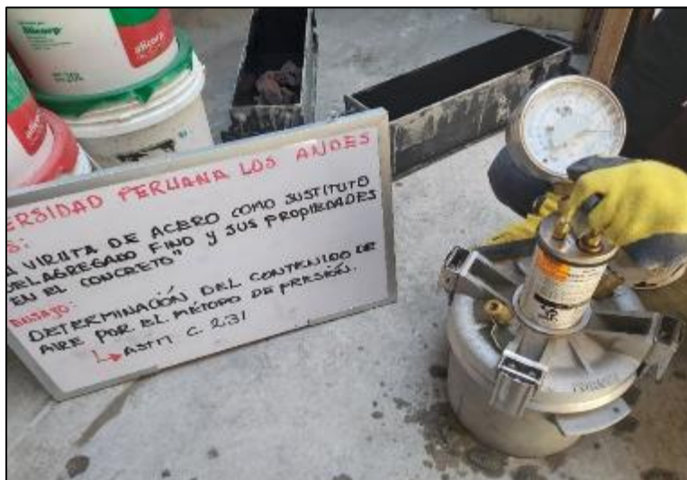
Fotografía 84. Medición del contenido de aire en el concreto patrón.
