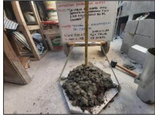
Fotografía 33. Medición del asentamiento del concreto con sustitución parcial del agregado fino por viruta de acero en 10 %.
