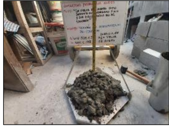
Fotografía 103. Medición del asentamiento del concreto con sustitución parcial del agregado fino por viruta de acero en 10 %.
