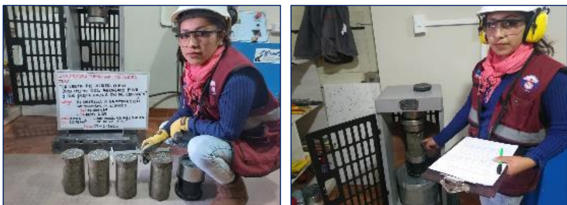
Fotografía 129. Ensayo de resistencia a compresión del concreto con sustitución parcial del agregado fino por viruta de acero en 10 % a los 28 días.
