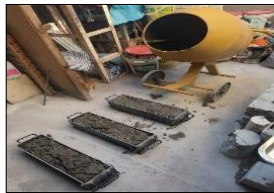
Fotografía 38. Elaboración de probetas y vigas del concreto con sustitución parcial del agregado fino por viruta de acero en 10 %.
