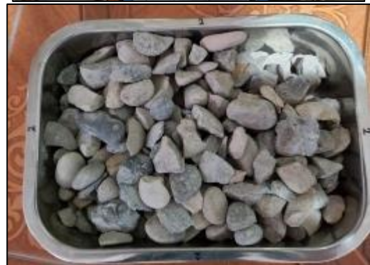
Fotografía 78. Ensayo para determinar la densidad, densidad relativa y absorción de los agregados gruesos.
