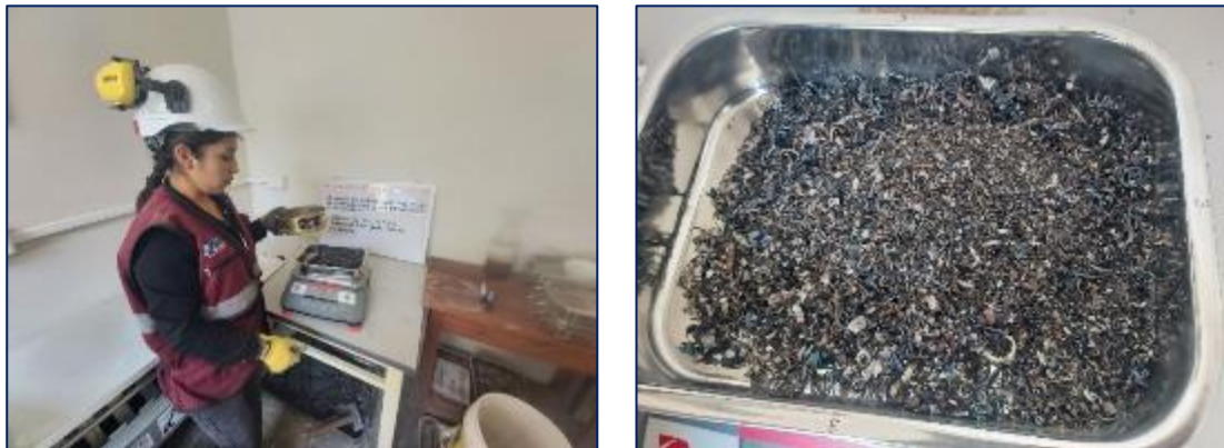
Fotografía 80. Vista de la viruta de acero a emplear en las mezclas de concreto.
