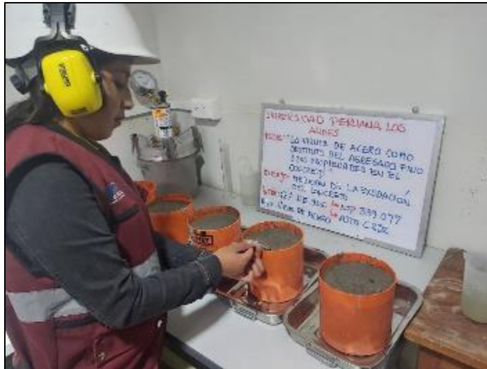
Fotografía 85. Medición de la exudación del concreto patrón.
