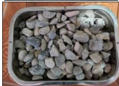
Fotografía 8. Ensayo para determinar la densidad, densidad relativa y absorción de los agregados gruesos.
