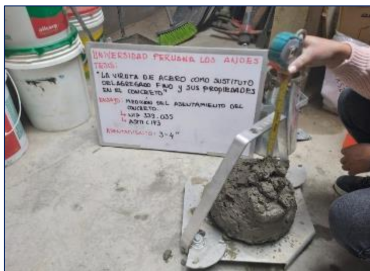
Fotografía 12. Medición del asentamiento del concreto patrón.
