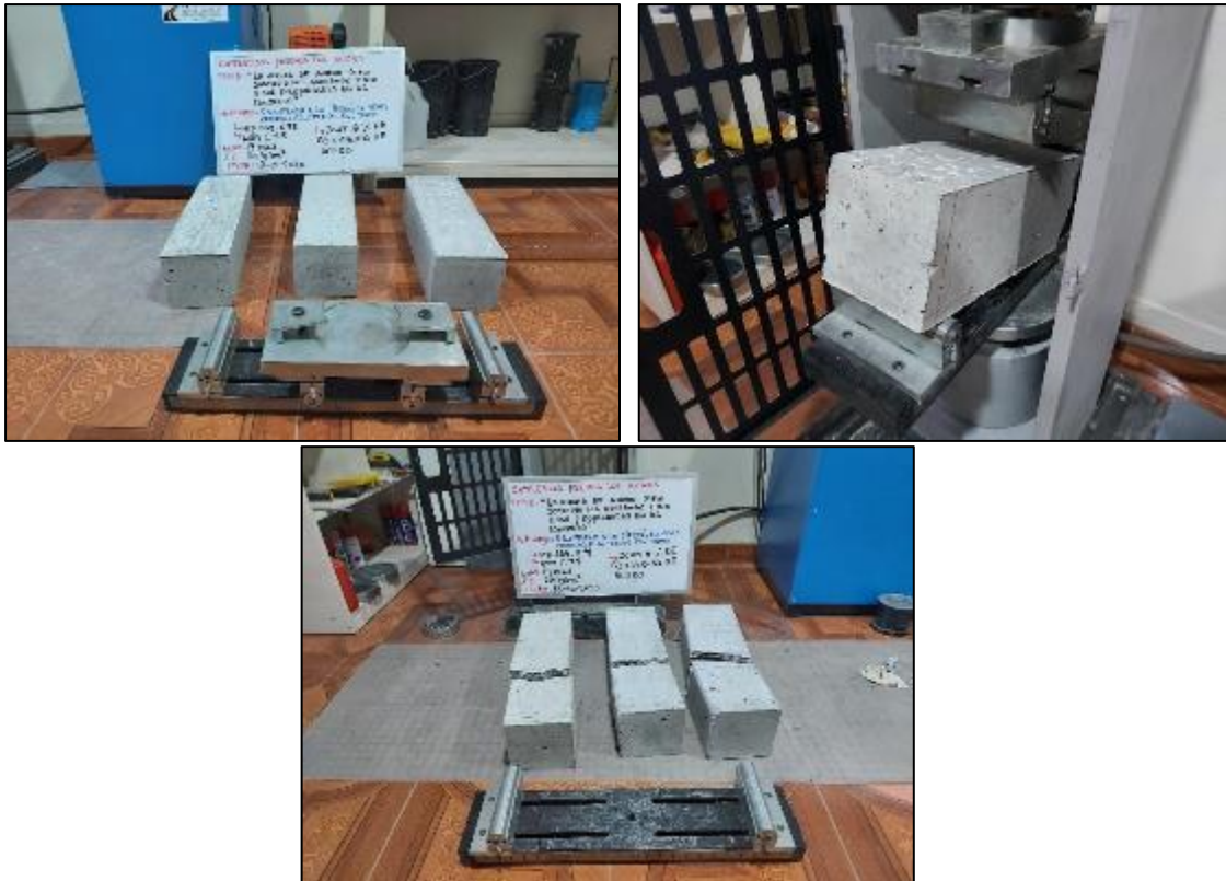
Fotografía 67. Ensayo de resistencia a flexión del concreto con sustitución parcial del agregado fino por viruta de acero en 6 % a los 14 días.
