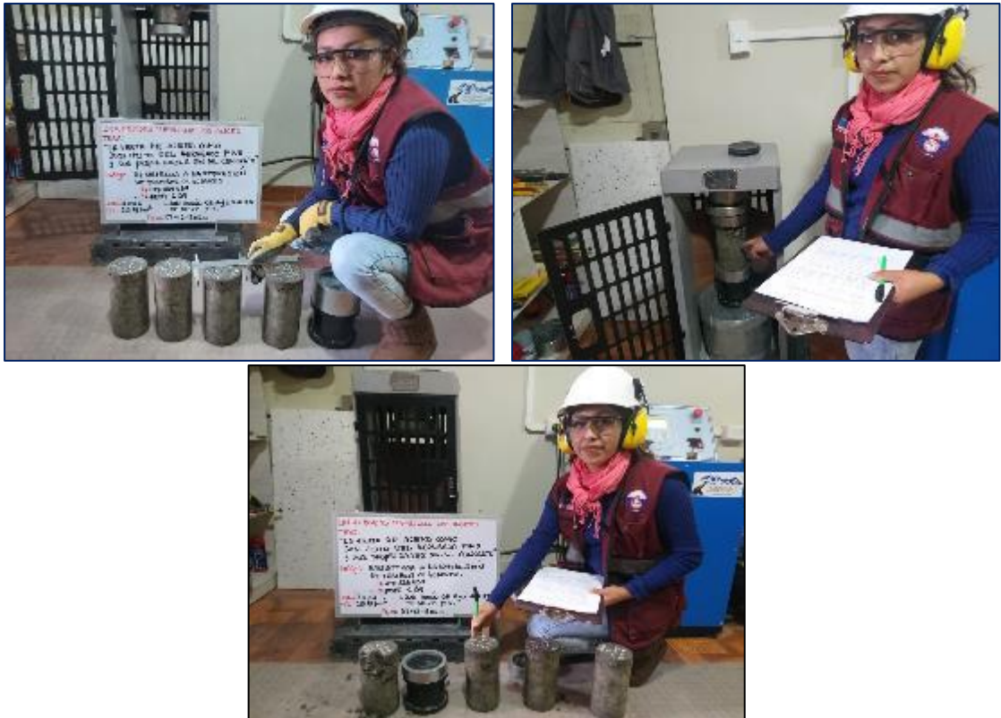
Fotografía 60. Ensayo de resistencia a compresión del concreto con sustitución parcial del agregado fino por viruta de acero en 12 % a los 7 días.
