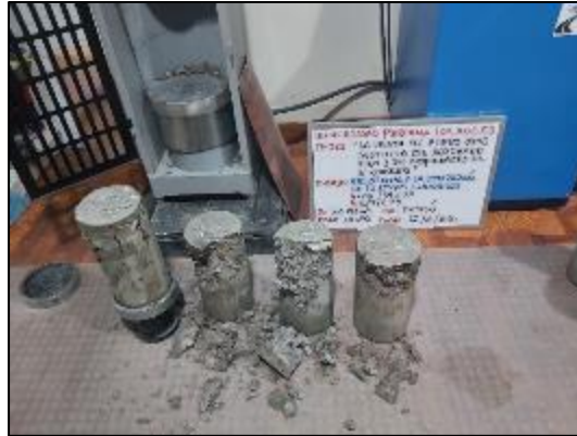
Fotografía 120. Ensayo de resistencia a compresión del concreto patrón a los 28 días.
