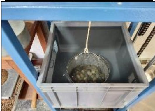
Fotografía 78. Ensayo para determinar la densidad, densidad relativa y absorción de los agregados gruesos.
