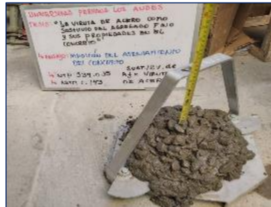
Fotografía 40. Medición del asentamiento del concreto con sustitución parcial del agregado fino por viruta de acero en 12 %.
