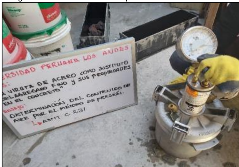
Fotografía 14. Medición del contenido de aire en el concreto patrón.
