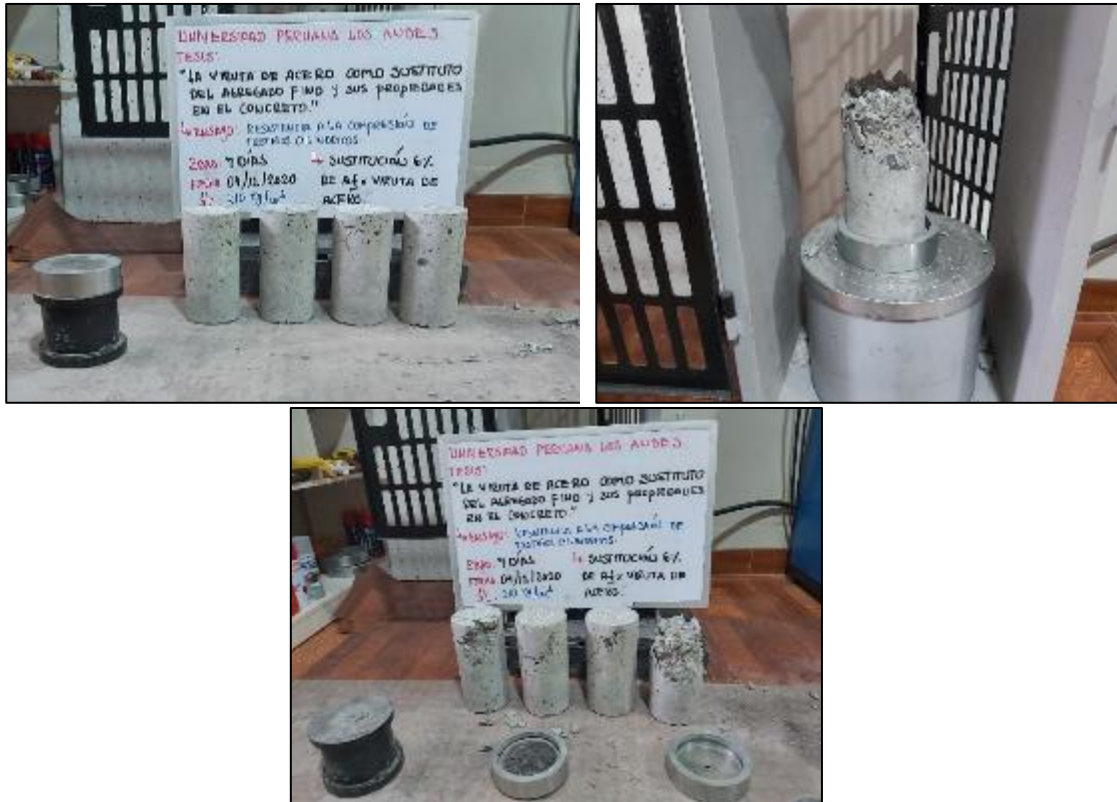
Fotografía 124. Ensayo de resistencia a compresión del concreto con sustitución parcial del agregado fino por viruta de acero en 6 % a los 7 días.
