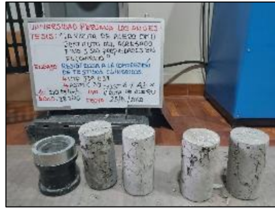
Fotografía 126. Ensayo de resistencia a compresión del concreto con sustitución parcial del agregado fino por viruta de acero en 6 % a los 28 días.
