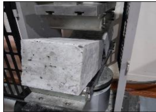
Fotografía 65. Ensayo de resistencia a flexión del concreto con sustitución parcial del agregado fino por viruta de acero en 4 % a los 14 días.
