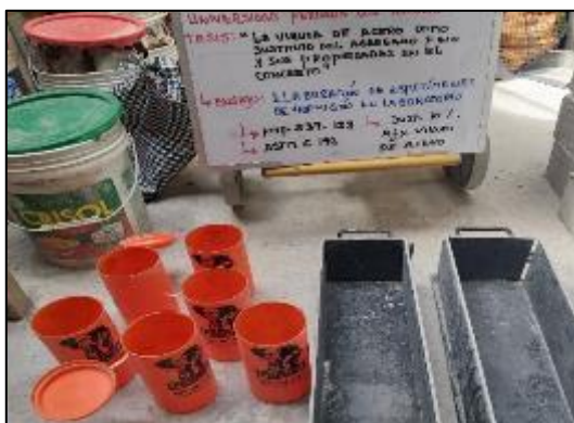
Fotografía 38. Elaboración de probetas y vigas del concreto con sustitución parcial del agregado fino por viruta de acero en 10 %.
