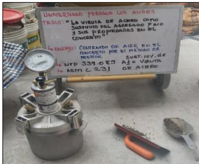
Fotografía 35. Medición del contenido de aire del concreto con sustitución parcial del agregado fino por viruta de acero en 10 %.
