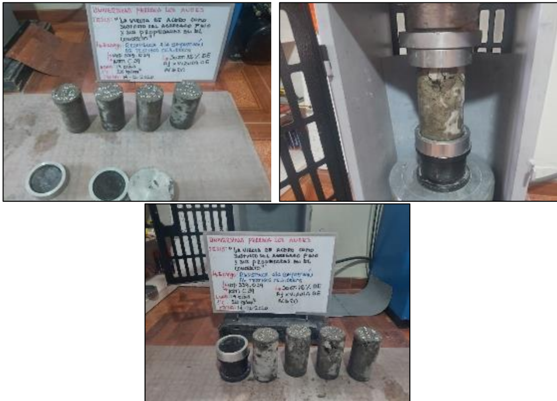
Fotografía 131. Ensayo de resistencia a compresión del concreto con sustitución parcial del agregado fino por viruta de acero en 12 % a los 14 días.
