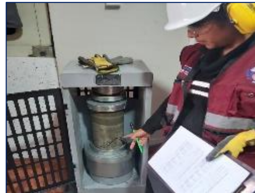
Fotografía 118. Ensayo de resistencia a compresión del concreto patrón a los 7 días.
