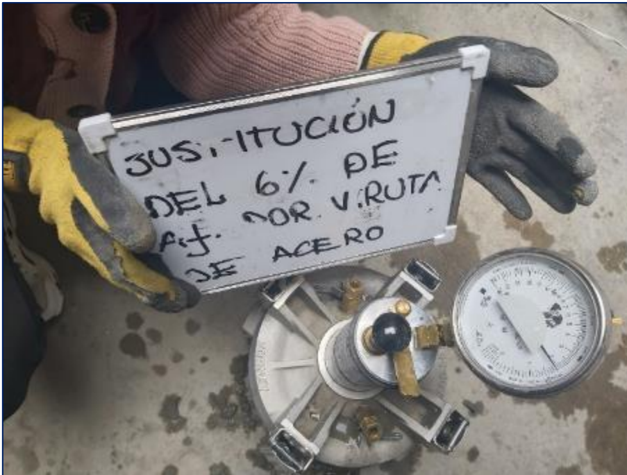
Fotografía 98. Medición del contenido de aire del concreto con sustitución parcial del agregado fino por viruta de acero en 6 %.
