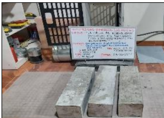
Fotografía 138. Ensayo de resistencia a flexión del concreto con sustitución parcial del agregado fino por viruta de acero en 6 % a los 28 días.
