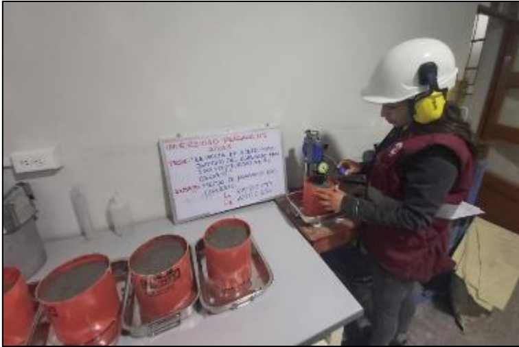
Fotografía 93. Medición del tiempo de fragua del concreto con sustitución parcial del agregado fino por viruta de acero en 4 %.
