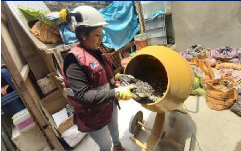
Fotografía 109. Proceso de mezclado del concreto con sustitución parcial del agregado fino por viruta de acero en 12 %.
