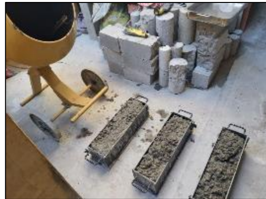
Fotografía 94. Elaboración de probetas y vigas del concreto con sustitución parcial del agregado fino por viruta de acero en 4 %.
