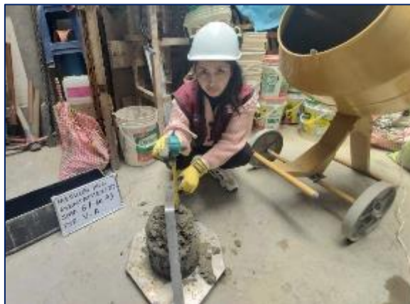
Fotografía 26. Medición del asentamiento del concreto con sustitución parcial del agregado fino por viruta de acero en 6 %.
