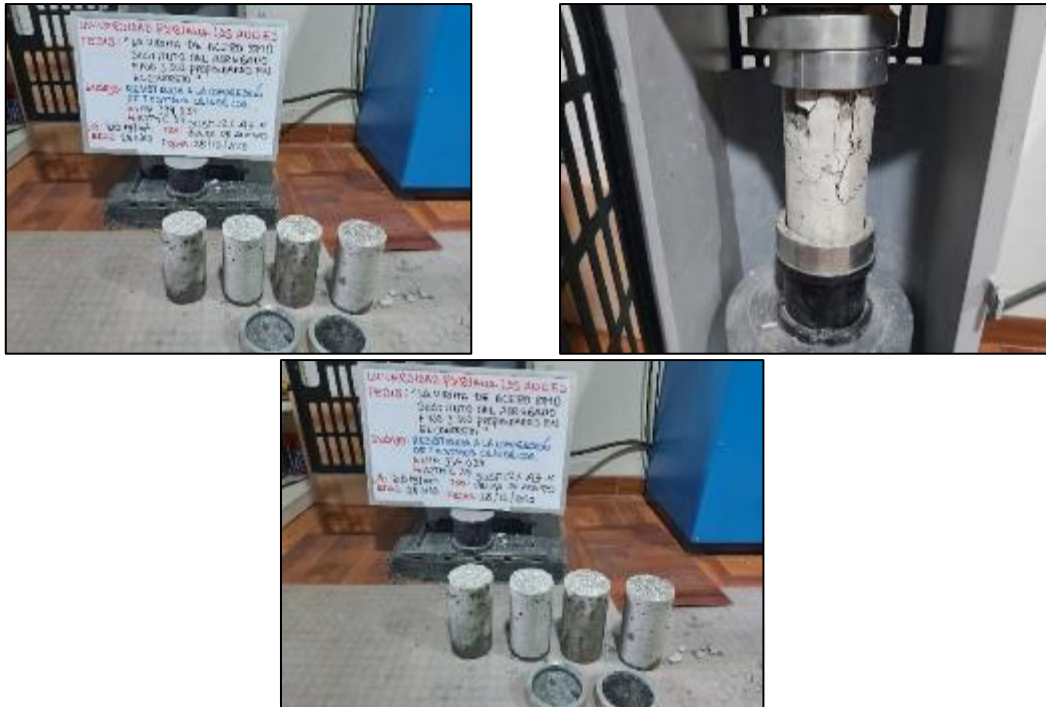
Fotografía 62. Ensayo de resistencia a compresión del concreto con sustitución parcial del agregado fino por viruta de acero en 12 % a los 28 días.
