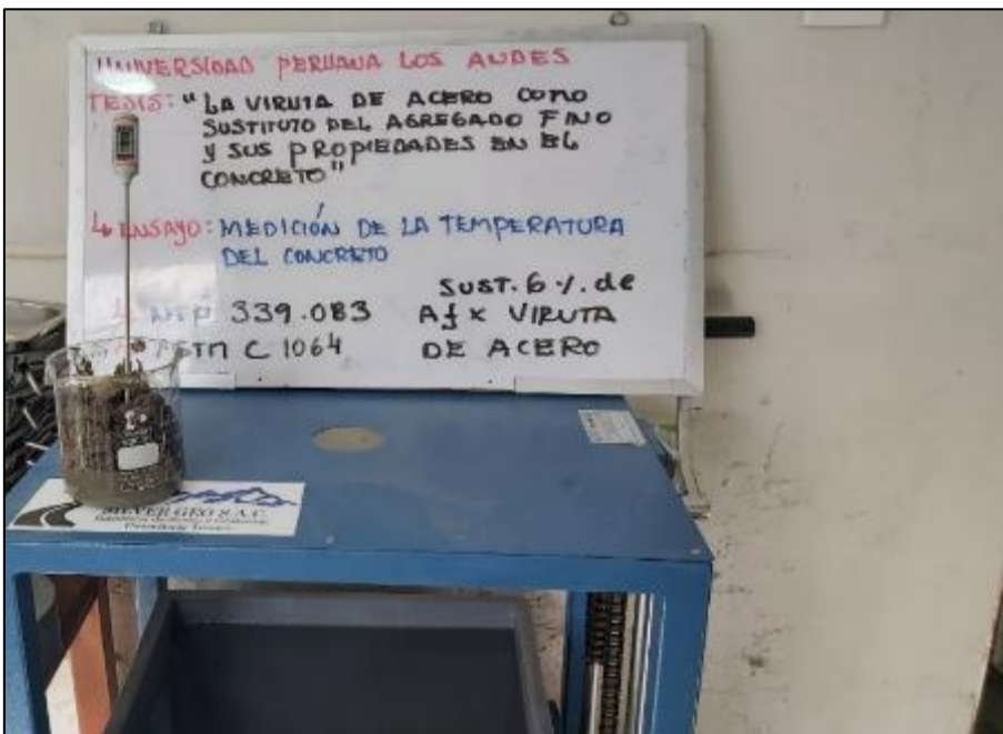
Fotografía 97. Medición de la temperatura del concreto con sustitución parcial del agregado fino por viruta de acero en 6 %.
