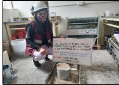
Fotografía 7. Vista de la determinación del peso unitario del agregado grueso y fino.
