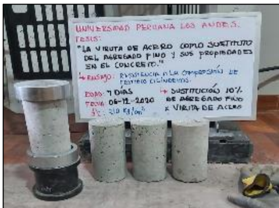
Fotografía 126. Ensayo de resistencia a compresión del concreto con sustitución parcial del agregado fino por viruta de acero en 6 % a los 28 días.
