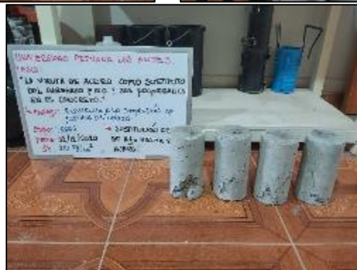
Fotografía 121. Ensayo de resistencia a compresión del concreto con sustitución parcial del agregado fino por viruta de acero en 4 % a los 7 días.
