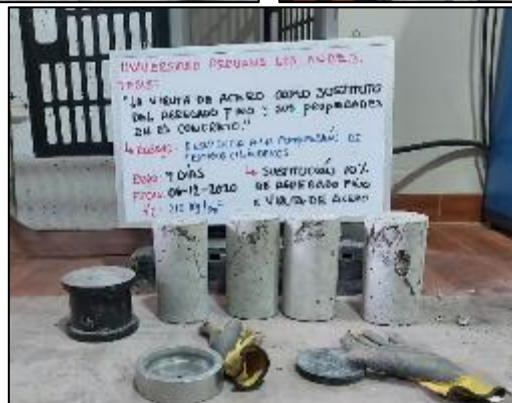
Fotografía 127. Ensayo de resistencia a compresión del concreto con sustitución parcial del agregado fino por viruta de acero en 10 % a los 7 días.
