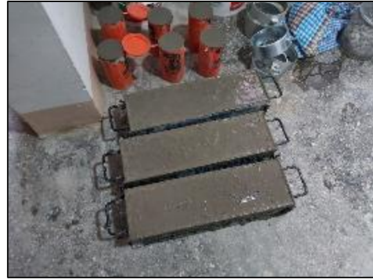
Fotografía 115. Elaboración de probetas y vigas del concreto con sustitución parcial del agregado fino por viruta de acero en 12 %.
