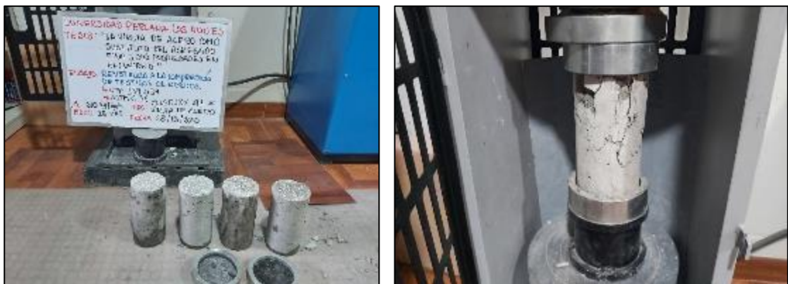
Fotografía 131. Ensayo de resistencia a compresión del concreto con sustitución parcial del agregado fino por viruta de acero en 12 % a los 14 días.
