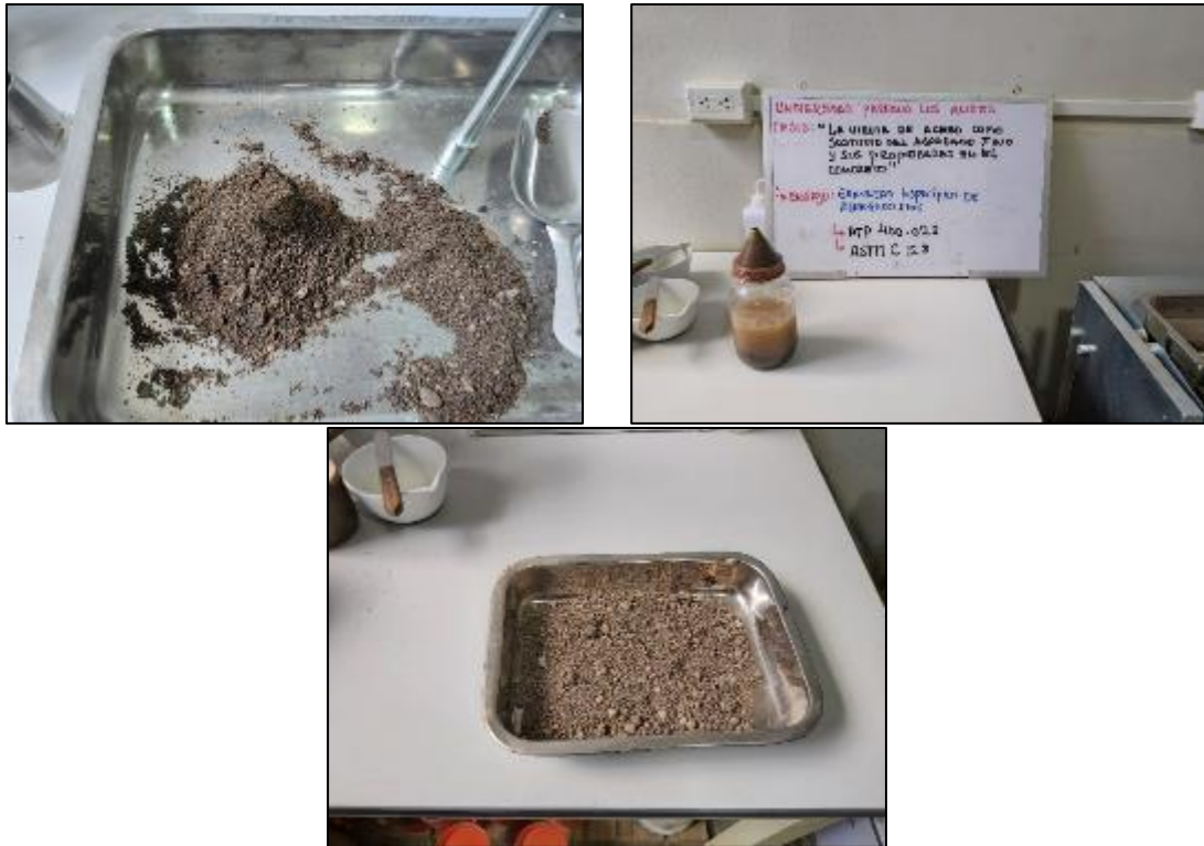
Fotografía 79. Ensayo para determinar la densidad, densidad relativa y absorción de los agregados finos.
