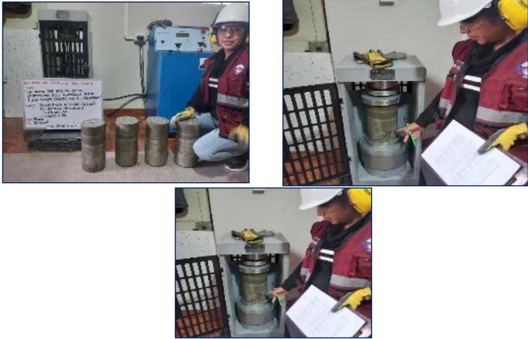
Fotografía 49. Ensayo de resistencia a compresión del concreto patrón a los 14 días.
