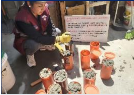
Fotografía 31. Elaboración de probetas y vigas del concreto con sustitución parcial del agregado fino por viruta de acero en 6 %.
