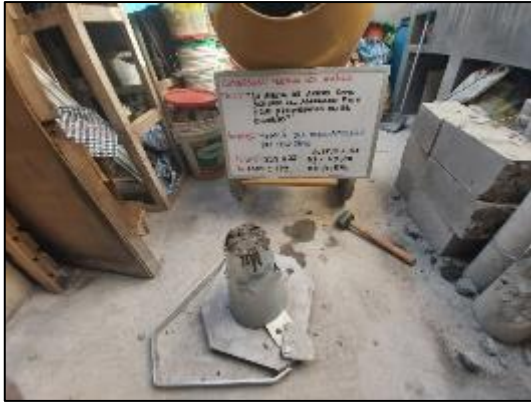
Fotografía 33. Medición del asentamiento del concreto con sustitución parcial del agregado fino por viruta de acero en 10 %.
