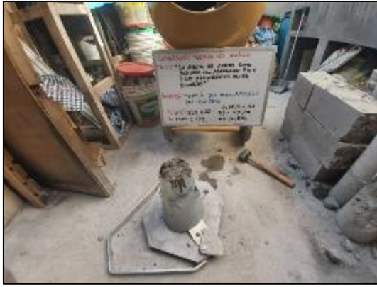
Fotografía 103. Medición del asentamiento del concreto con sustitución parcial del agregado fino por viruta de acero en 10 %.
