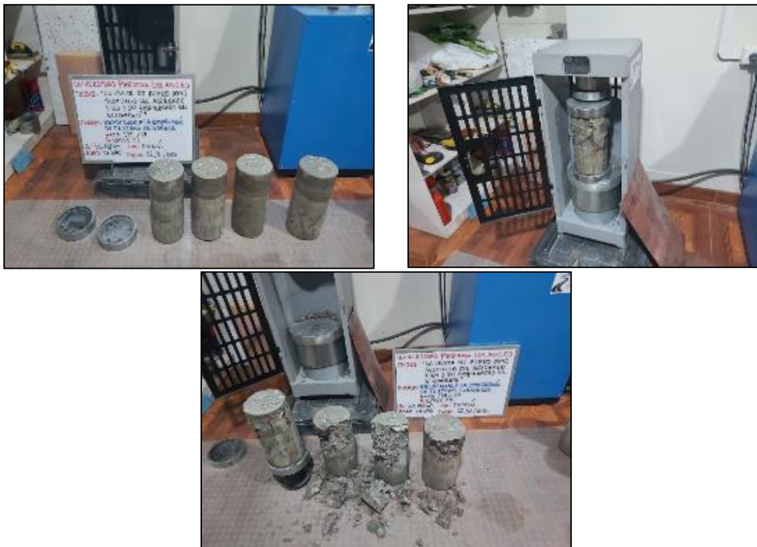
Fotografía 50. Ensayo de resistencia a compresión del concreto patrón a los 28 días.
