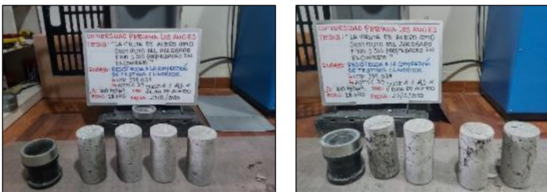
Fotografía 56. Ensayo de resistencia a compresión del concreto con sustitución parcial del agregado fino por viruta de acero en 6 % a los 28 días.
