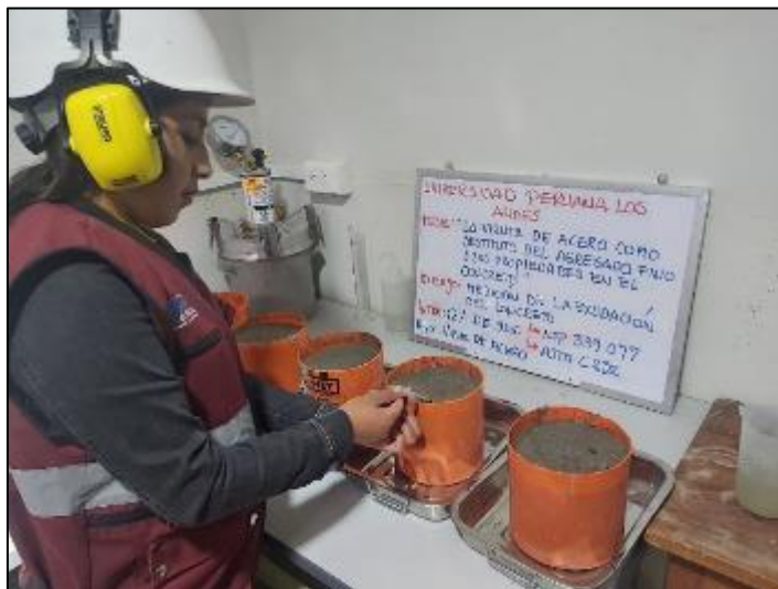
Fotografía 15. Medición de la exudación del concreto patrón.
