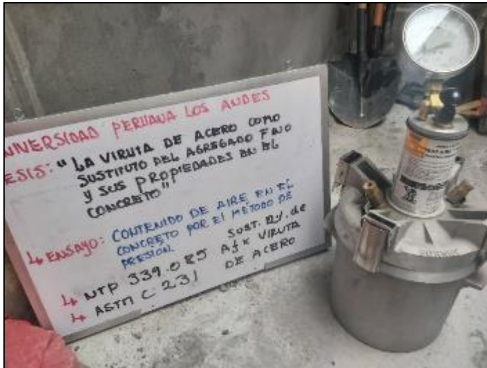
Fotografía 112. Medición del contenido de aire del concreto con sustitución parcial del agregado fino por viruta de acero en 12 %.
