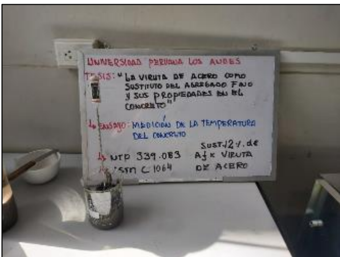
Fotografía 111. Medición de la temperatura del concreto con sustitución parcial del agregado fino por viruta de acero en 12 %.
