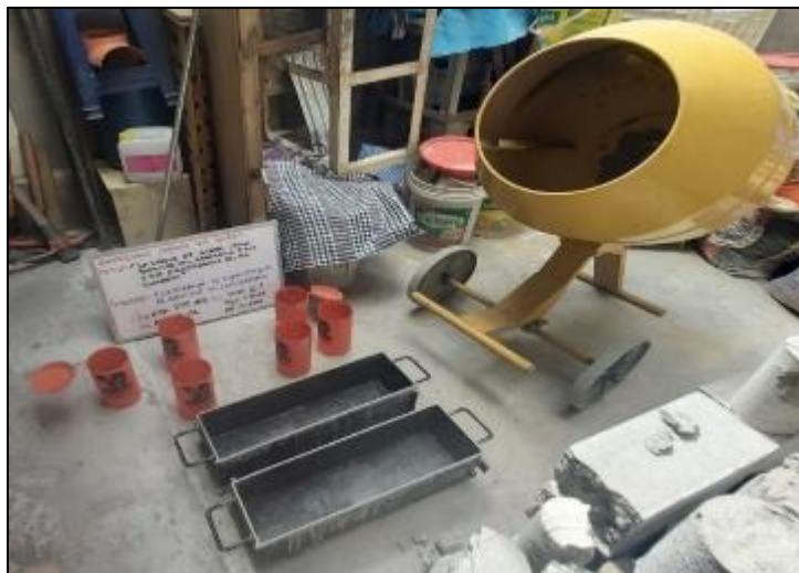
Fotografía 81. Proceso de mezclado del concreto patrón de f'c : 210 kg/cm 2 .
