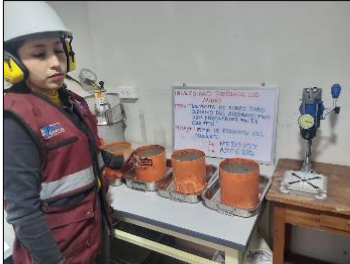
Fotografía 16. Medición del tiempo de fraguado del concreto patrón.
