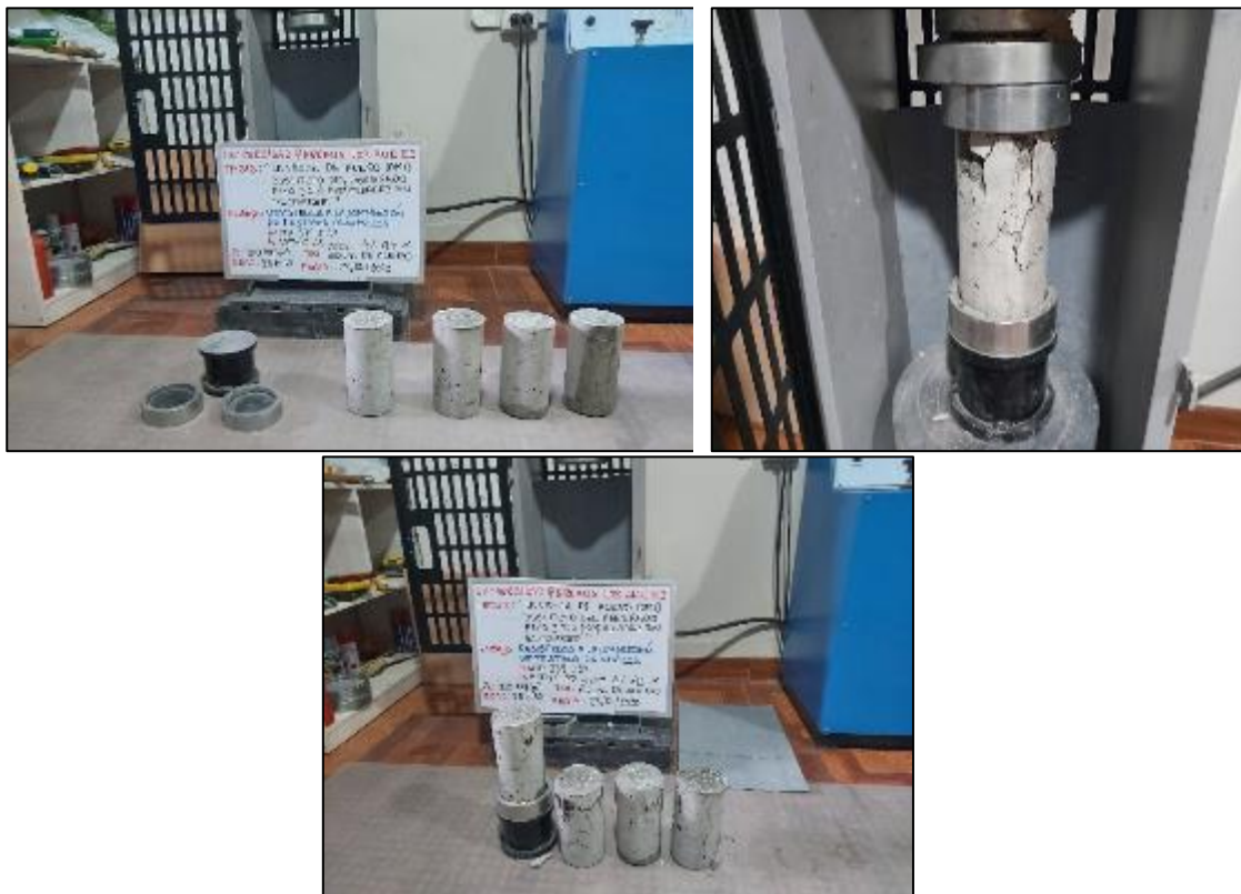
Fotografía 123. Ensayo de resistencia a compresión del concreto con sustitución parcial del agregado fino por viruta de acero en 4 % a los 28 días.
