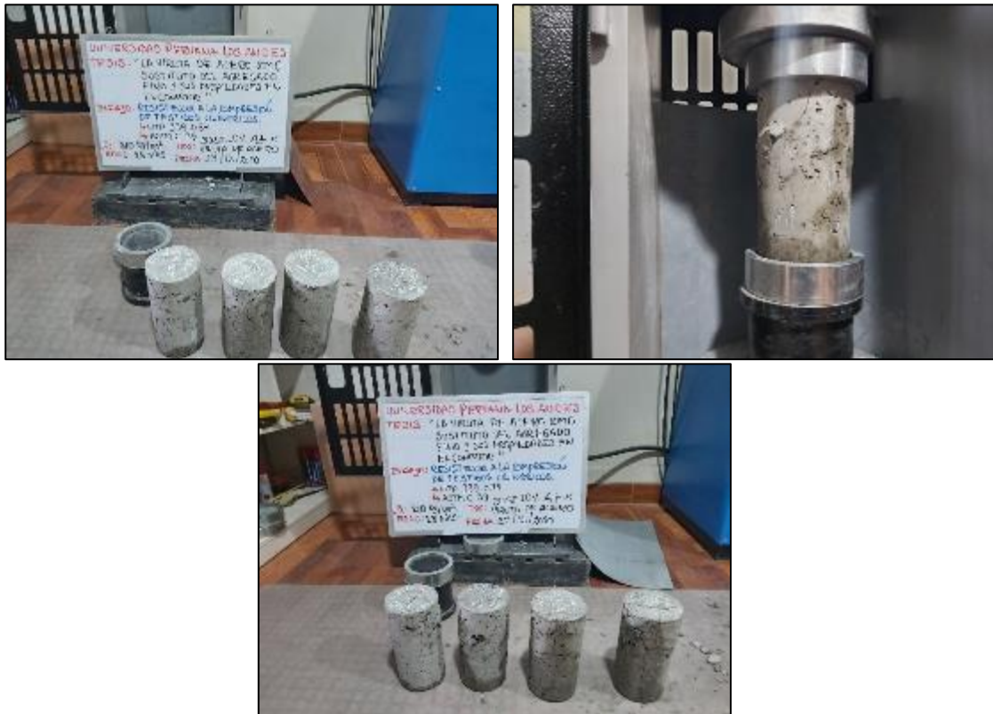
Fotografía 129. Ensayo de resistencia a compresión del concreto con sustitución parcial del agregado fino por viruta de acero en 10 % a los 28 días.
