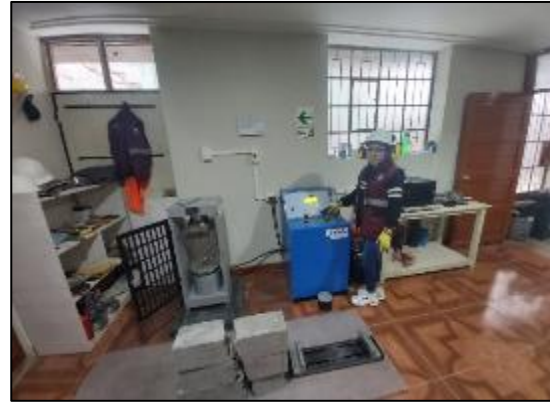
Fotografía 141. Ensayo de resistencia a flexión del concreto con sustitución parcial del agregado fino por viruta de acero en 12 % a los 14 días.
