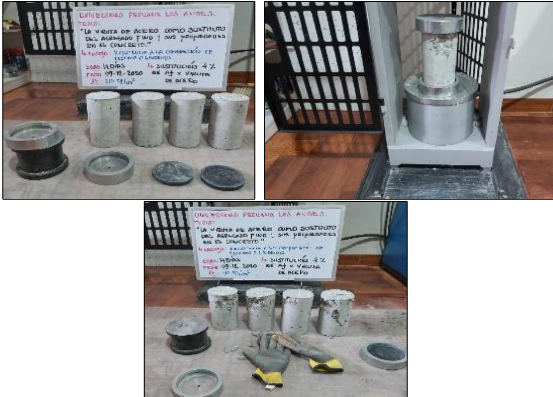
Fotografía 122. Ensayo de resistencia a compresión del concreto con sustitución parcial del agregado fino por viruta de acero en 4 % a los 14 días.
