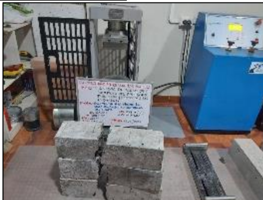
Fotografía 66. Ensayo de resistencia a flexión del concreto con sustitución parcial del agregado fino por viruta de acero en 4 % a los 28 días.
