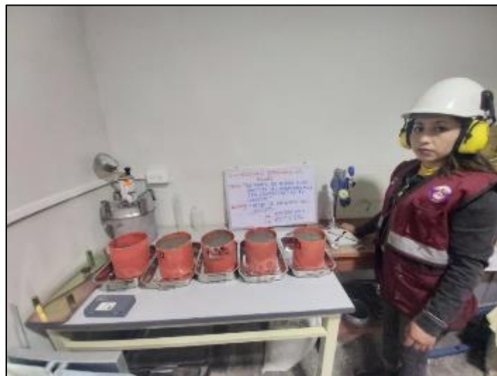
Fotografía 37. Medición del tiempo de fragua del concreto con sustitución parcial del agregado fino por viruta de acero en 10 %.
