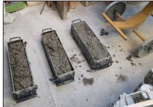
Fotografía 101. Elaboración de probetas y vigas del concreto con sustitución parcial del agregado fino por viruta de acero en 6 %.
