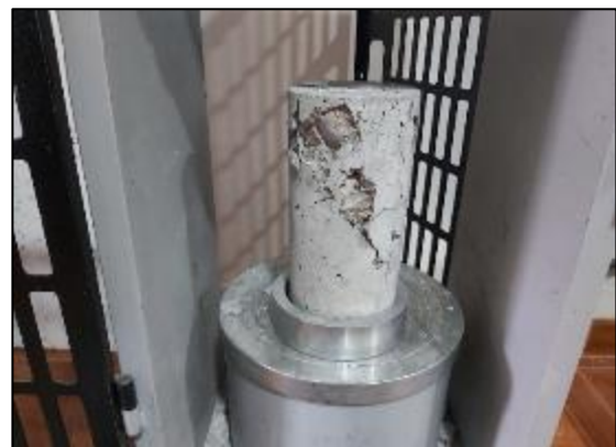
Fotografía 126. Ensayo de resistencia a compresión del concreto con sustitución parcial del agregado fino por viruta de acero en 6 % a los 28 días.
