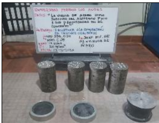
Fotografía 127. Ensayo de resistencia a compresión del concreto con sustitución parcial del agregado fino por viruta de acero en 10 % a los 7 días.
