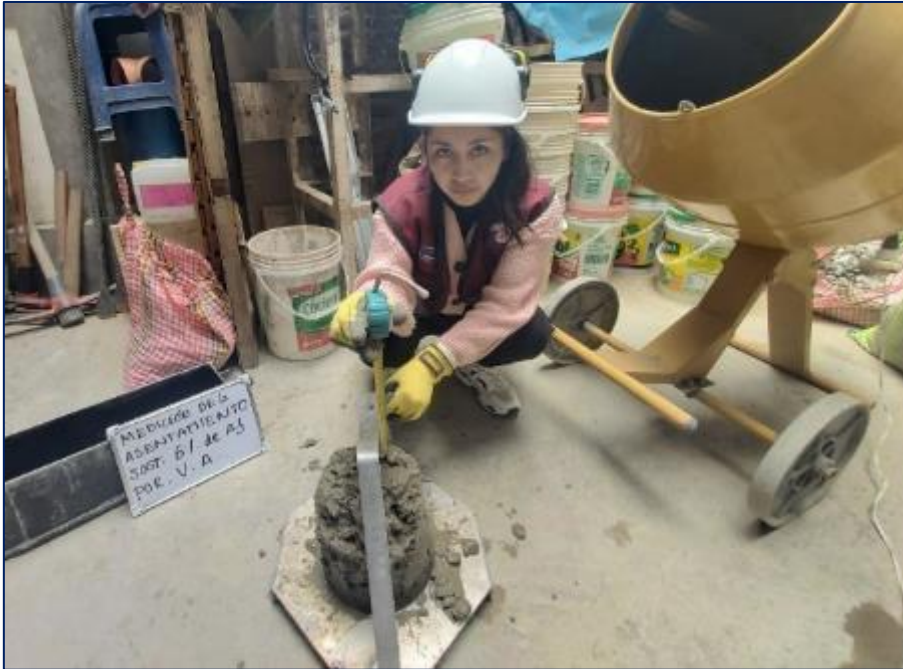
Fotografía 96. Medición del asentamiento del concreto con sustitución parcial del agregado fino por viruta de acero en 6 %.
