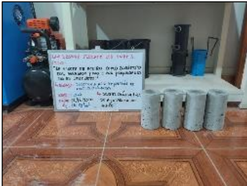
Fotografía 120. Ensayo de resistencia a compresión del concreto patrón a los 28 días.
