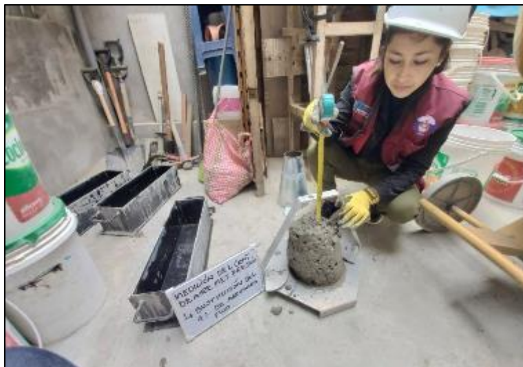
Fotografía 19. Medición del asentamiento del concreto con sustitución parcial del agregado fino por viruta de acero en 4 %.
