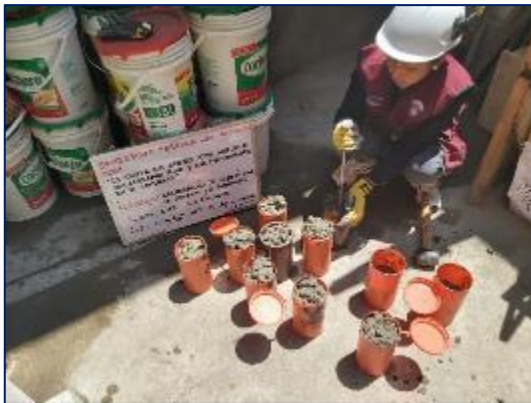
Fotografía 24. Elaboración de probetas y vigas del concreto con sustitución parcial del agregado fino por viruta de acero en 4 %.
