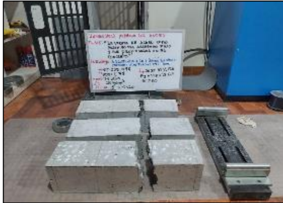
Fotografía 69. Ensayo de resistencia a flexión del concreto con sustitución parcial del agregado fino por viruta de acero en 10 % a los 14 días.
