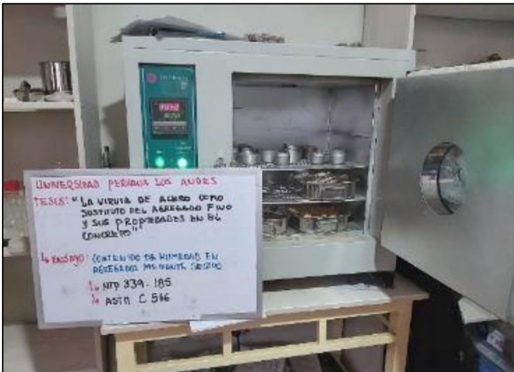
Fotografía 76. Vista de agregados en el horno para determinar el contenido de humedad.
