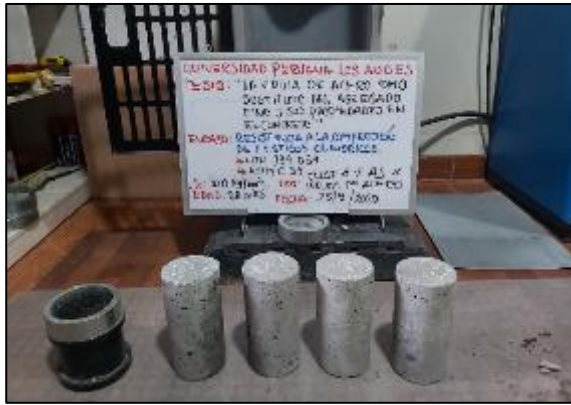
Fotografía 126. Ensayo de resistencia a compresión del concreto con sustitución parcial del agregado fino por viruta de acero en 6 % a los 28 días.
