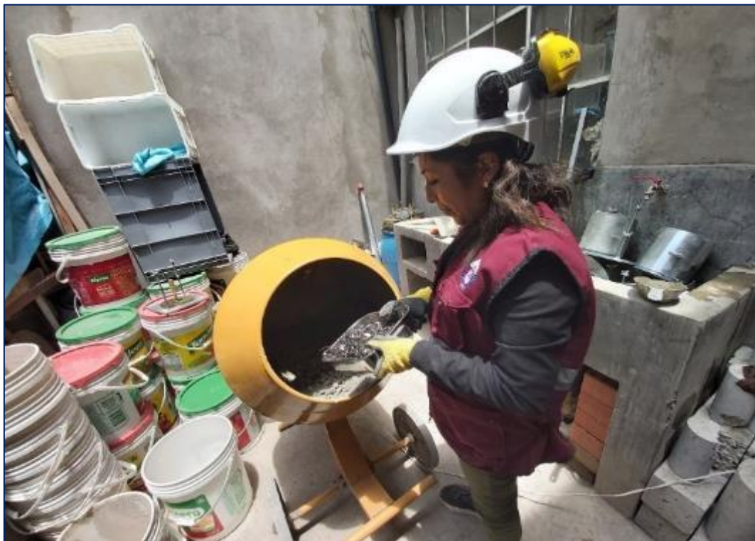
Fotografía 88. Proceso de mezclado del concreto con sustitución parcial del agregado fino por viruta de acero en 4 %.
