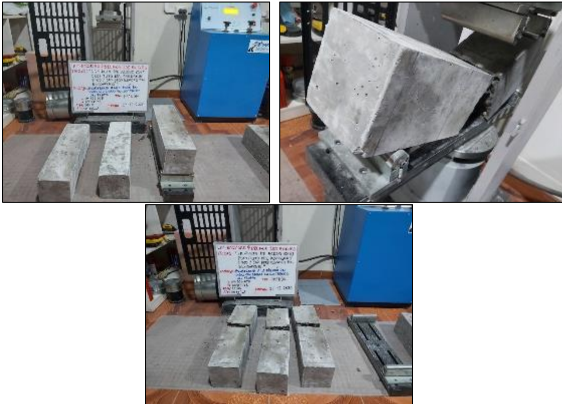
Fotografía 64. Ensayo de resistencia a flexión del concreto patrón a los 28 días.
