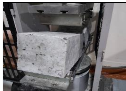
Fotografía 135. Ensayo de resistencia a flexión del concreto con sustitución parcial del agregado fino por viruta de acero en 4 % a los 14 días.
