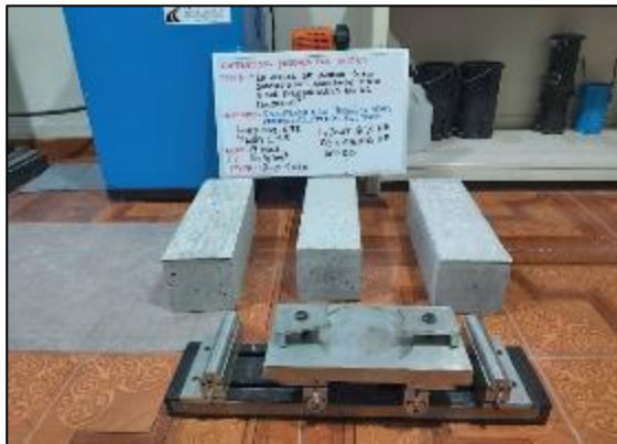
Fotografía 136. Ensayo de resistencia a flexión del concreto con sustitución parcial del agregado fino por viruta de acero en 4 % a los 28 días.
