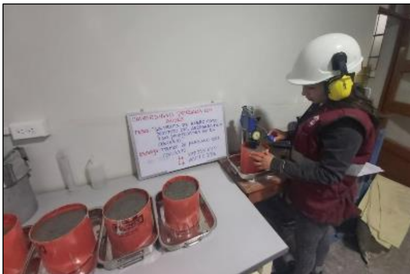
Fotografía 114. Medición del tiempo de fragua del concreto con sustitución parcial del agregado fino por viruta de acero en 12 %.
