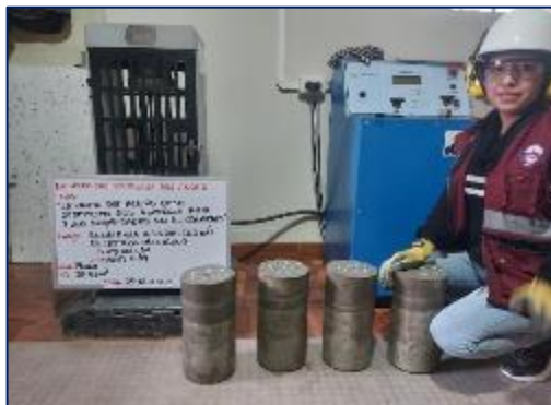
Fotografía 118. Ensayo de resistencia a compresión del concreto patrón a los 7 días.
