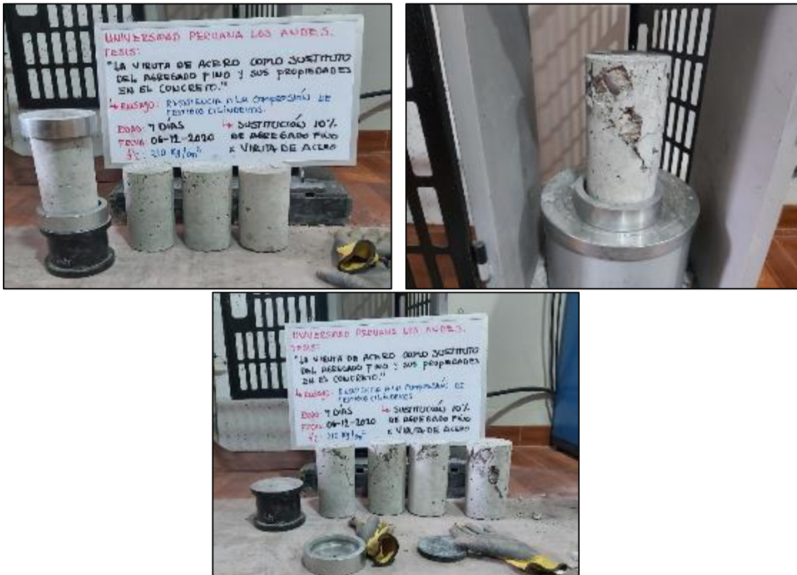
Fotografía 57. Ensayo de resistencia a compresión del concreto con sustitución parcial del agregado fino por viruta de acero en 10 % a los 7 días.
